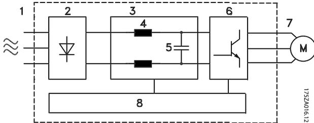
Ilustración 1.4 Diagrama de bloques de convertidor de frecuencia
