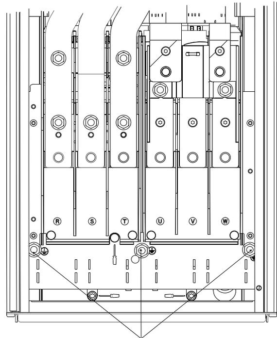
Ilustración 2.6 Conexión a toma de tierra de las protecciones IP21/54
