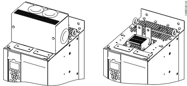
Ilustración 2.24 Terminal de regeneración o carga compartida con cubierta (L) y sin ella (R)
