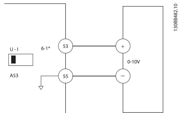
Ilustración 5.10 Ejemplo de cableado para el dispositivo externo que suministra una señal de control de 0-10 V
