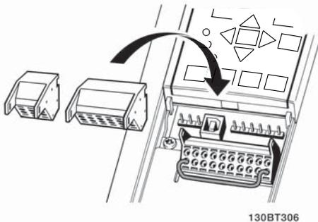
Ilustración 2.22 Desmontaje de los terminales de control
