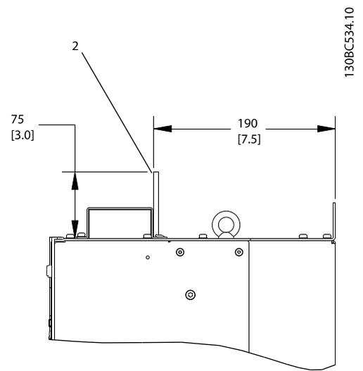
Ilustración 2.12 Carga compartida y terminales de regeneración, D4h
