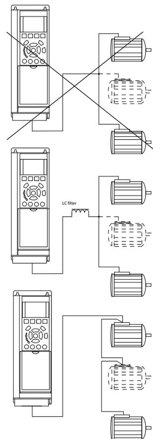
Illustration 4.45 電纜線連接至共同接合處的安裝例
