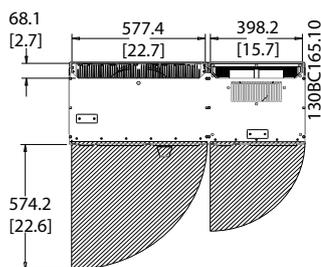
Illustration 4.10 IP21/IP54 外觀類型, 機架大小 D13 的前方空間。
