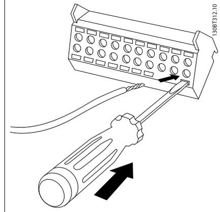
4. 取下螺絲起子。電纜線現在已安裝在端子內。
