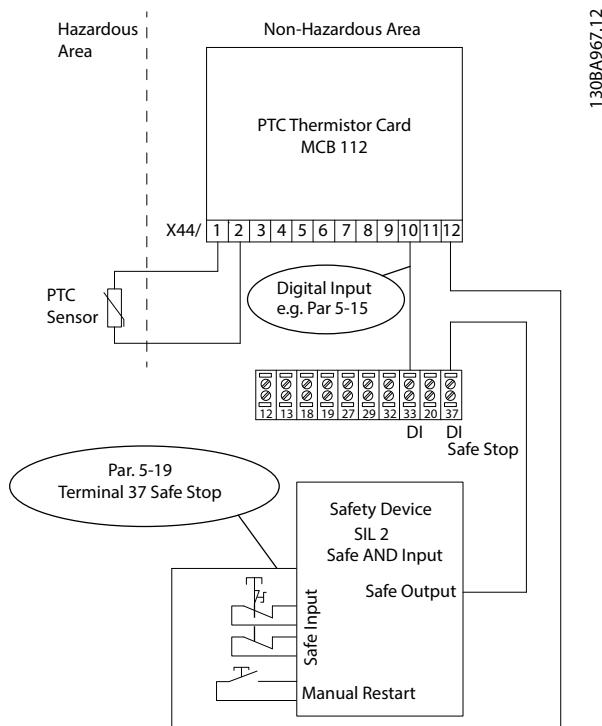
圖 3.3 結合 Safe Torque Off 應用和 MCB 112 應用
