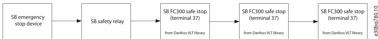
Ilustración 5.8 Diagrama de bloques relacionado con la seguridad
