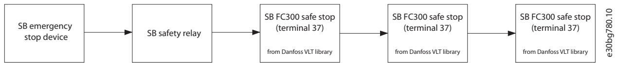
그림 5.8 안전 관련 블록 다이어그램
