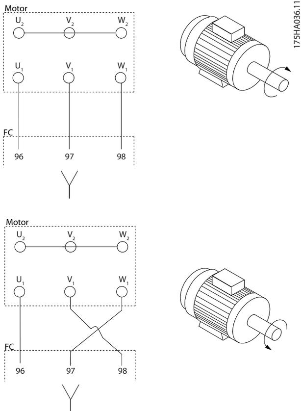
Ilustración 5.7 Cambio de giro del motor
