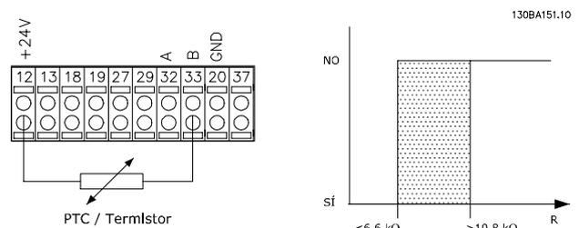
Ilustración 5.5 Conexión del termistor PTC: entrada digital con fuente de alimentación de 24 V
