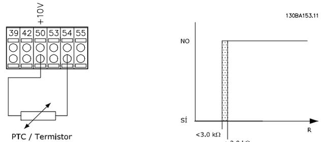
Ilustración 5.4 Conexión del termistor PTC: entrada analógica con fuente de alimentación de 10 V
