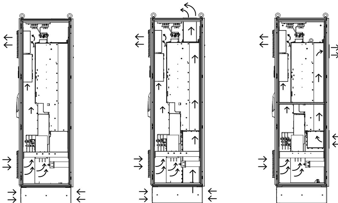
Ilustración 4.4 Caudal de aire, unidad estándar (izquierda) y kit de refrigeración con canal posterior (derecha)
