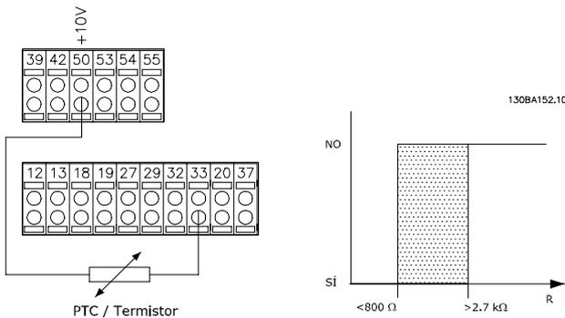
Ilustración 5.3 Conexión del termistor PTC: entrada digital con fuente de alimentación de 10 V
