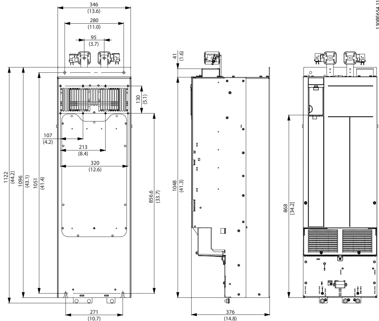
图 7.2 Common AC Drive Modules 安装尺寸
