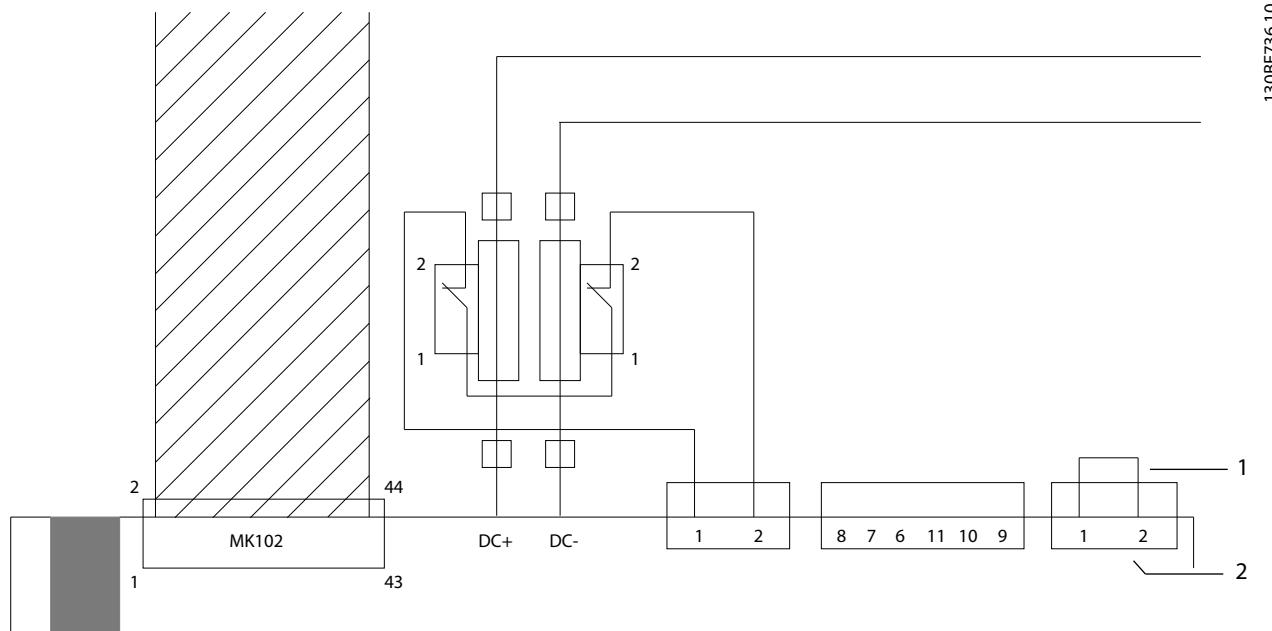
图 8.3 BRF 跳线连接
