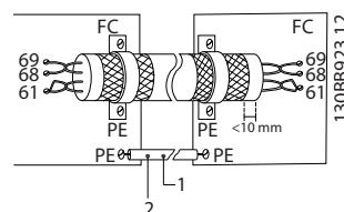
1 最小 16 mm<sup>2</sup> (4 AWG) 2 均衡电缆
