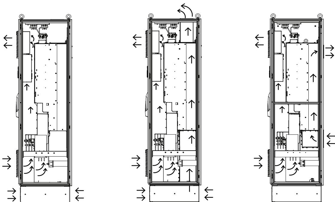
图 4.4 气流, 标准设备 (左) 以及配有背部通道冷却套件 (右)
