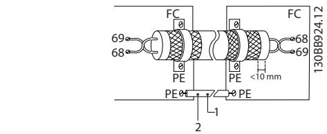
1 最小 16 mm<sup>2</sup> (4 AWG) 2 均衡电缆
