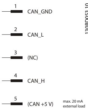
图 8.6 CAN 总线连接 X4
