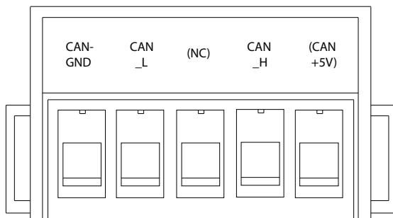
图 6.5 CAN 总线插头
