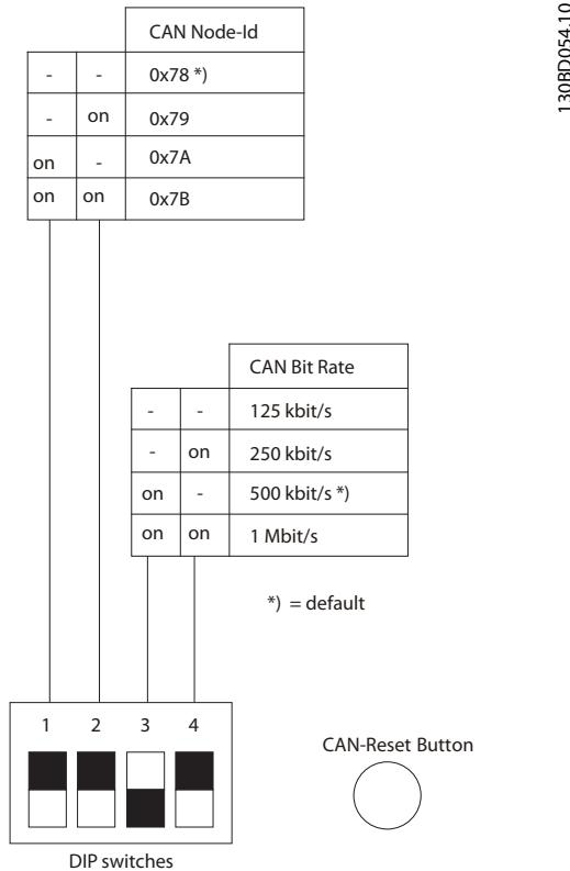
图 8.7 CAN DIP 开关
