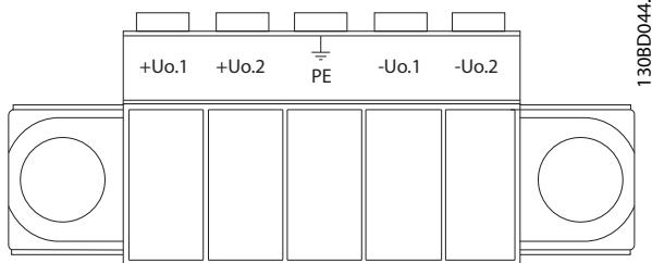
图 6.3 电源输出插头
