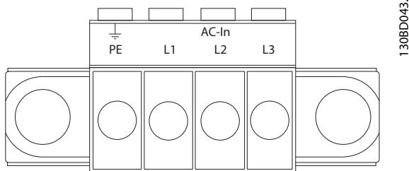
图 6.2 电源 输入插头
