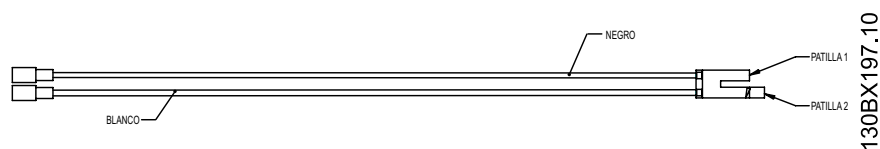
Ilustración 6.3: Cable de pruebas de dos patillas bastidor D
