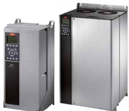
Berührungssichere Umrichter in den Schutzarten IP20 und 21 (Bild rechts) sind für die Montage in Schaltschränken vorgesehen. Spritzwasser geschützte Umrichter in den Schutzarten IP 54 und 55 (Bild links) sind für die Montage an Wänden oder auf Rahmen konzipiert.
