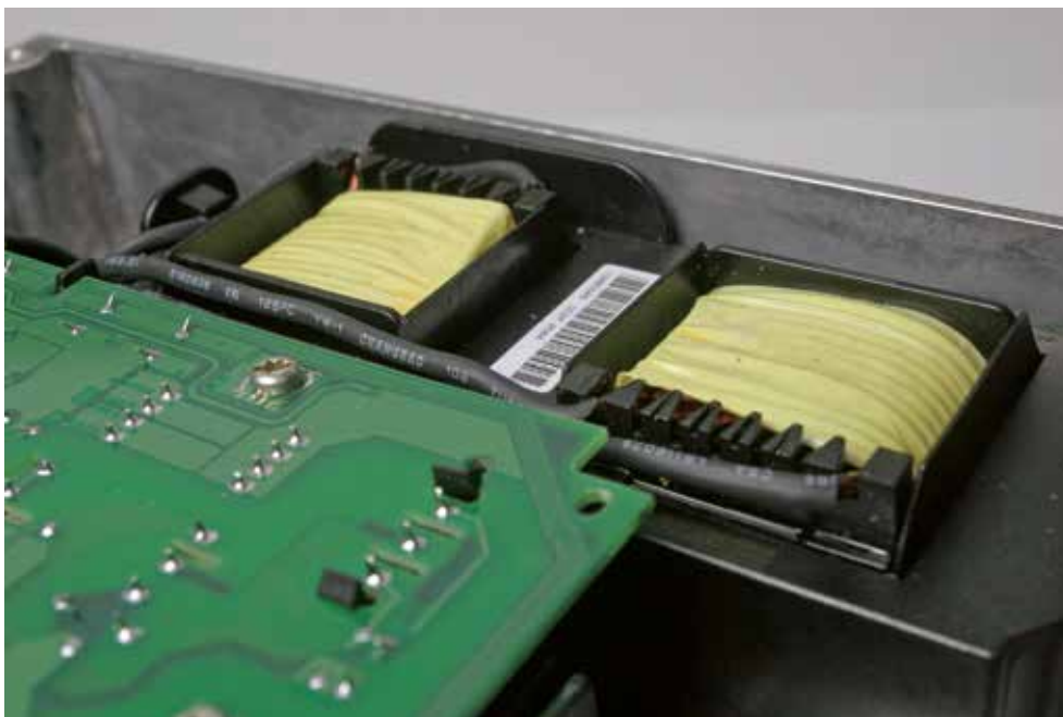
Eingebaute Zwischenkreisdrosseln reduzieren die niederfrequenten Netzurückwirkungen und erhöhen die Lebensdauer des Geräts.
