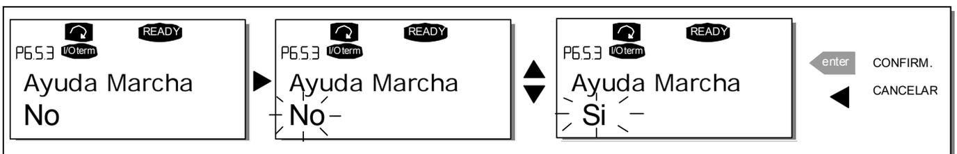
Figura 7-12. Activación del asistente de arranque
