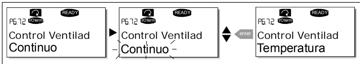
Figura 7-18. Función del control del ventilador
