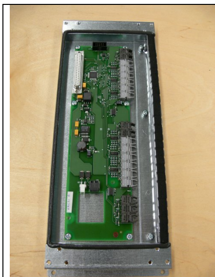
1. Нижняя панель блока управления IP54 с платой разветвителя.
