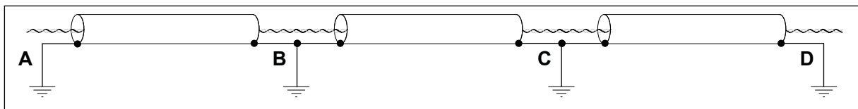
Abb. 38: Erdung in störungsintensiver Umgebung mit gutem Potenzialausgleich. Wenn die Potenziale an den Punkten A, B, C und D sehr unterschiedlich sind und nicht gleichgesetzt werden können, schneiden Sie die Abschirmungen wie in Abb. 39.
