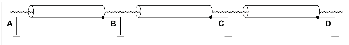
Afb. 42: Aarding in een omgeving met veel ruis en een gebrekkige potentiaalvereffening. Voorbeeld van het doorsnijden van de afscherming.
