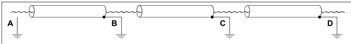
Рис. 42: Заземление с плохим уравниванием потенциалов в среде с высоким уровнем помех. Пример разрезания экрана.
