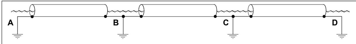
Рис. 41: Заземление с хорошим уравниванием потенциалов в среде с высоким уровнем помех. Если потенциалы в точках А, В, С и D сильно отличаются и их нельзя уравнять, обрежьте экраны, как показано на Рис. 42.
