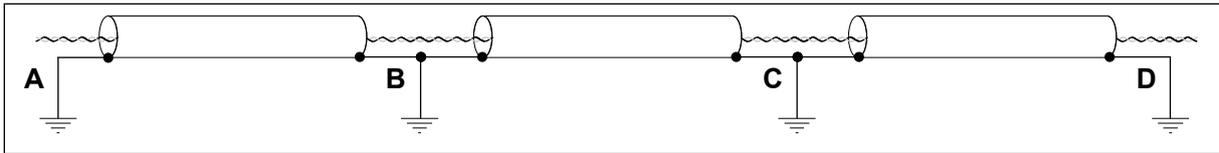
Рис. 38: Заземление с хорошим уравниванием потенциалов в среде с высоким уровнем помех. Если потенциалы в точках А, В, С и D сильно отличаются и их нельзя уравнивать, обрежьте экраны, как показано на Рис. 39.
