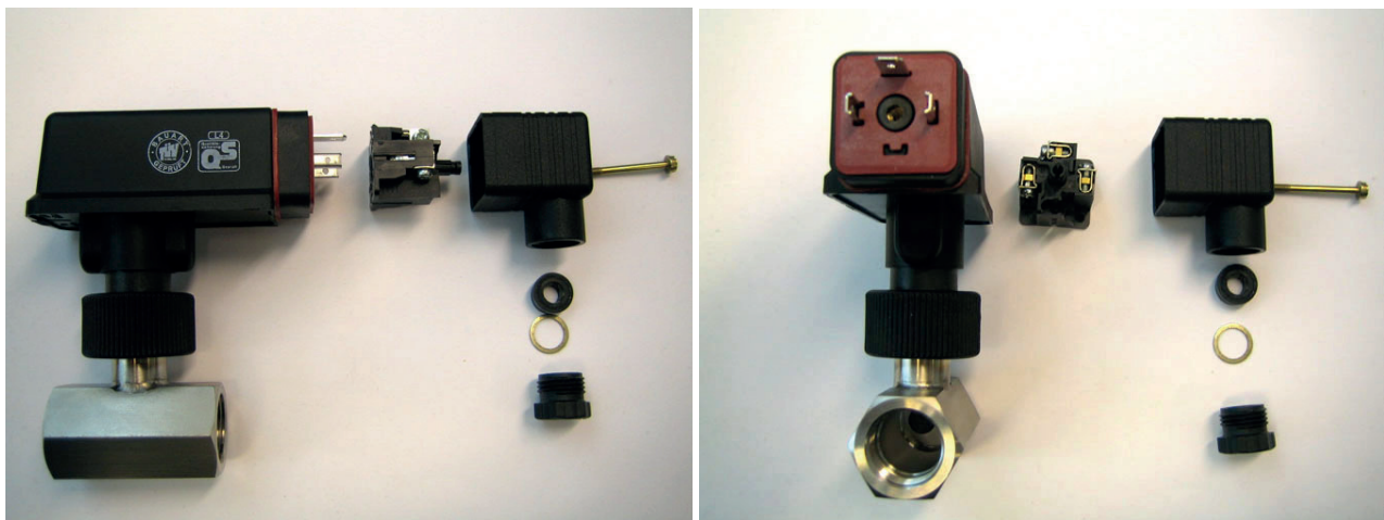
Kuva 31. Virtauskytkin: letkuliitäntä, pikaliitin (sähköinen), pikaliittimen lukkoruuvi, kaapelitiiviste ja kiristin
