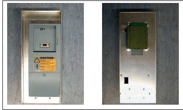
Kuva 53. Asennusrasiaan asennettu ohjausyksikkö, vasen: edestä; oikea: takaa
