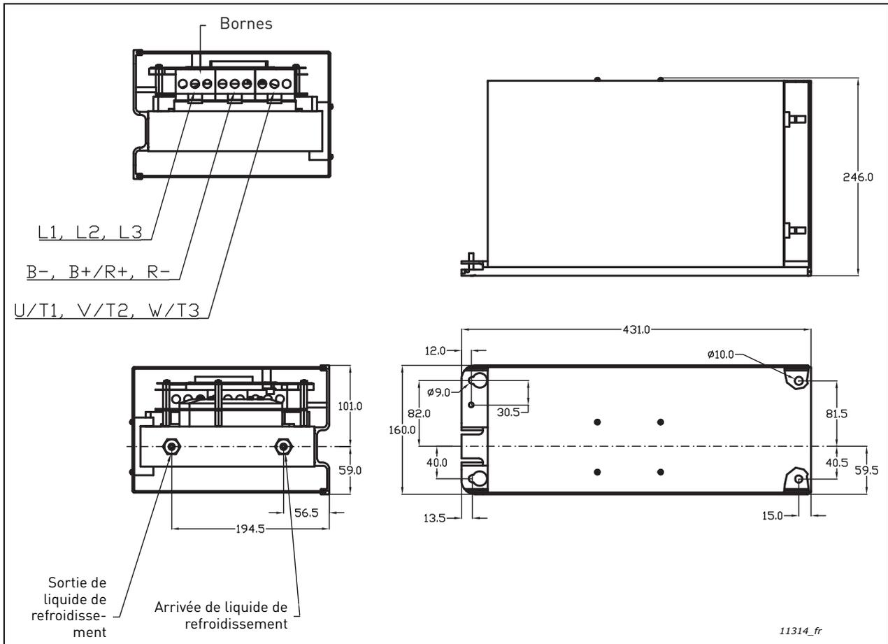
Figure 6. Dimensions du variateur VACON® NX Liquid-Cooled, CH3
