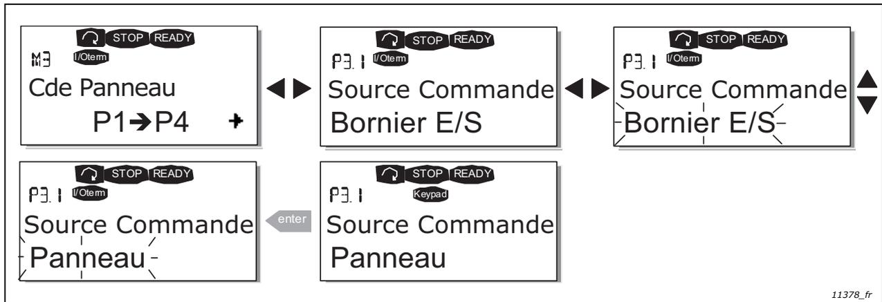
Figure 67. Sélection de la source de commande
