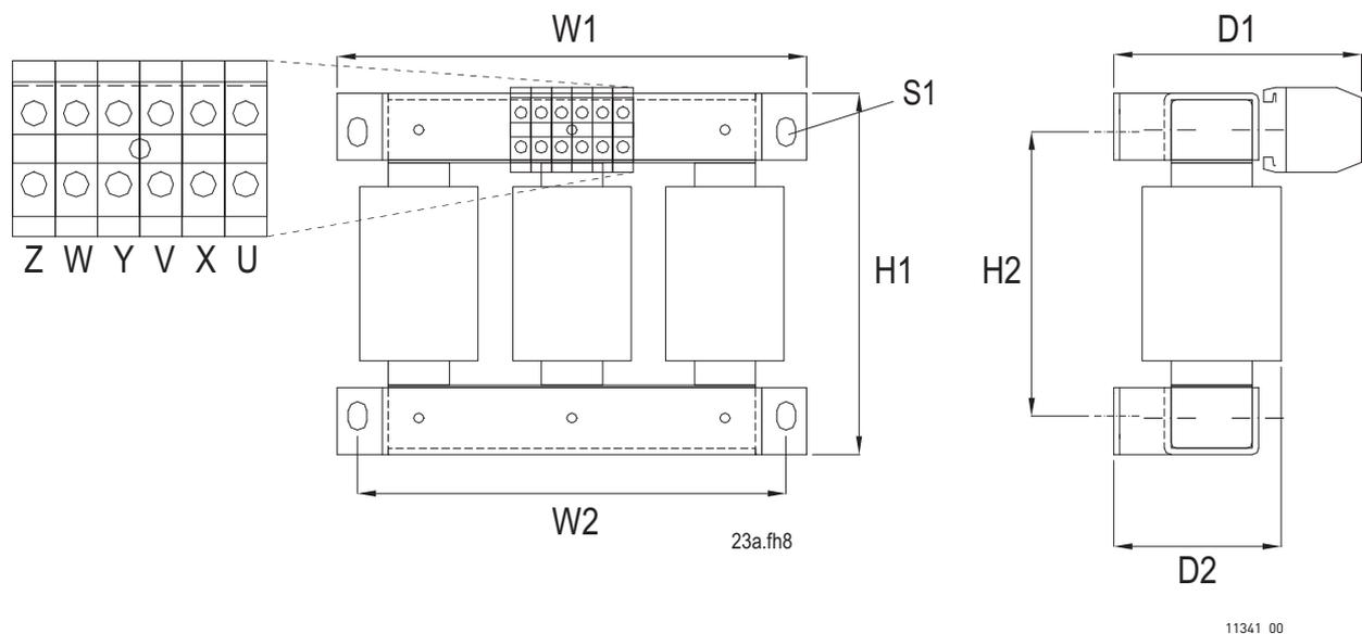
Figure 35. Exemple de selfs d'entrée à refroidissement par air pour VACON® NX Liquid-Cooled. Tailles jusqu'à 62 A
