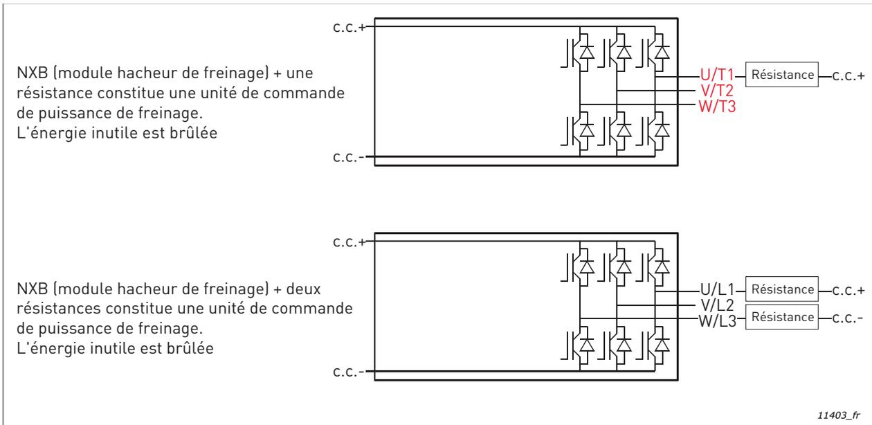
Figure 109. Topologie du module hacheur de freinage
