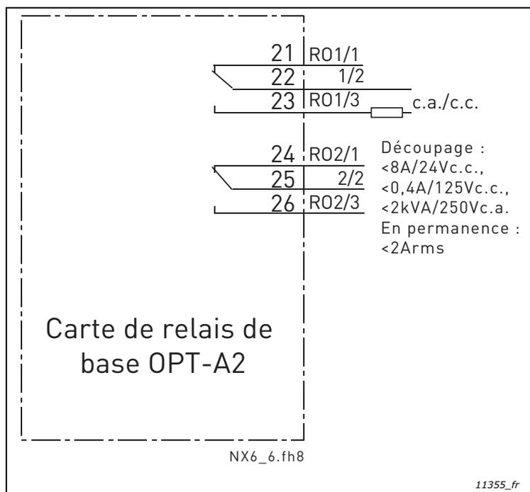
Figure 47. Schéma de câblage général de la carte de relais de base (OPT-A2)
