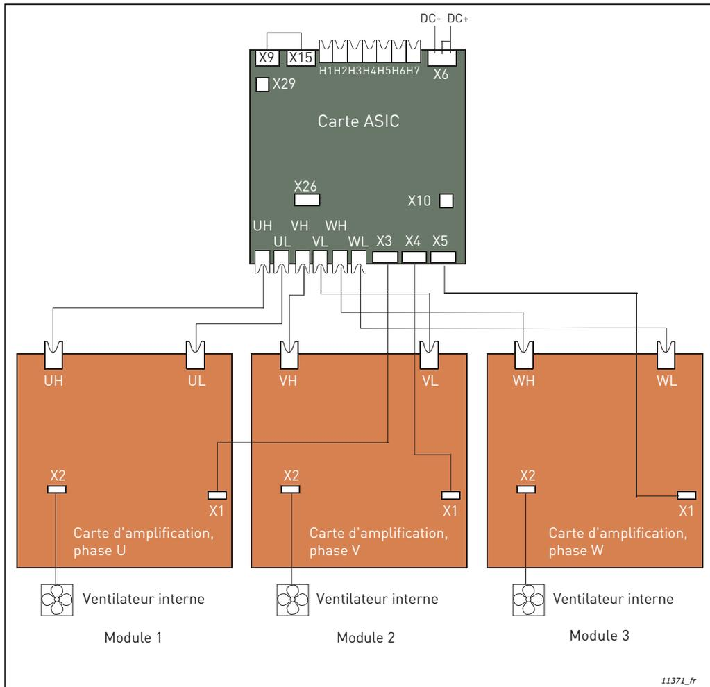
Figure 56. Bornes et raccordements entre la carte ASIC et les cartes Driver (CH64 et CH74)
