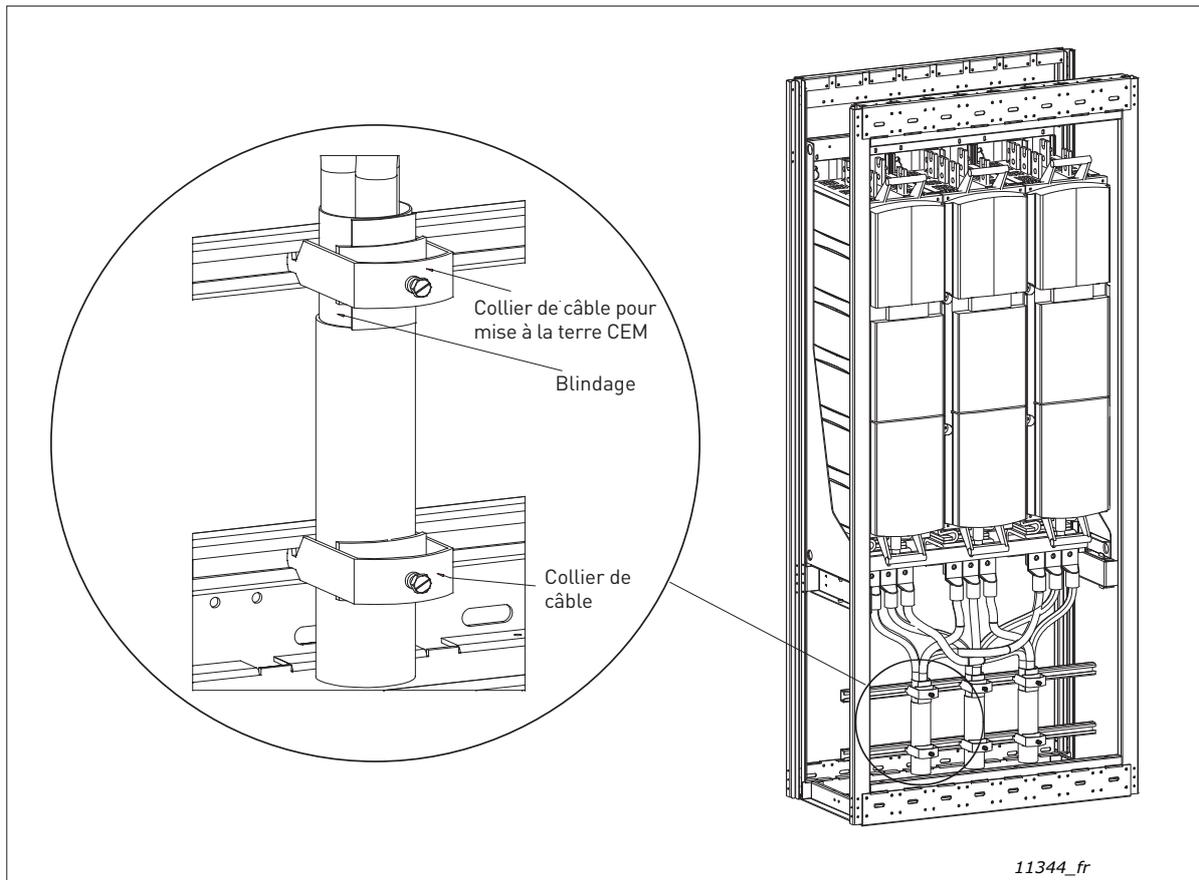
Figure 38. Bridage des câbles moteur au châssis de l'armoire
