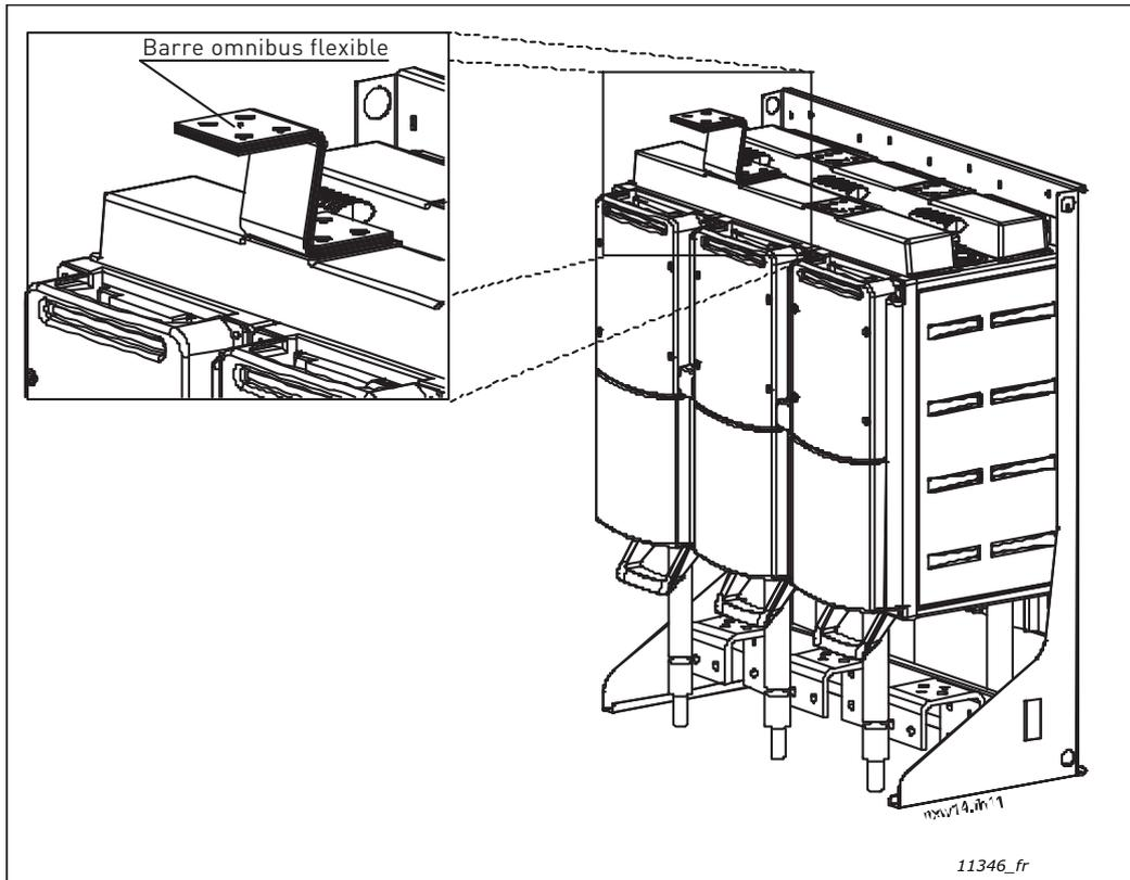
Figure 40. Montage de la barre omnibus flexible
