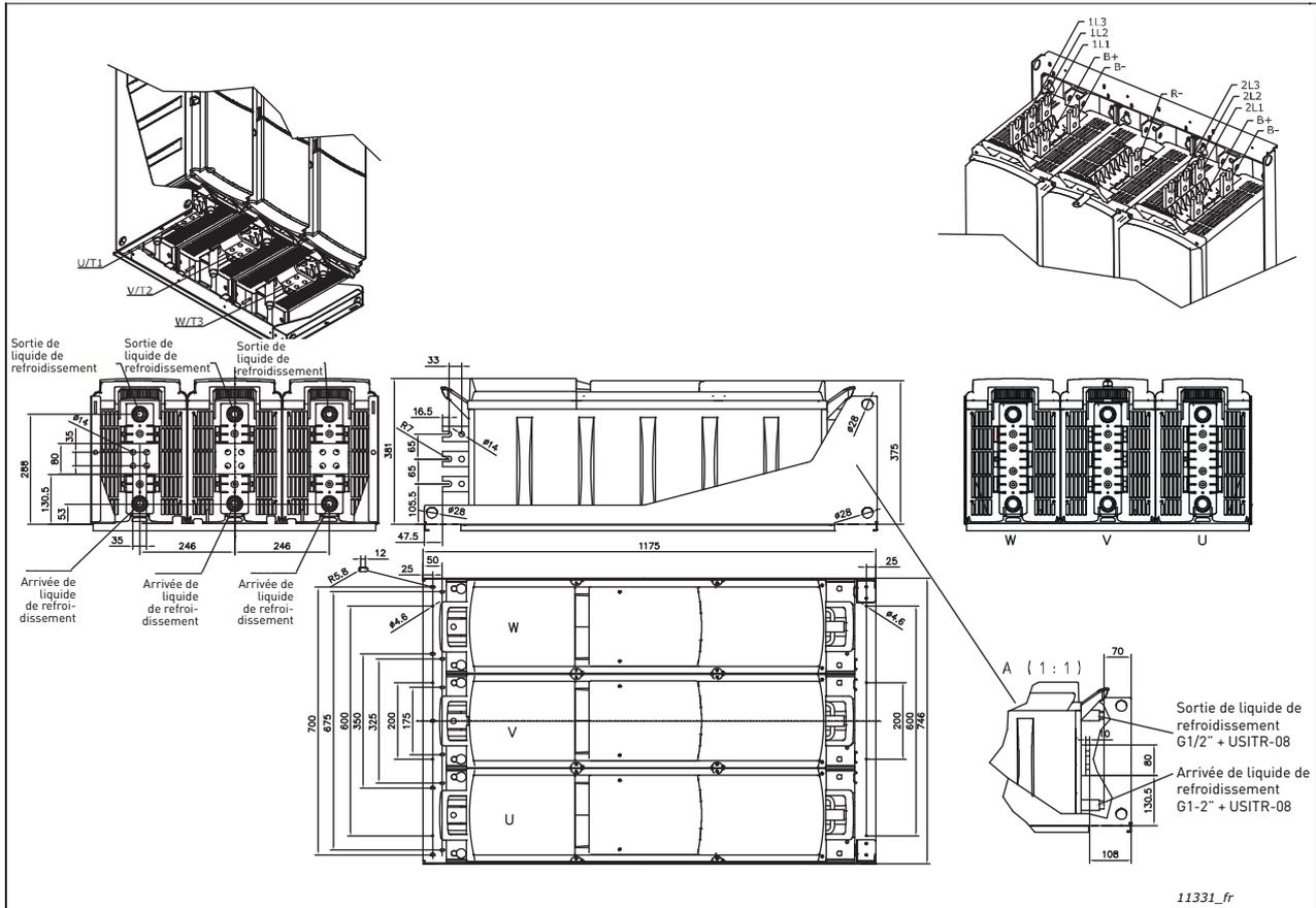
Figure 23. Dimensions du variateur de fréquence VACON® NX Liquid-Cooled (12 impulsions) avec hacheur de freinage intégré, CH74, IP00 (type UL ouvert)
