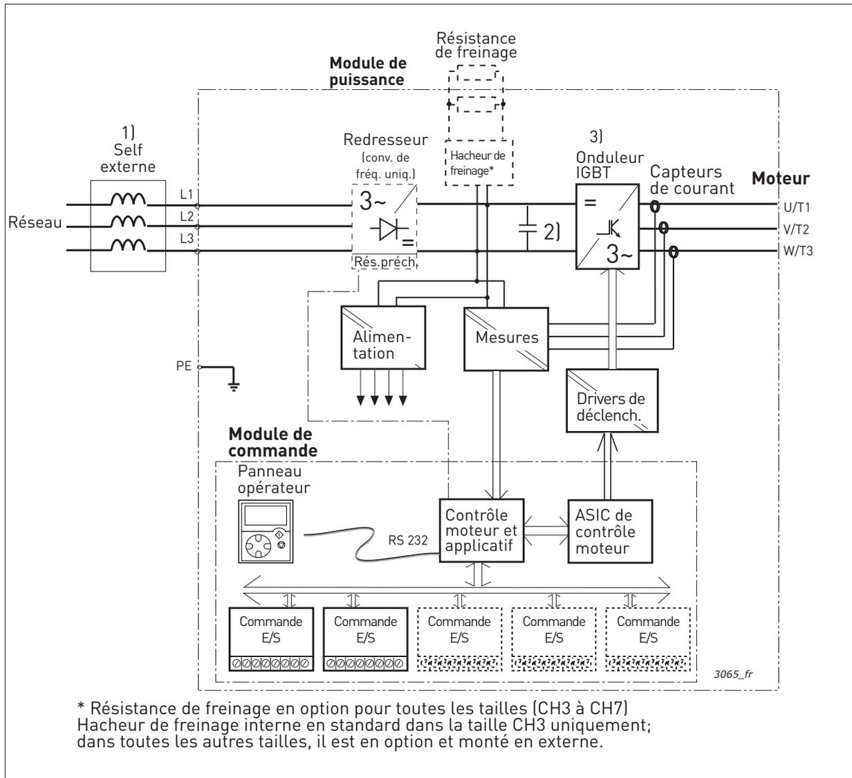
Figure 1. Schéma fonctionnel principal du variateur VACON® NX Liquid-Cooled
