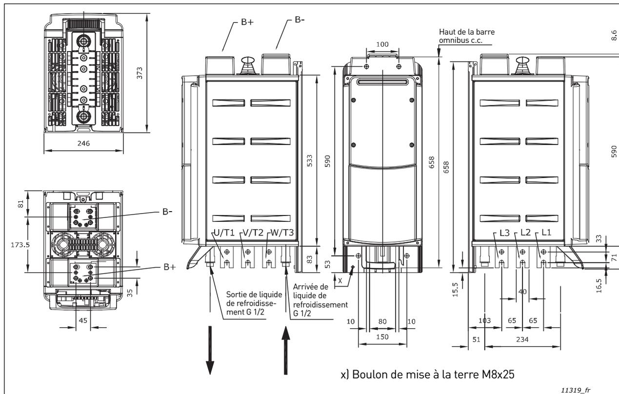
Figure 11. Variateur de fréquence VACON<sup>®</sup> Liquid-Cooled, CH61
