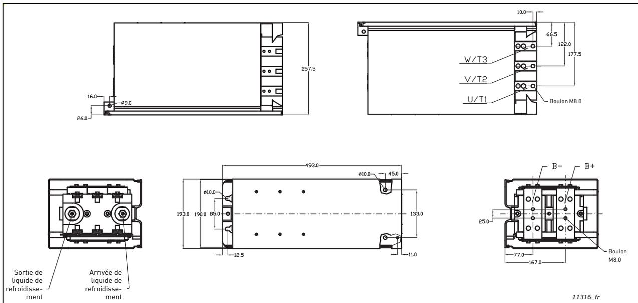
Figure 8. Dimensions du variateur VACON® NX Liquid-Cooled (onduleur), CH4
