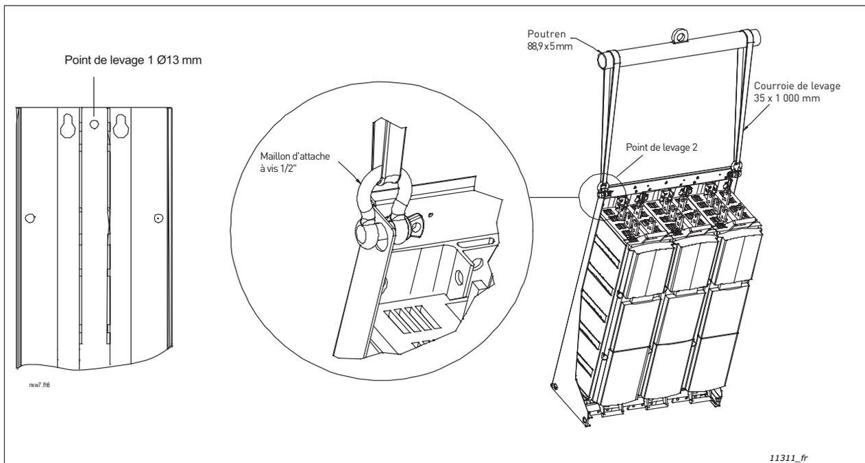
Figure 3. Points de levage pour variateurs composés d'un seul module (gauche) et de plusieurs modules
