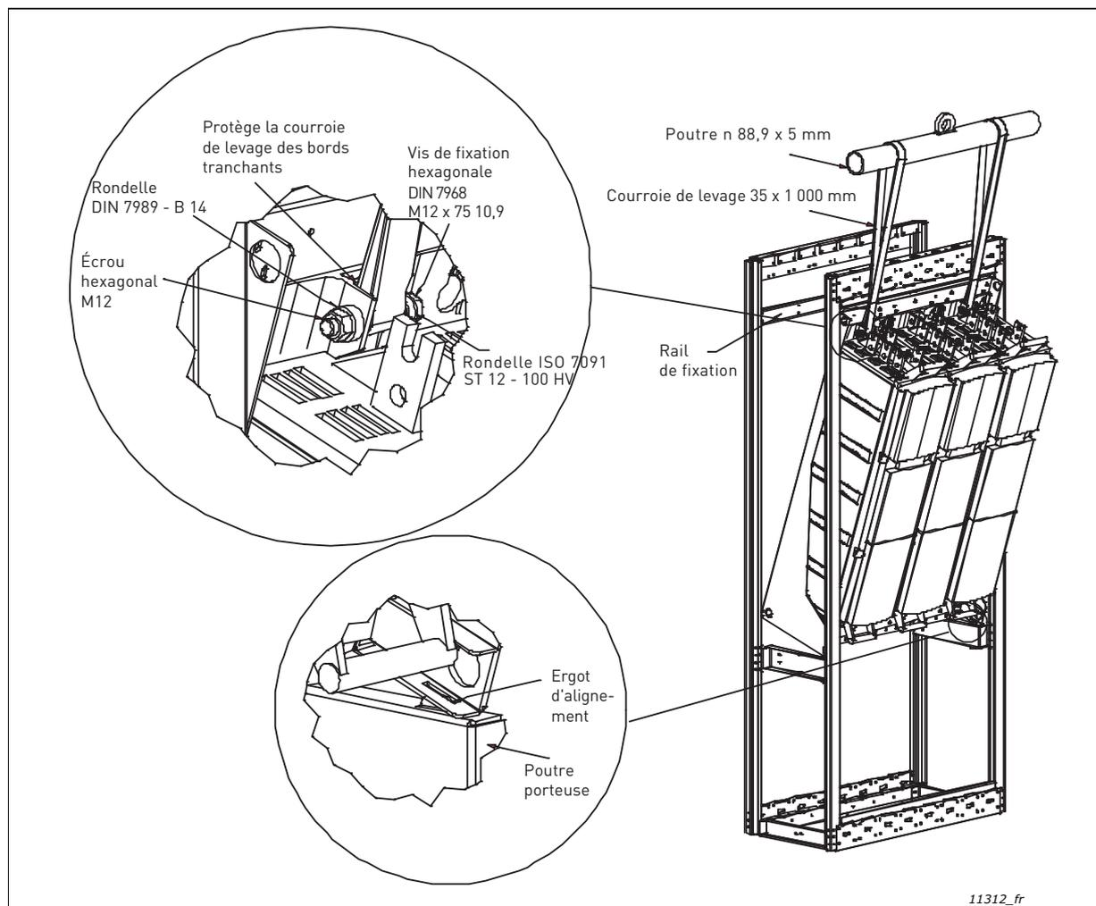
Figure 4. Levage du variateur dans un espace d'installation réduit
