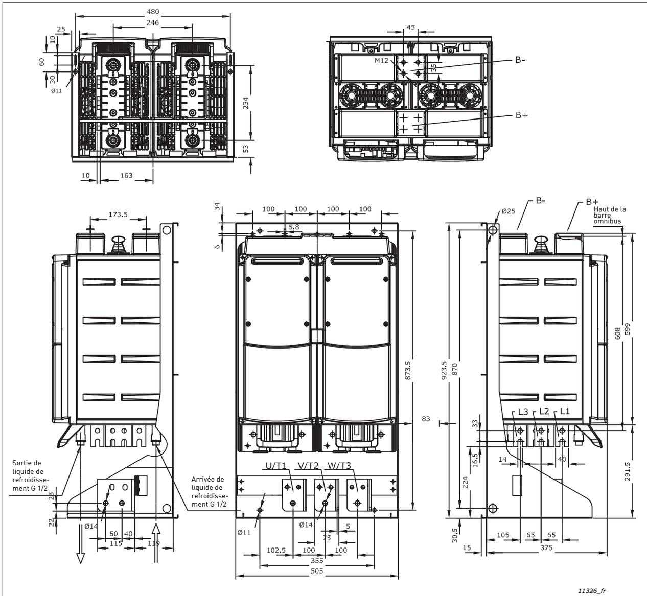
Figure 18. Variateur de fréquence VACON® Liquid-Cooled avec console de fixation, CH63
