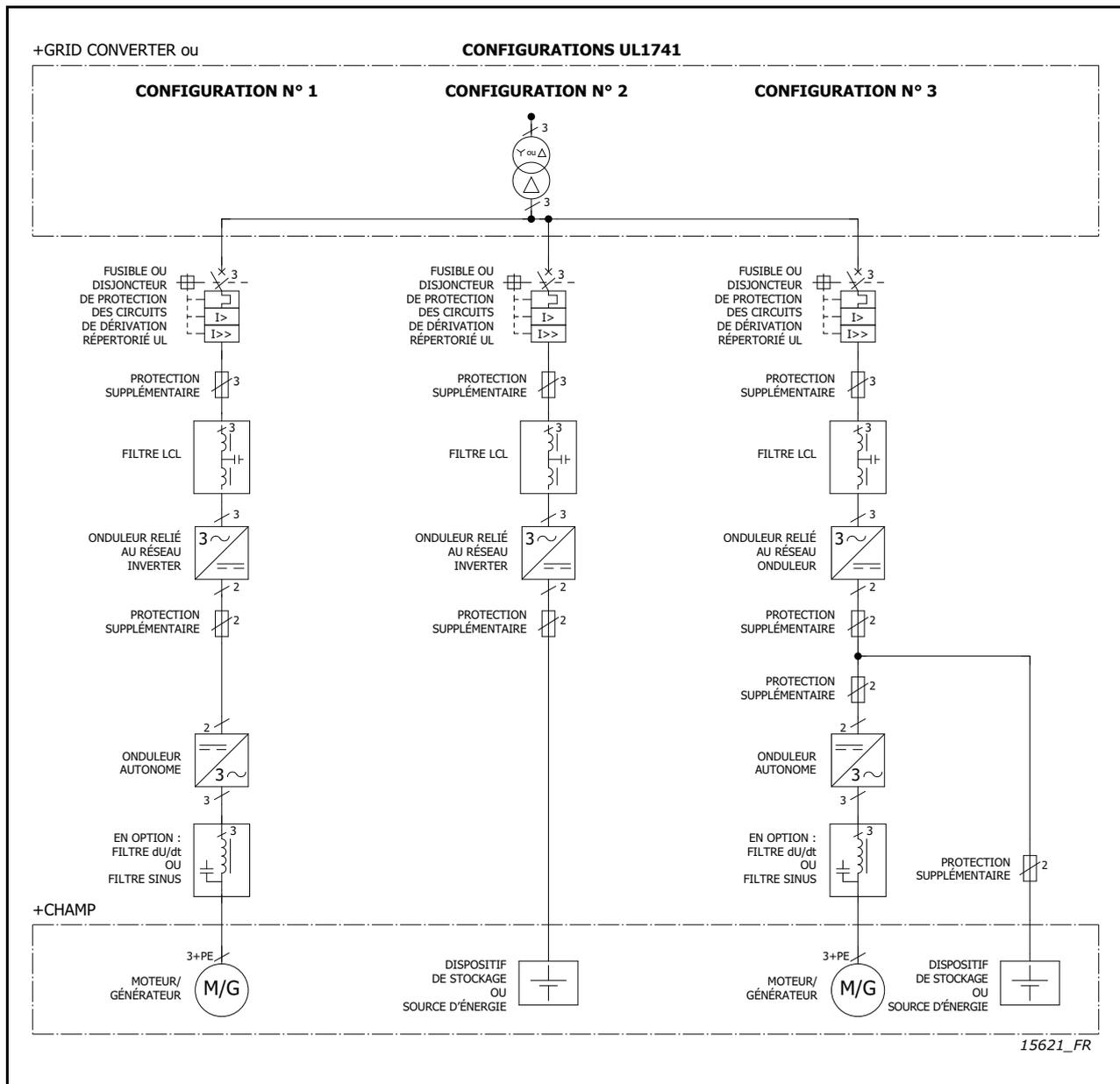
Figure 112. Schémas unifilaires des configurations de Grid Converter pour UL1741
