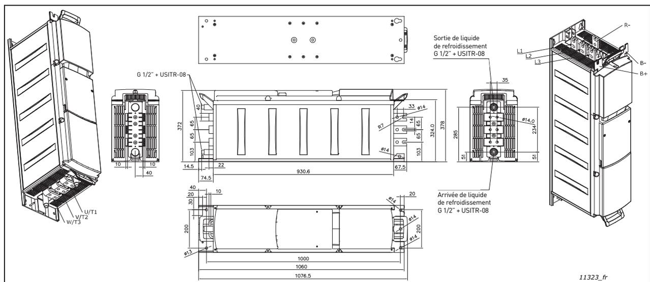
Figure 15. Variateur de fréquence VACON® Liquid-Cooled (6 impulsions) avec hacheur de freinage interne
