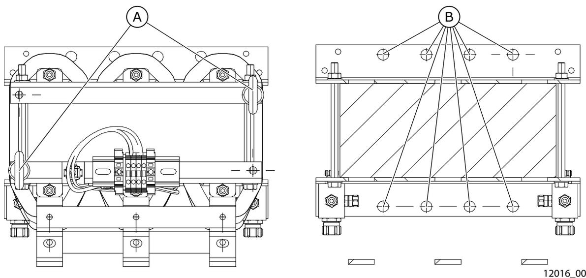
Figure 33. Points de mise à la terre pour selfs d'entrée
