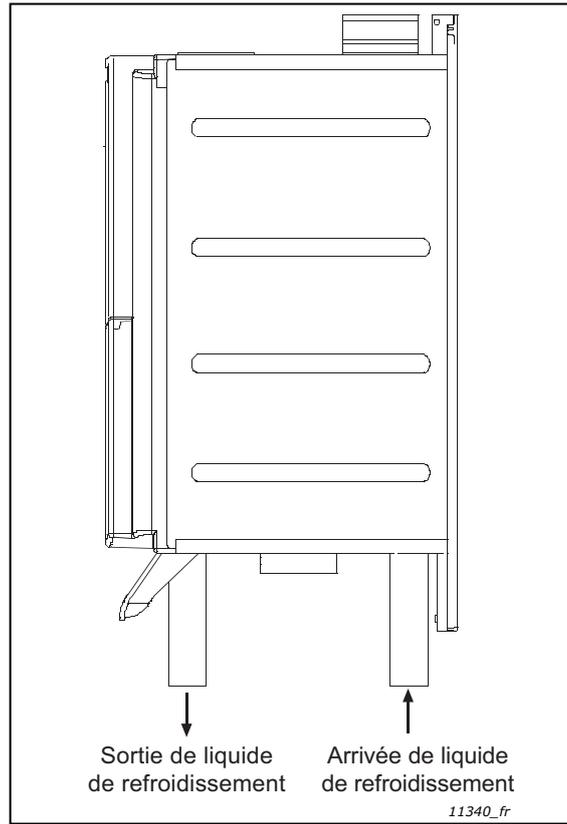
Figure 32. Sens de circulation du liquide de refroidissement
