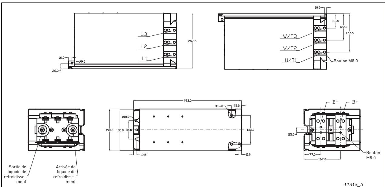
Figure 7. Dimensions du variateur VACON® NX Liquid-Cooled, CH4
