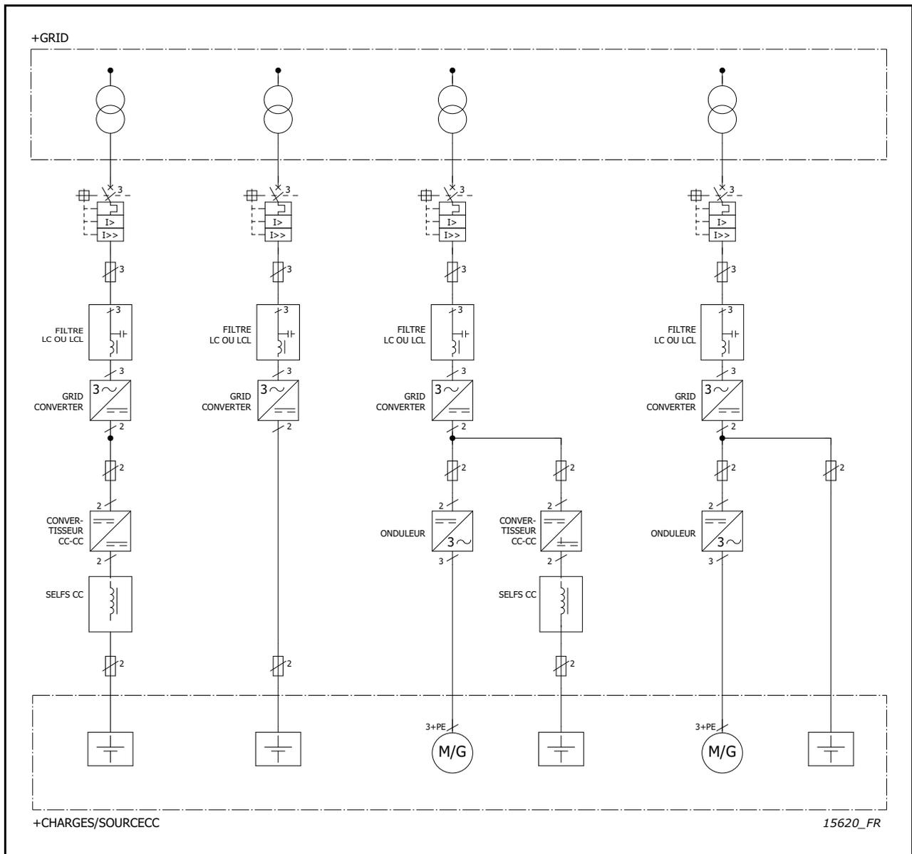
Figure 111. Schémas unifilaires des configurations de Grid Converter pour les codes réseau européens
