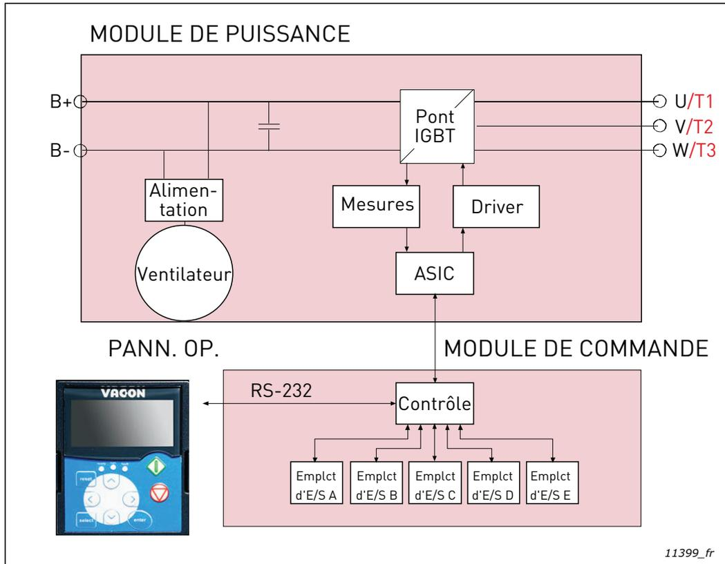
Figure 88. Schéma fonctionnel du module AFE
