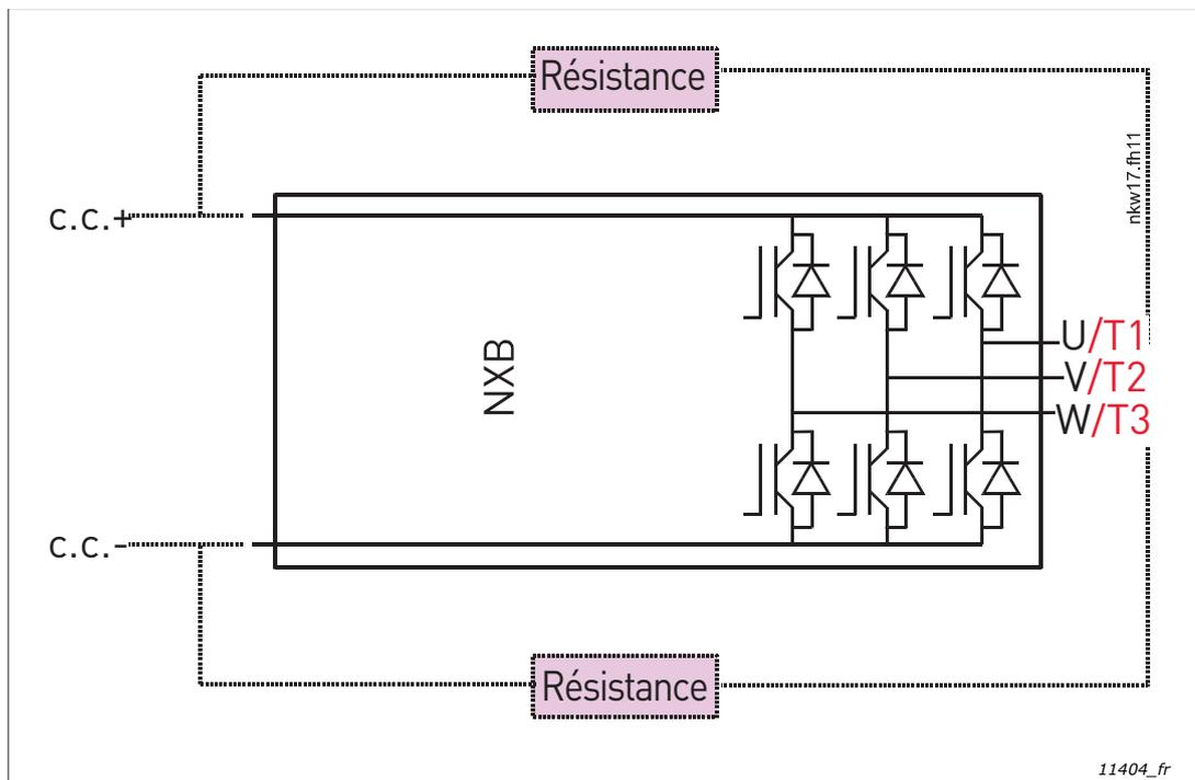
Figure 110. Connexions du hacheur de freinage VACON®
