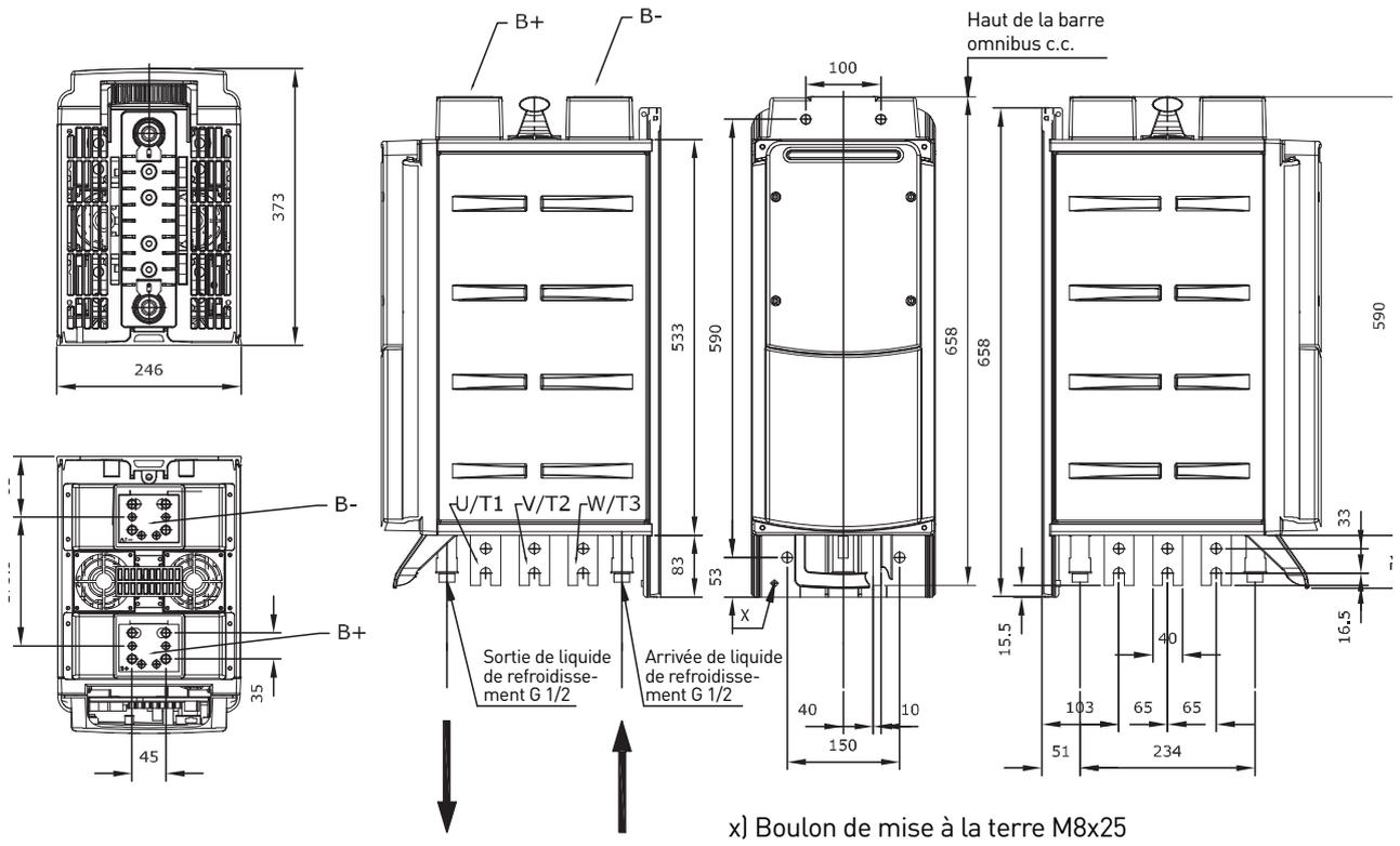
Figure 12. Onduleur VACON® Liquid-Cooled, CH61
