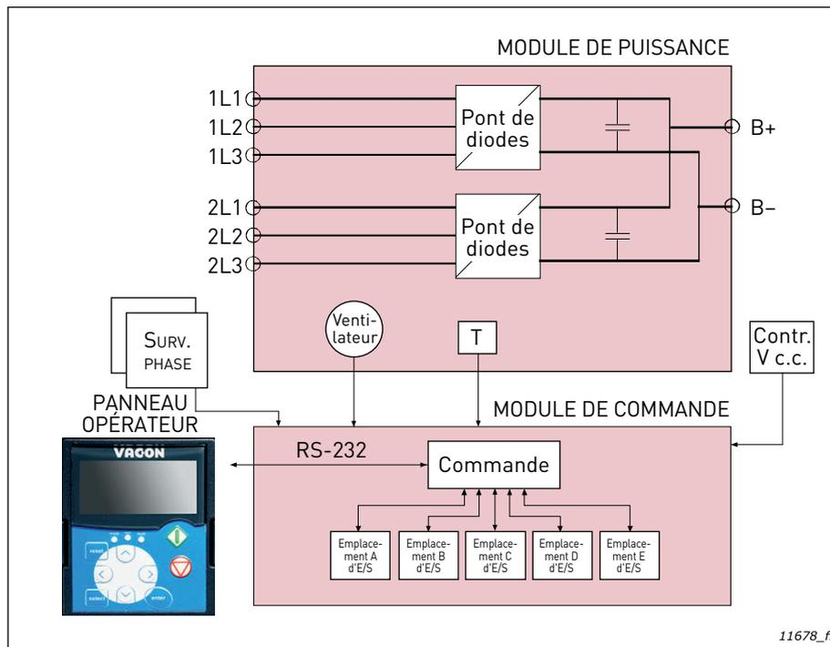
Figure 104. Schéma de principe du module NFE
