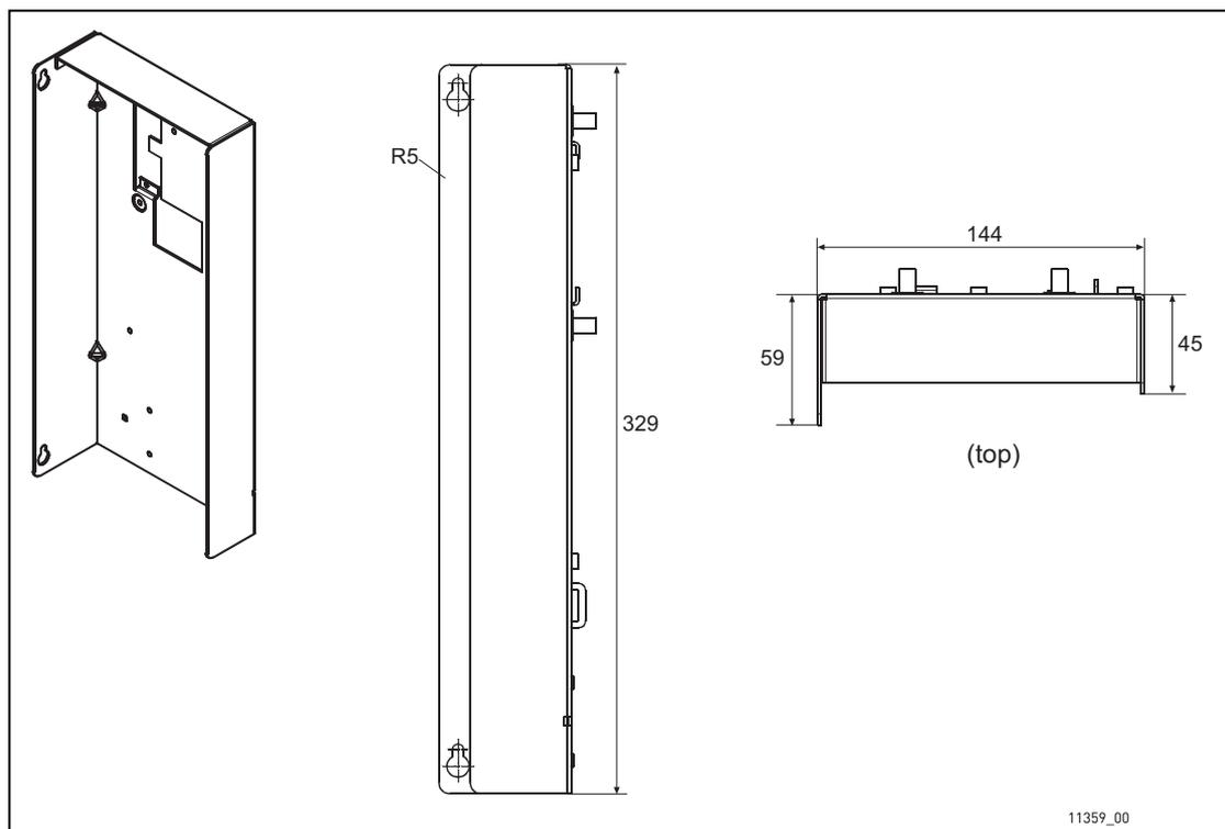
Figure 52. Dimensions du boîtier de l'unité de commande
