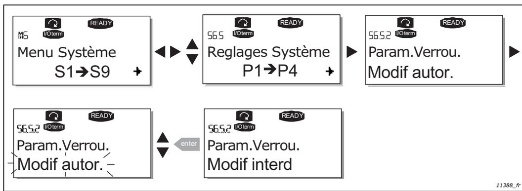
Figure 76. Verrouillage des paramètres
