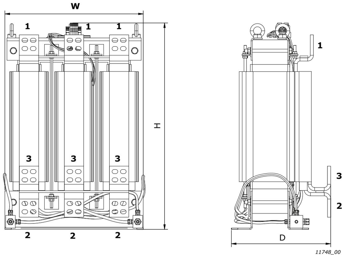
Figure 107.Exemple d'une self FLU-CHK-1030-6-DL
