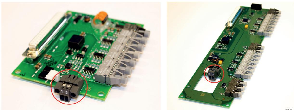
La carte de commande peut également être alimentée par un dispositif externe (+24 V  $\pm 10\%$ ) connecté à l'une des bornes bidirectionnelles #6 ou #12 (voir page 103).
