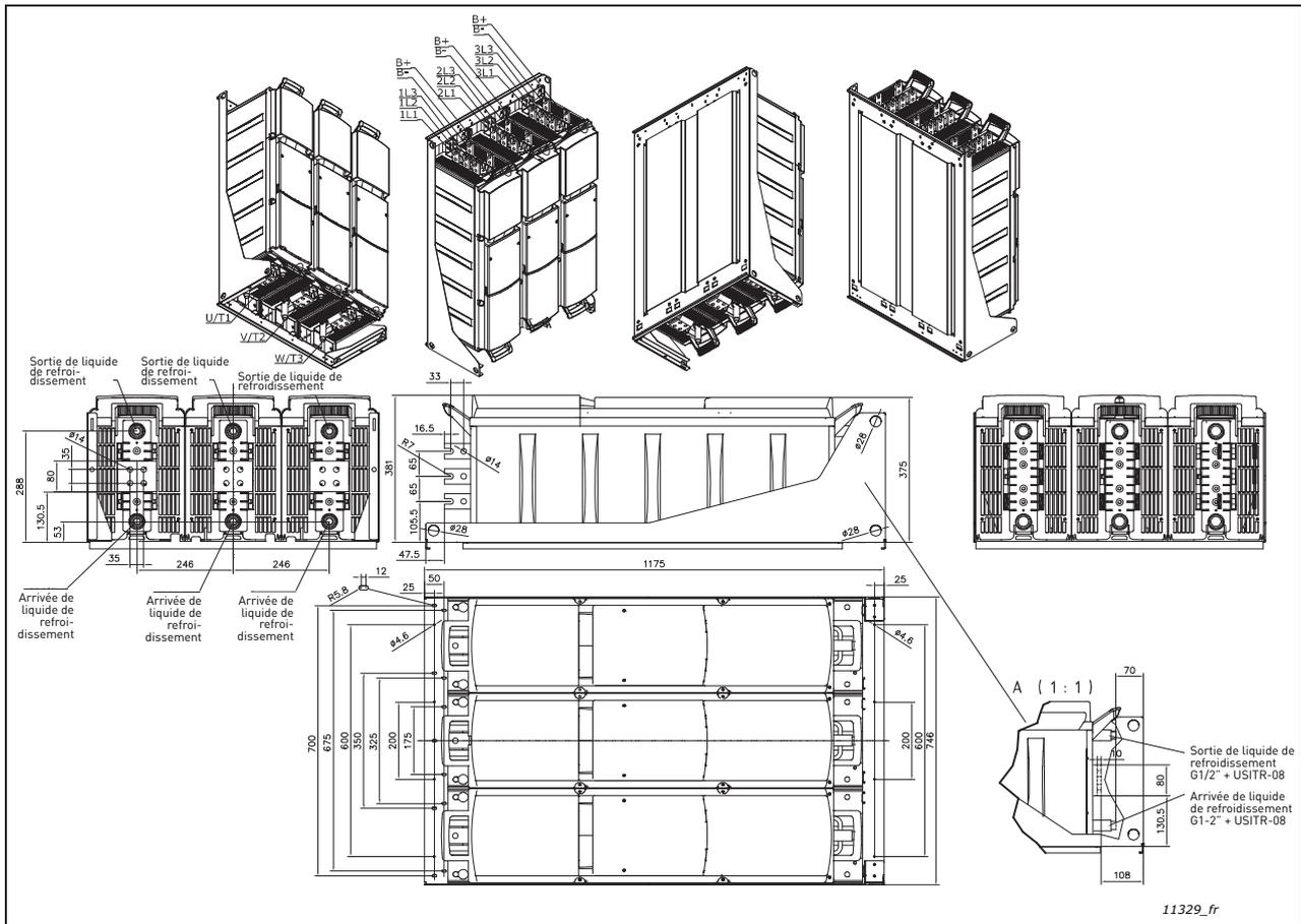
Figure 21. Dimensions du variateur VACON® NX Liquid-Cooled (6 impulsions), CH74, IP00 (type UL ouvert)
