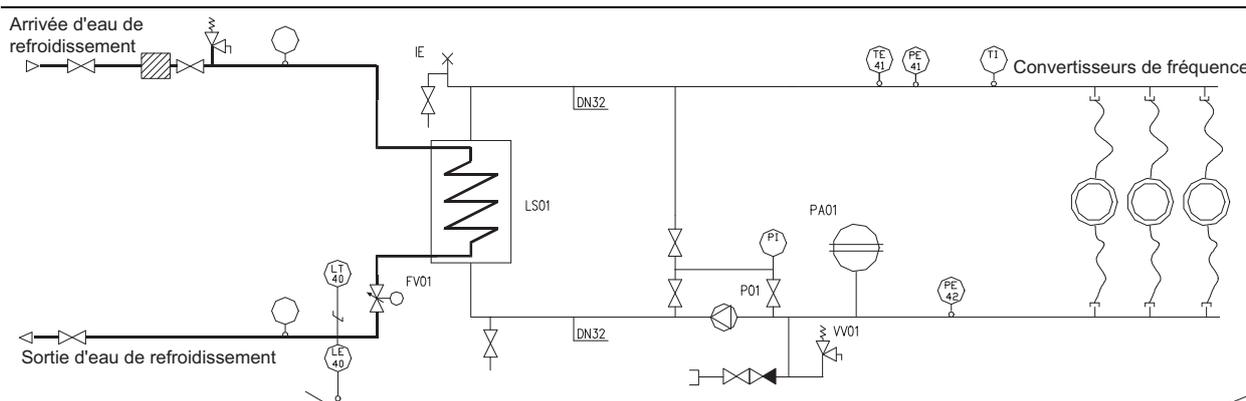
Figure 25. Exemple : Schéma P&ID du circuit de refroidissement et des raccordements
