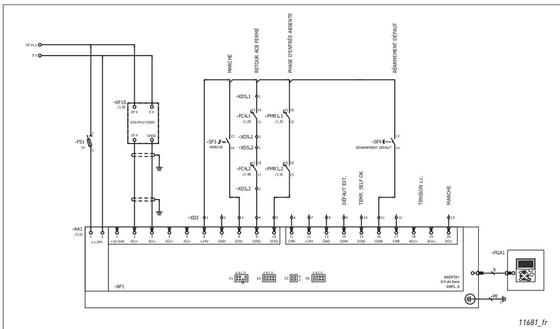
Figure 101. Schéma de câblage des contrôles, OPTA1
