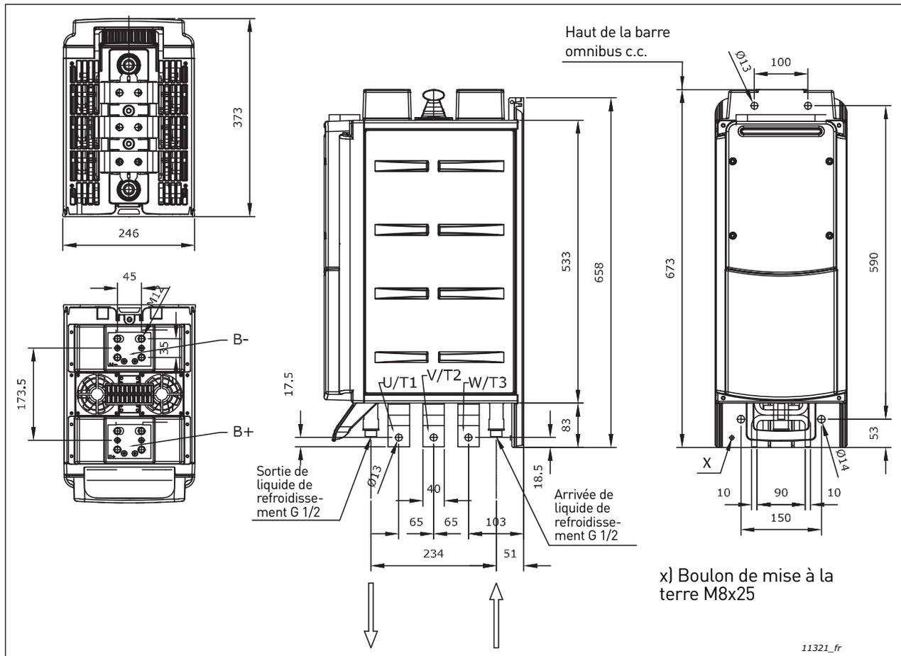
Figure 13. Onduleur VACON® Liquid-Cooled, CH62
