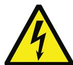
Attendez 5 minutes avant d'ouvrir la porte de l'armoire. Utilisez un dispositif de mesure pour vérifier l'absence de tension. Les connexions des bornes et les composants du variateur peuvent rester sous tension 5 minutes après leur déconnexion du réseau et l'arrêt du moteur.
