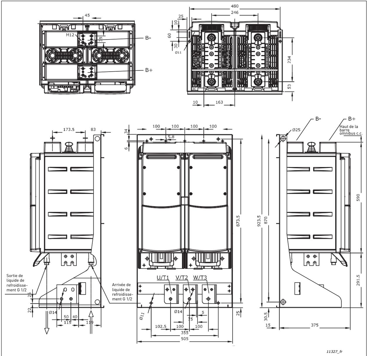
Figure 19. Onduleur VACON® Liquid-Cooled avec console de fixation, CH63
