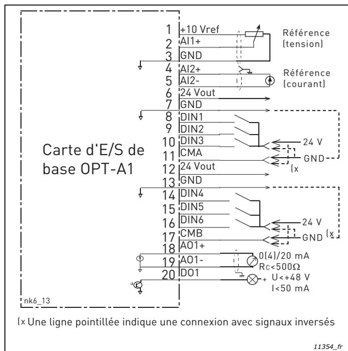
Figure 46. Schéma de câblage général de la carte d'E/S de base (OPT-A1)
