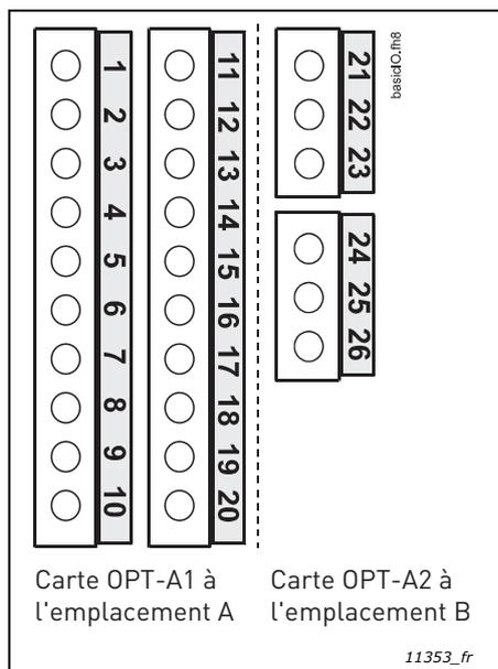
Figure 45. Bornes d'E/S des deux cartes de base
