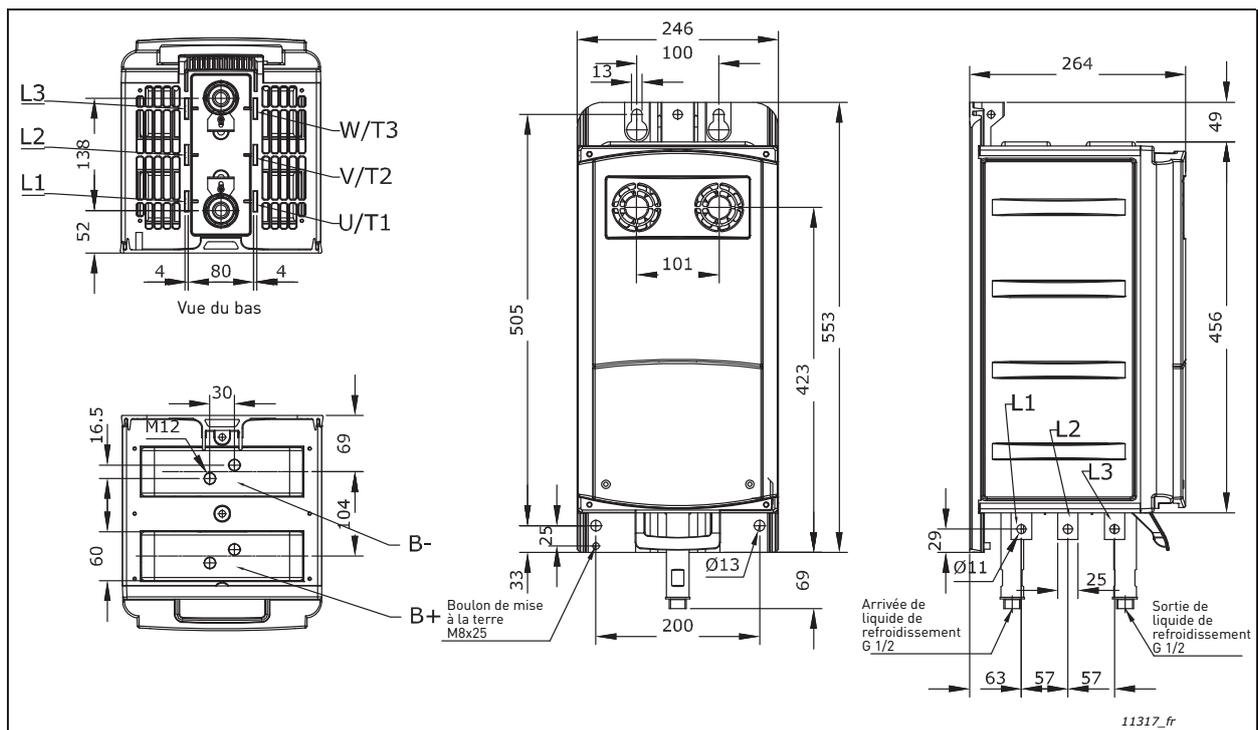
Figure 9. Dimensions du variateur VACON® NX Liquid-Cooled, CH5
