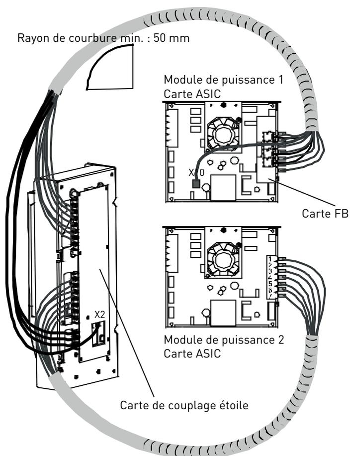
Figure 60. Raccordement des câbles d'alimentation et de commande à l'unité de commande, 2xCH64 et 2xCH74
