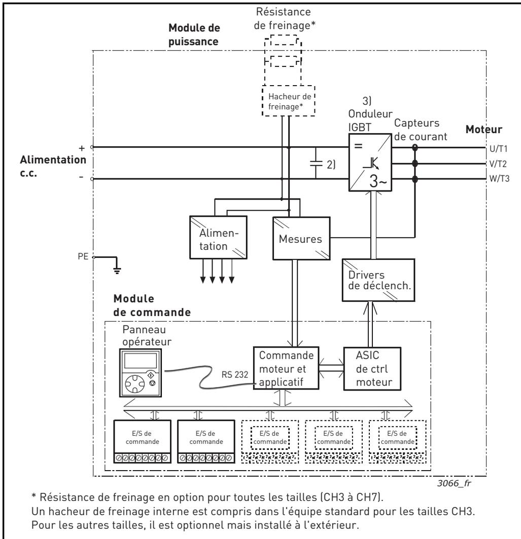
Figure 2. Schéma fonctionnel principal de l'onduleur VACON® NX Liquid-Cooled
