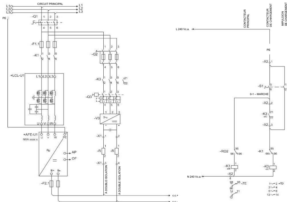
Figure 96. Schéma de câblage du module AFE
