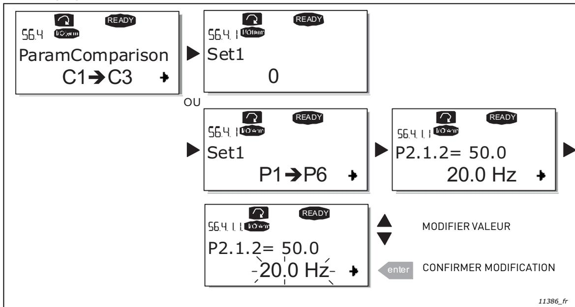
Figure 74. Comparaison des paramètres
