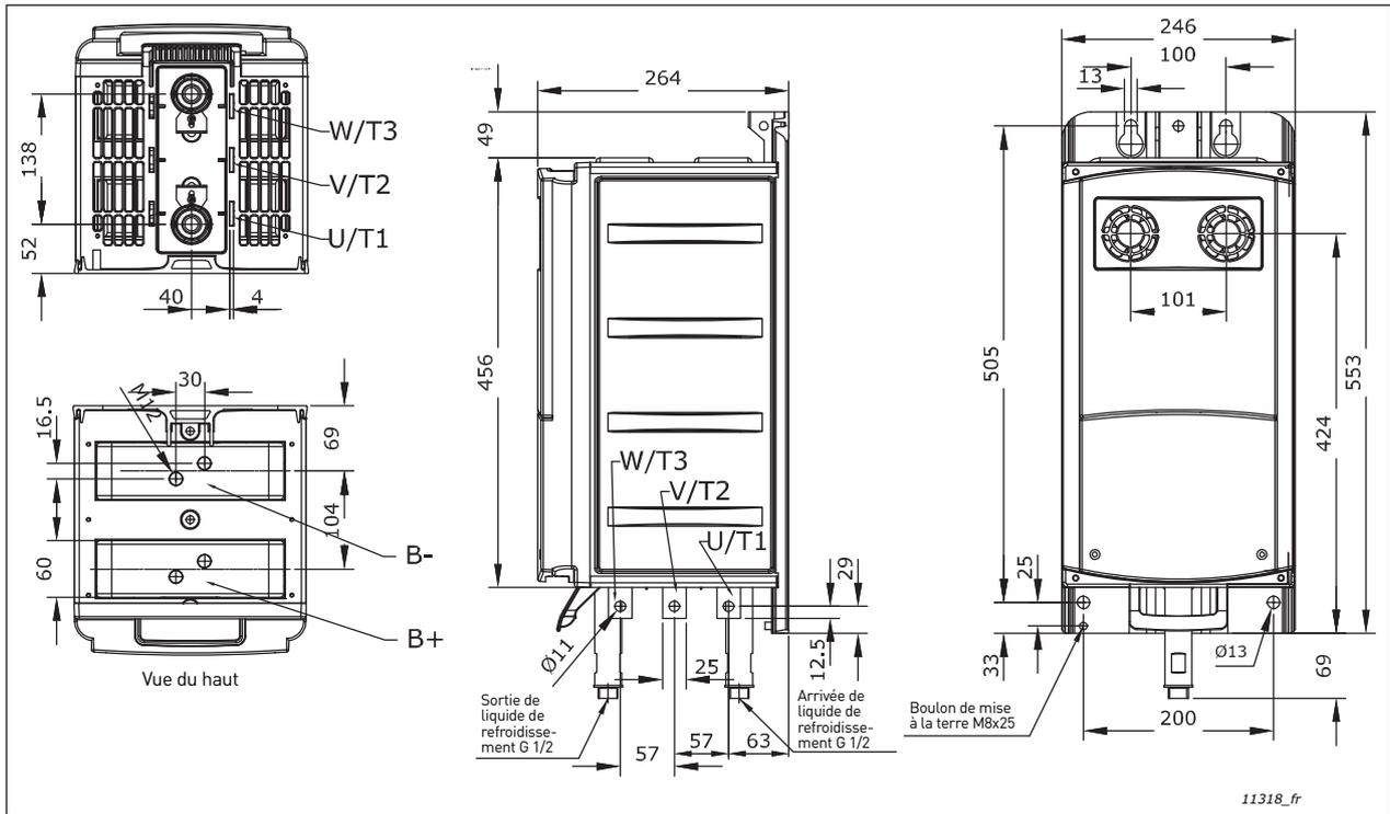
Figure 10. Dimensions du VACON<sup>®</sup> NX Liquid-Cooled, onduleur CH5
