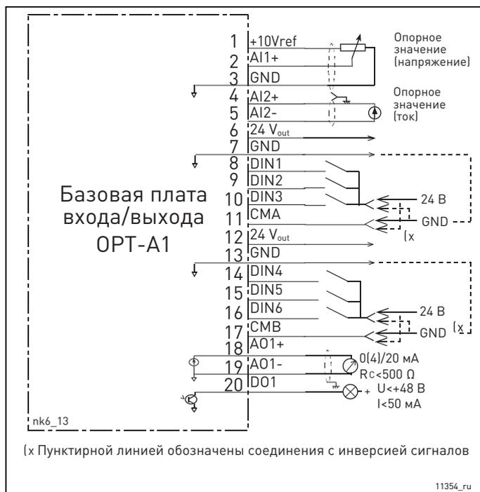
Рис. 46. Общая схема электрических соединений цепей базовой платы входа и выхода (OPT-A1)
