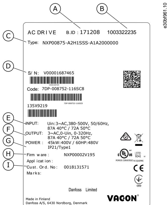
图解 2: VACON® NX 交流变频器的包装标签 (示例)
