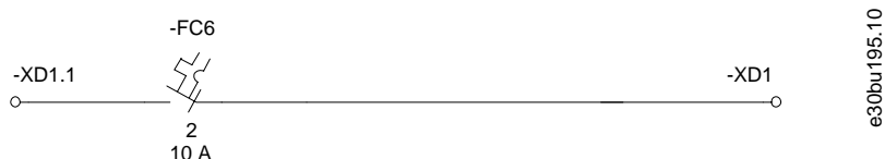
图解 42: 辅助交流电源端子
