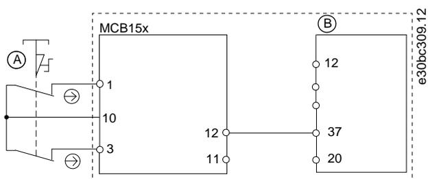
**A** Interrupteur d'arrêt d'urgence à deux voies
