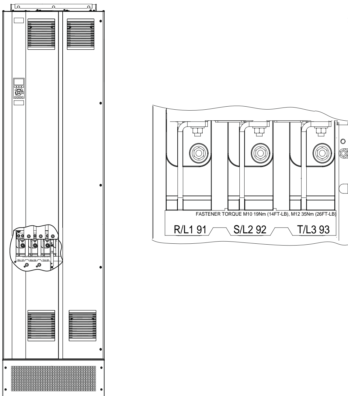
Рисунок 20: Клеммы подключения сети пер. тока (показан корпус E1h).
