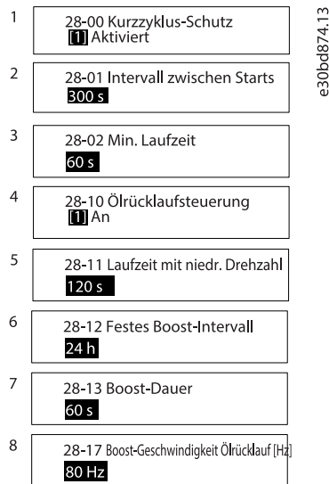
Abbildung 10: Kurzanleitung zu Verdichterfunktionen
