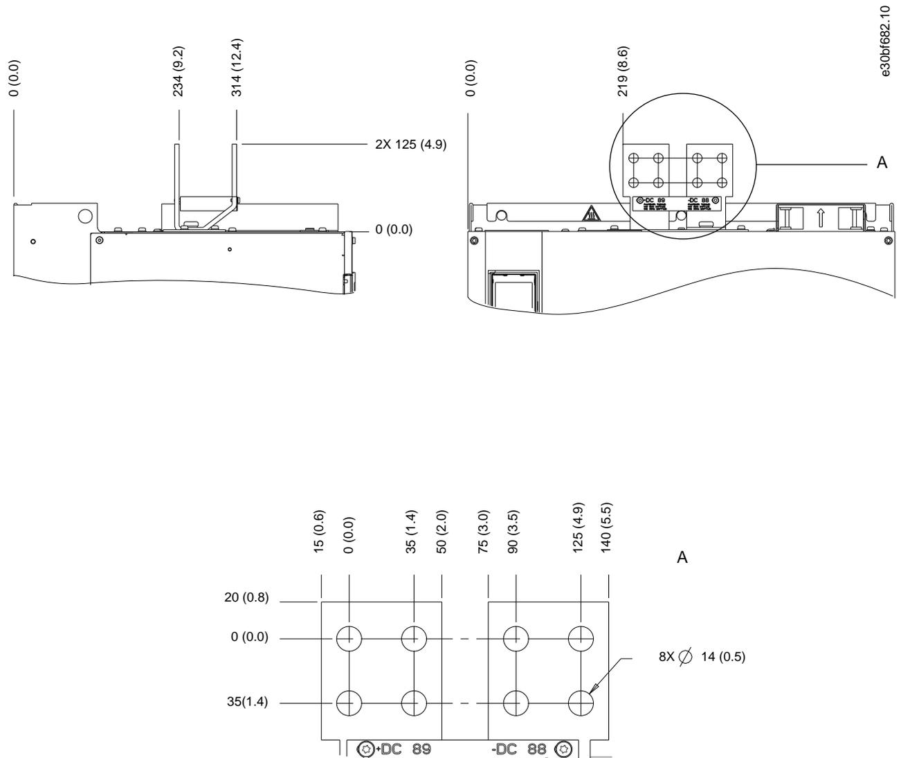
图解 30: E4h 负载共享/再生端子尺寸 (侧视图)
