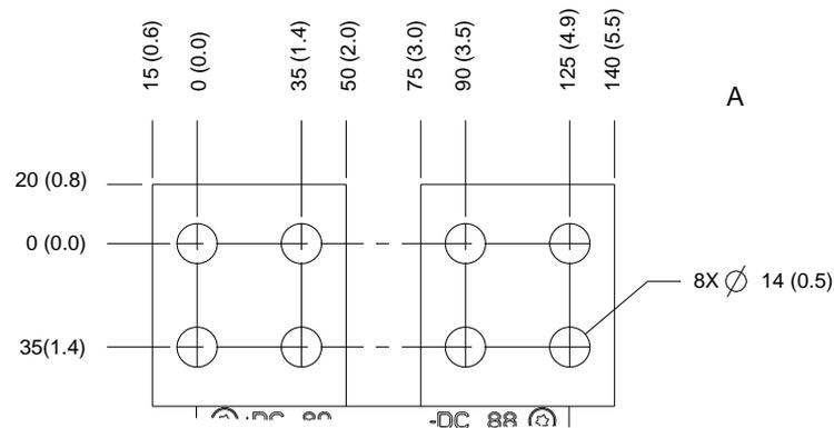
图解 27: E3h 负载共享/再生端子尺寸 (侧视图)
