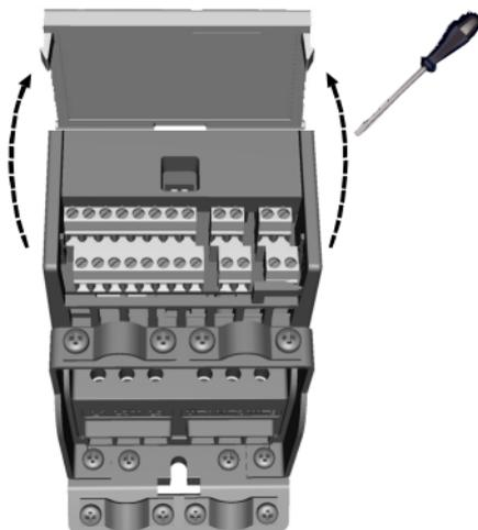
Abbildung 2.6: Öffnen der Abdeckung, MI1 - MI3
