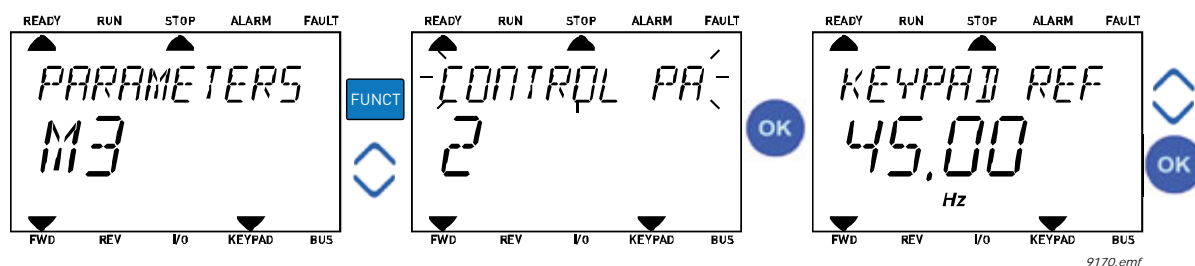
Obr. 15. Prístup na stránku riadenia
