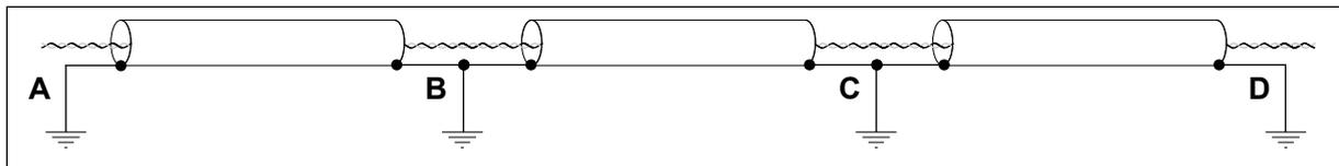
Abb. 52: Erdung in störungsintensiver Umgebung mit gutem Potenzialausgleich. Wenn die Potentiale an den Punkten A, B, C und D sehr unterschiedlich sind und nicht gleichgesetzt werden können, schneiden Sie die Abschirmungen wie in Abb. 53.
