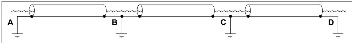
Abb. 55: Erdung in störungsintensiver Umgebung mit gutem Potenzialausgleich. Wenn die Potentiale an den Punkten A, B, C und D sehr unterschiedlich sind und nicht gleichgesetzt werden können, schneiden Sie die Abschirmungen wie in Abb. 56.
