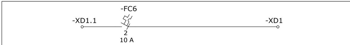
Abb. 22: Anschlüsse für Hilfs-AC-Versorgung
