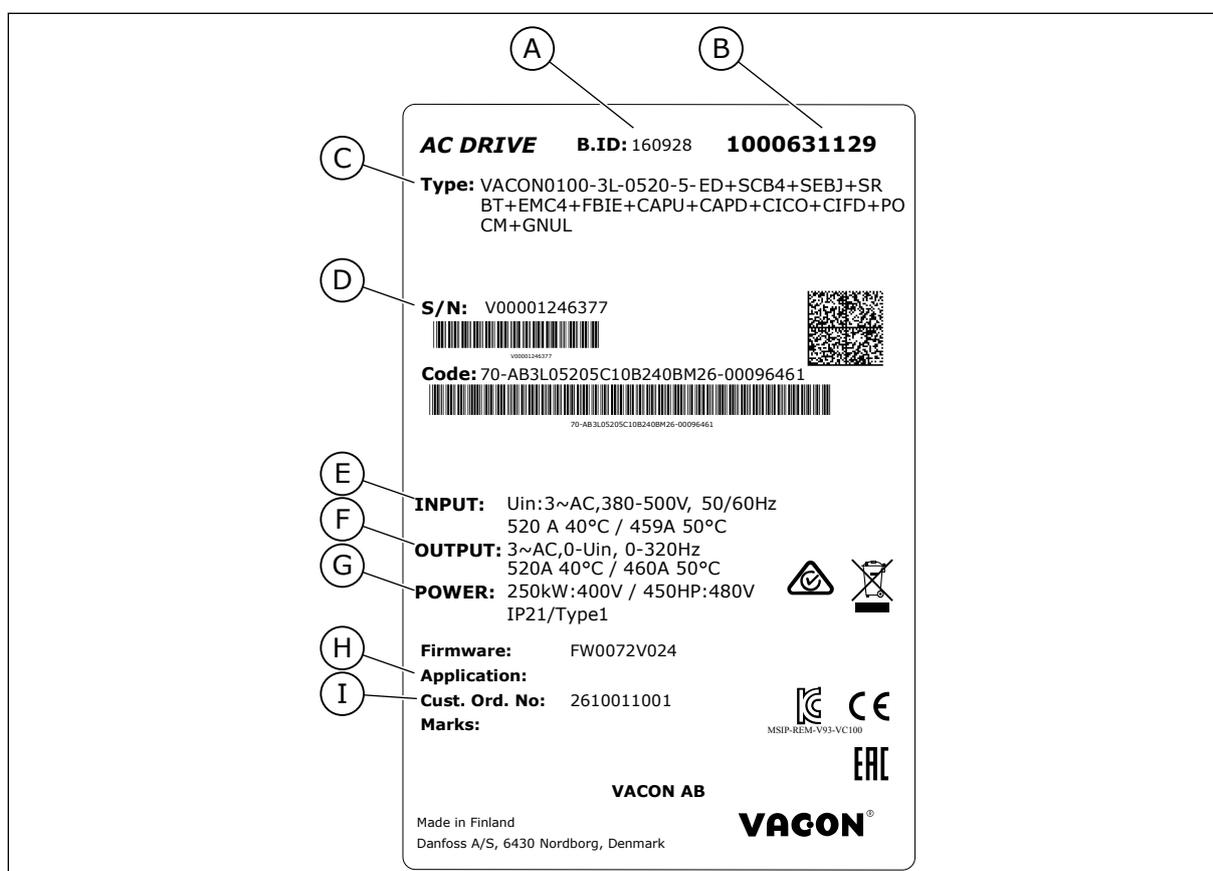
Abb. 2: Verpackungsetikett der VACON® Frequenzumrichter
