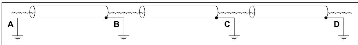
Abb. 56: Erdung in störungsintensiver Umgebung mit schlechtem Potenzialausgleich. Ein Beispiel für das Schneiden der Abschirmung.
