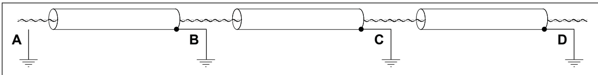
Kuva 53: Maadoitus ja huonosti toteutettu potentiaalintasaus ympäristössä, jossa on kohinaa. Esimerkki suojan leikkaamisesta.
