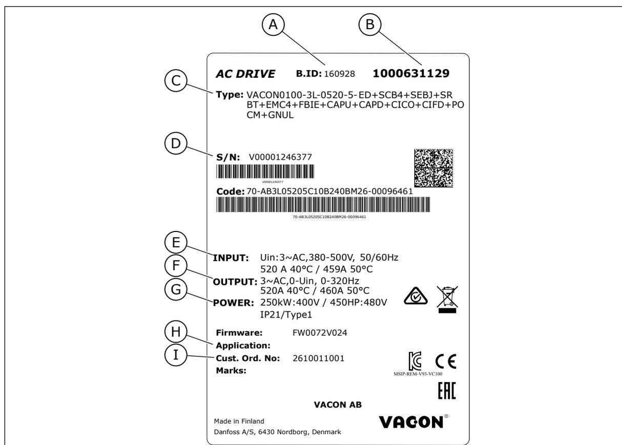
Fig. 2: Étiquette d'emballage des convertisseurs de fréquence VACON®
