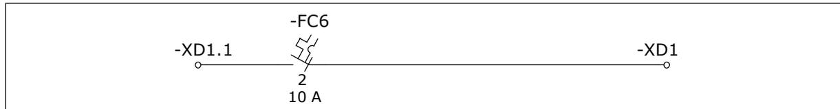
Fig. 21: Borne d'alimentation c.a. auxiliaire
