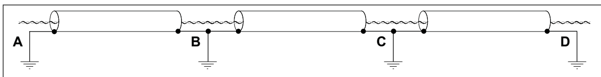
Afb. 52: Aarding in een omgeving met veel ruis en een goede potentiaalvereffening. Als de potentialen op de punten A, B, C en D sterk verschillen en niet vereffend kunnen worden, snijd de afschermingen dan door zoals aangegeven in Afb. 53.
