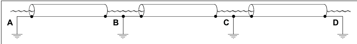
Afb. 55: Aarding in een omgeving met veel ruis en een goede potentiaalvereffening. Als de potentialen op de punten A, B, C en D sterk verschillen en niet vereffend kunnen worden, snijd de afschermingen dan door zoals aangegeven in Afb. 56.
