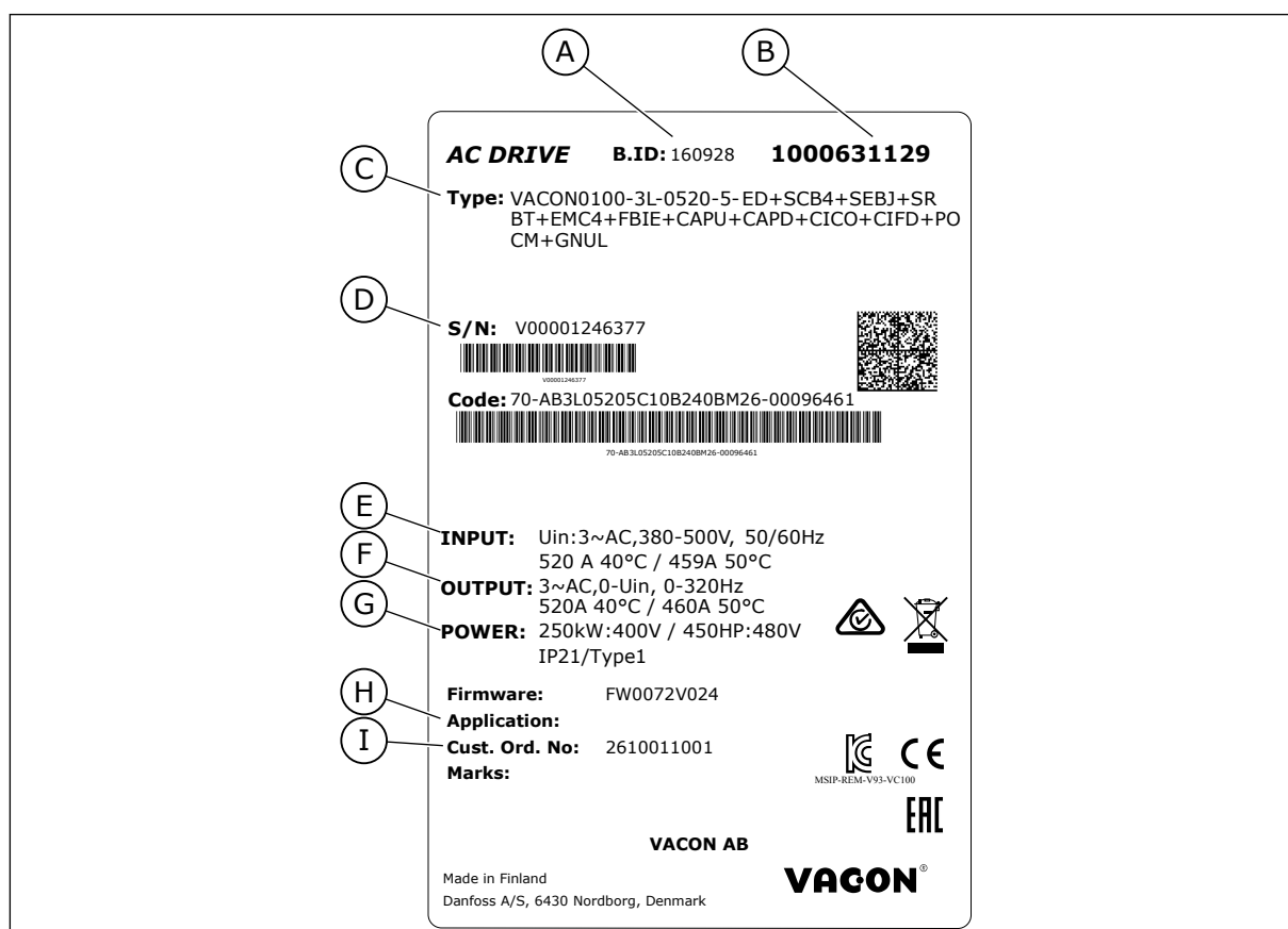
Bild 2: Förpackningsetikett för VACON®-frekvensomriktare
