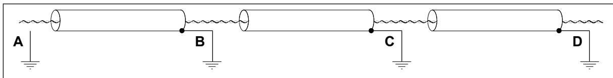
Bild 56: Jordning i störande miljö med dålig utjämningspotential. Ett exempel på hur skärmen kapas.
