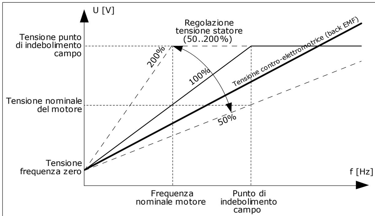
Fig. 22: la regolazione della tensione dello statore
