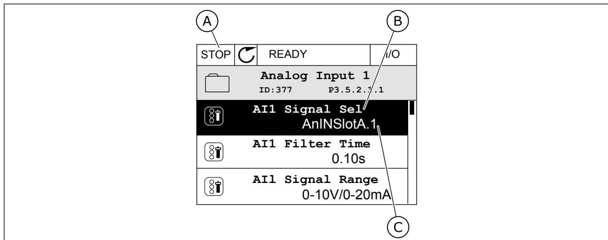
Fig. 45: il menu Ingressi analogici nel display grafico
