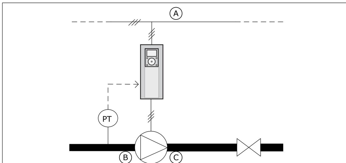
Fig. 78: la posizione del sensore di pressione
