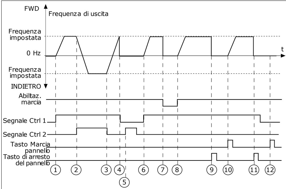
Fig. 31: I/O A - selezione logica marcia/arresto = 3
