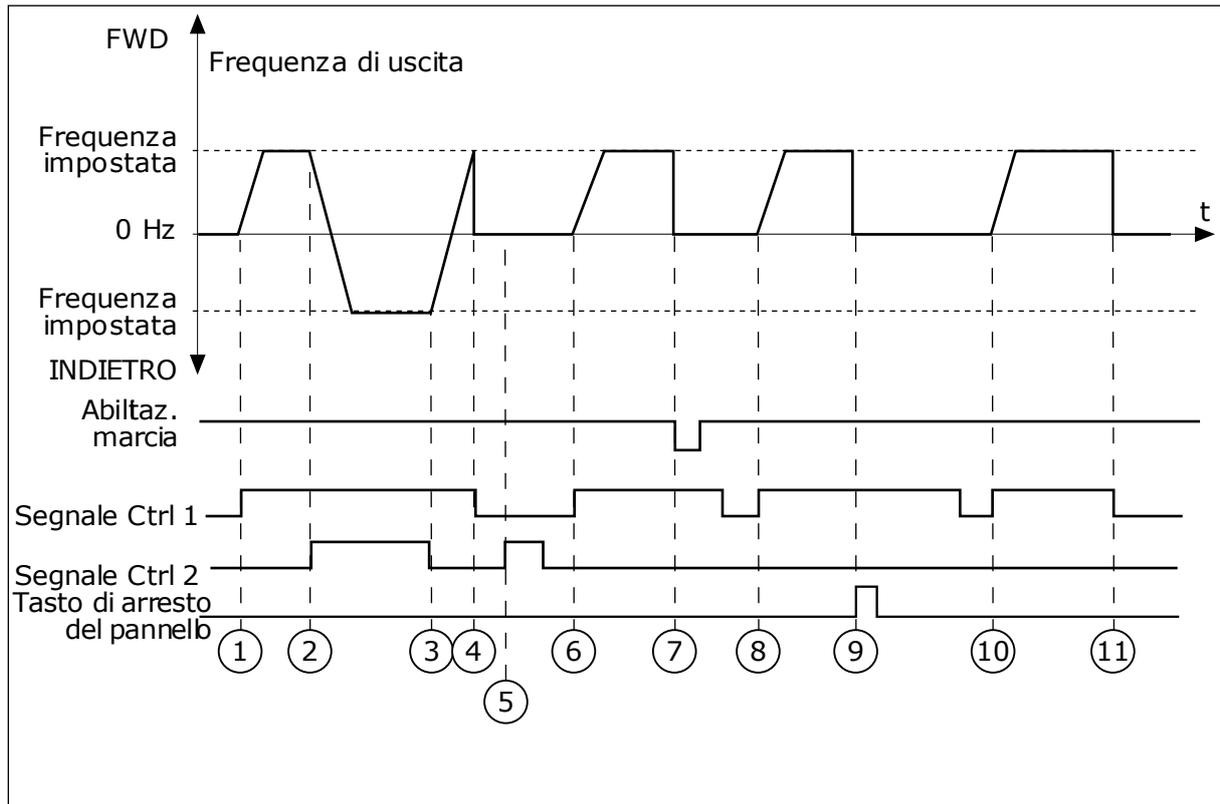
Fig. 32: I/O A - selezione logica marcia/arresto = 4
