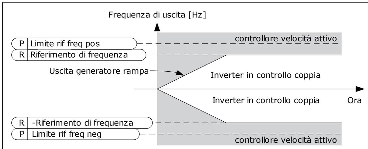
Fig. 36: Limite frequenza controllo coppia, selezione 1
