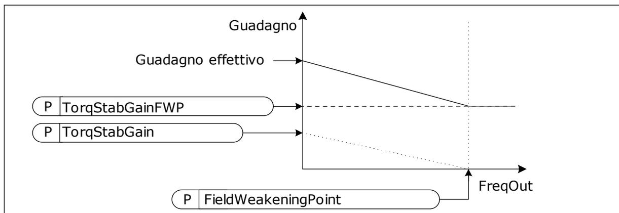
Fig. 26: il guadagno dello stabilizzatore di coppia
