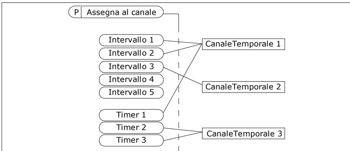
Fig. 64: L'assegnazione di intervalli e timer ai canali temporali è flessibile. Ogni intervallo e ogni timer dispone di un proprio parametro per l'assegnazione a un canale temporale.
