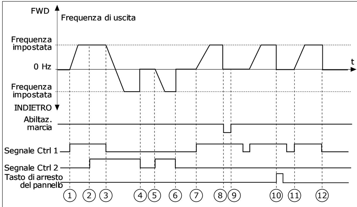
Fig. 30: I/O A - selezione logica marcia/arresto = 2
