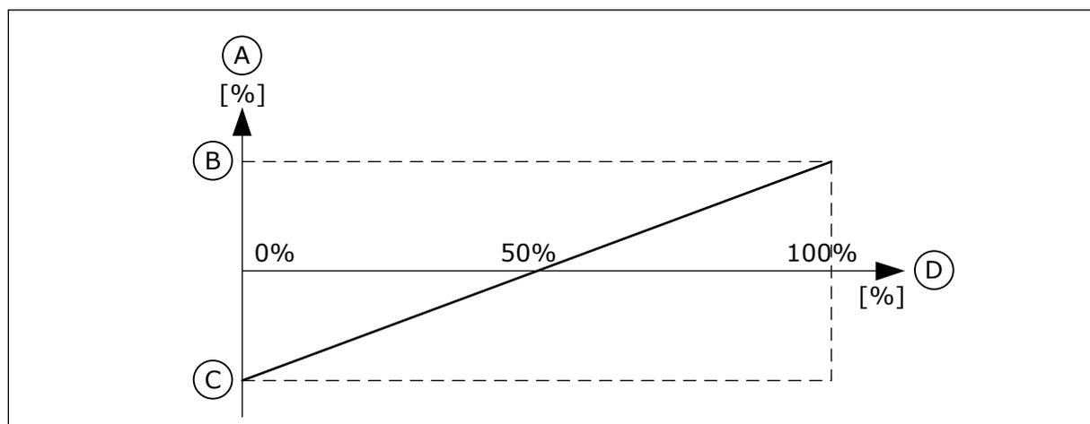
Fig. 34: scalatura del segnale di riferimento di coppia
