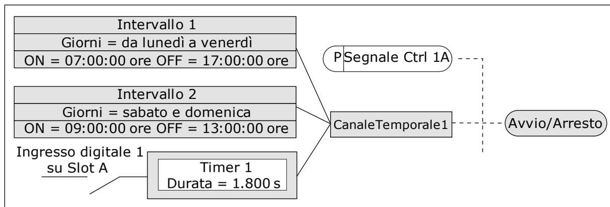
Fig. 69: Il canale temporale 1 viene utilizzato come segnale di controllo per il comando di marcia al posto di un ingresso digitale
