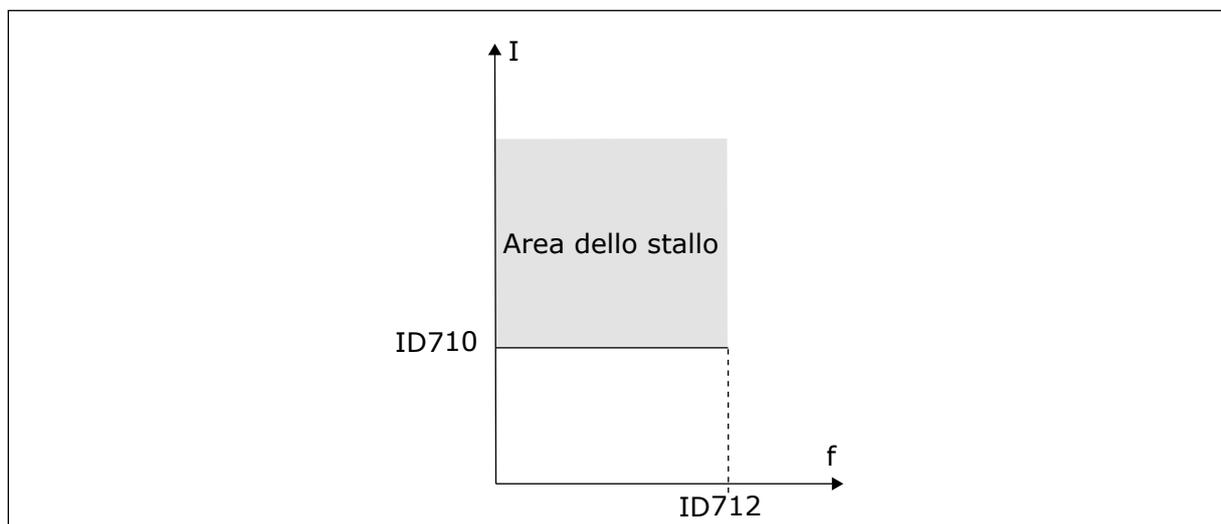
Fig. 59: le impostazioni relative alle caratteristiche dello stallo
