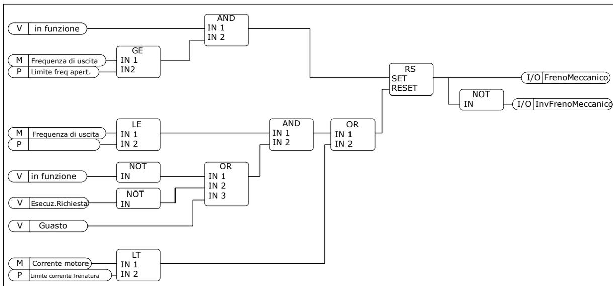
Fig. 89: la logica di apertura del freno meccanico
