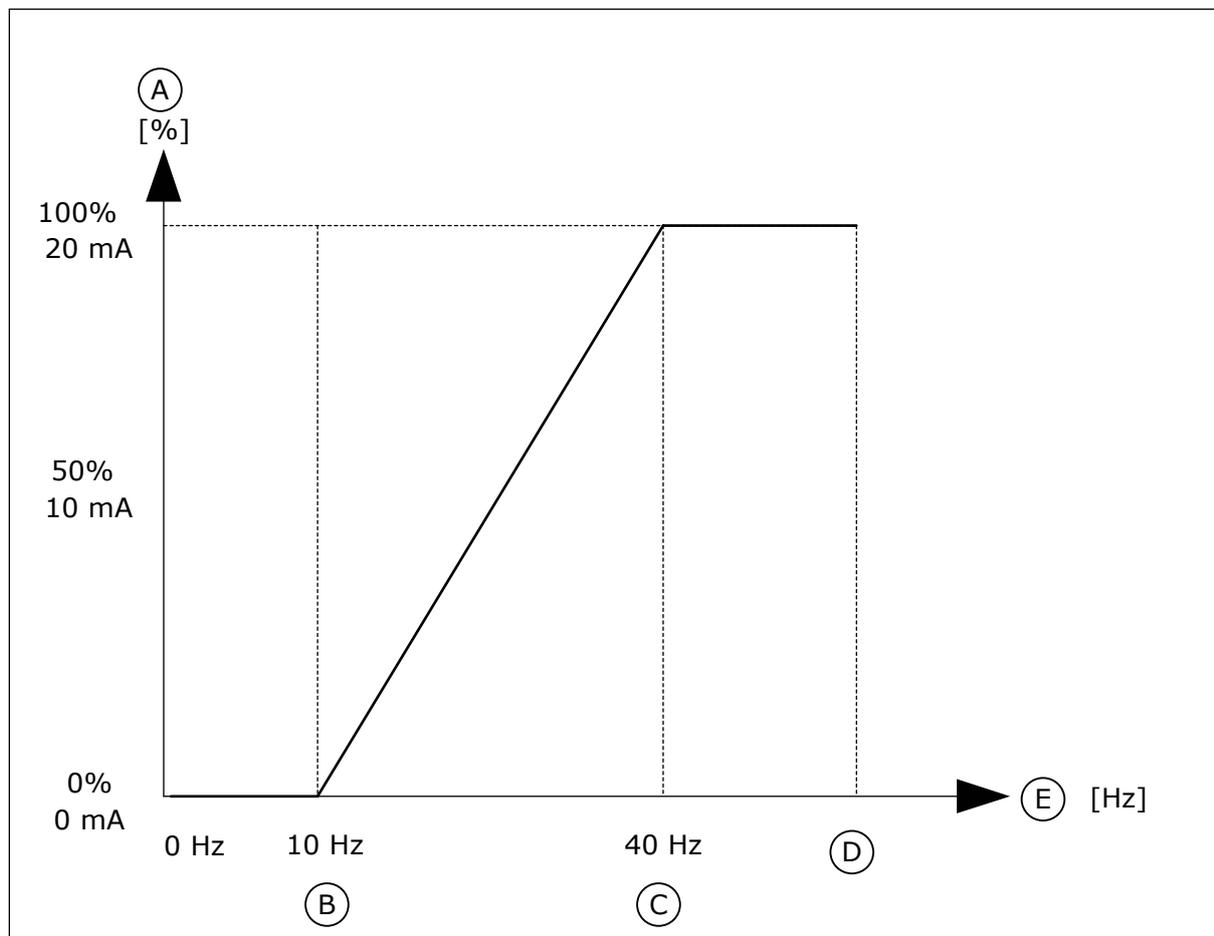
Fig. 53: la scalatura del segnale A01
