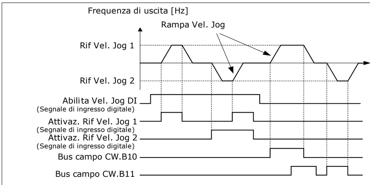
Fig. 39: i parametri di velocità di jog
