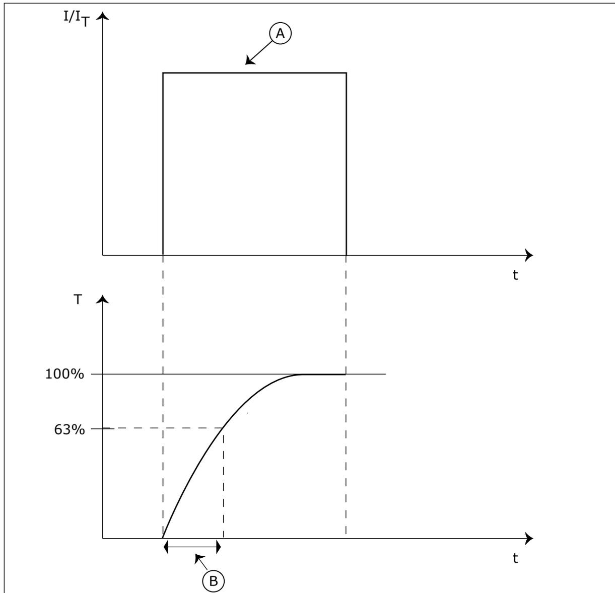
Fig. 57: la costante temporale per la protezione termica del motore
