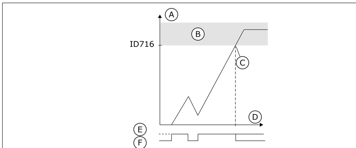
Fig. 61: la funzione contatore tempo di sottocarico
