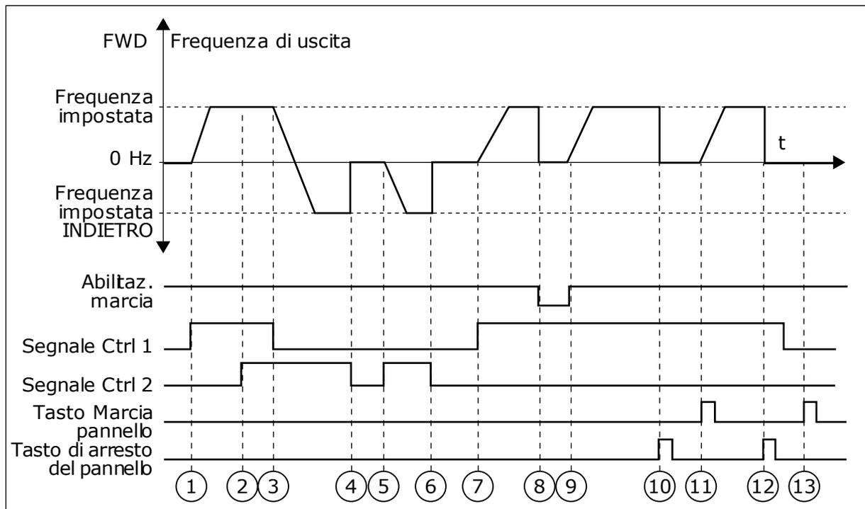
Fig. 28: I/O A - selezione logica marcia/arresto = 0
