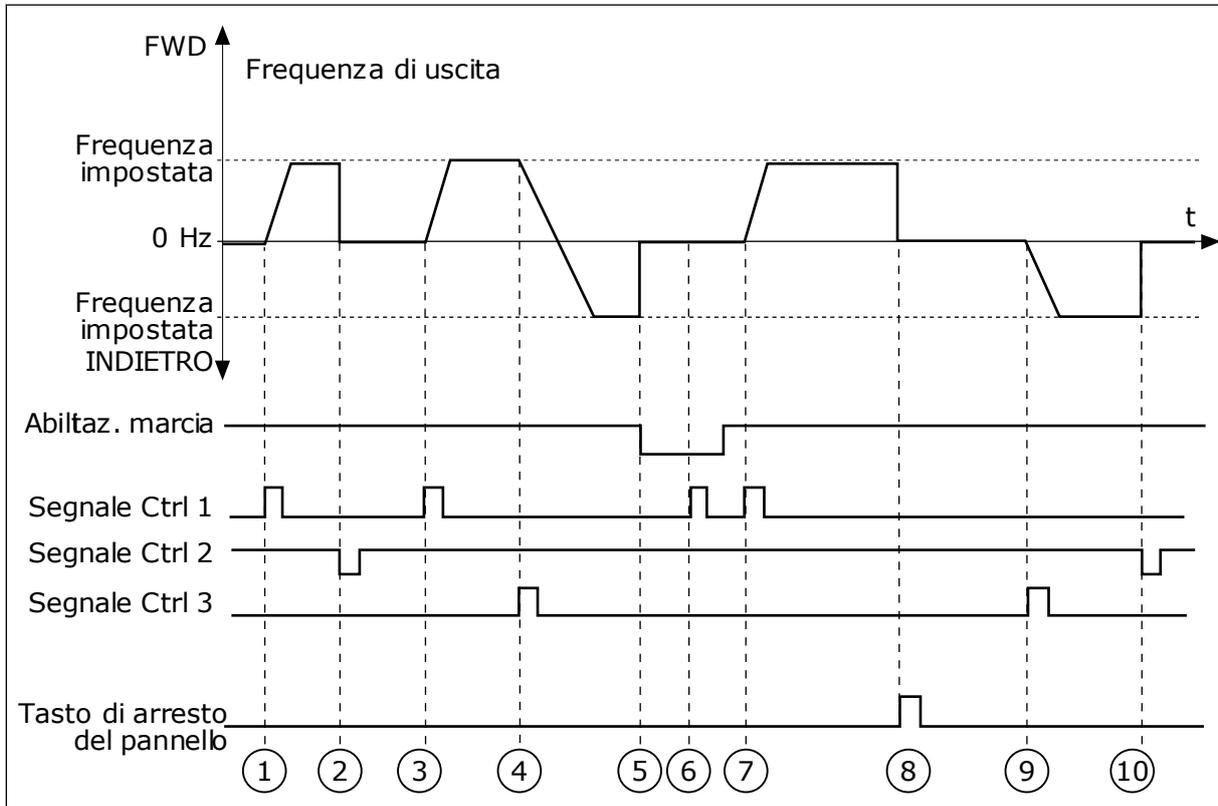
Fig. 29: I/O A - selezione logica marcia/arresto = 1
