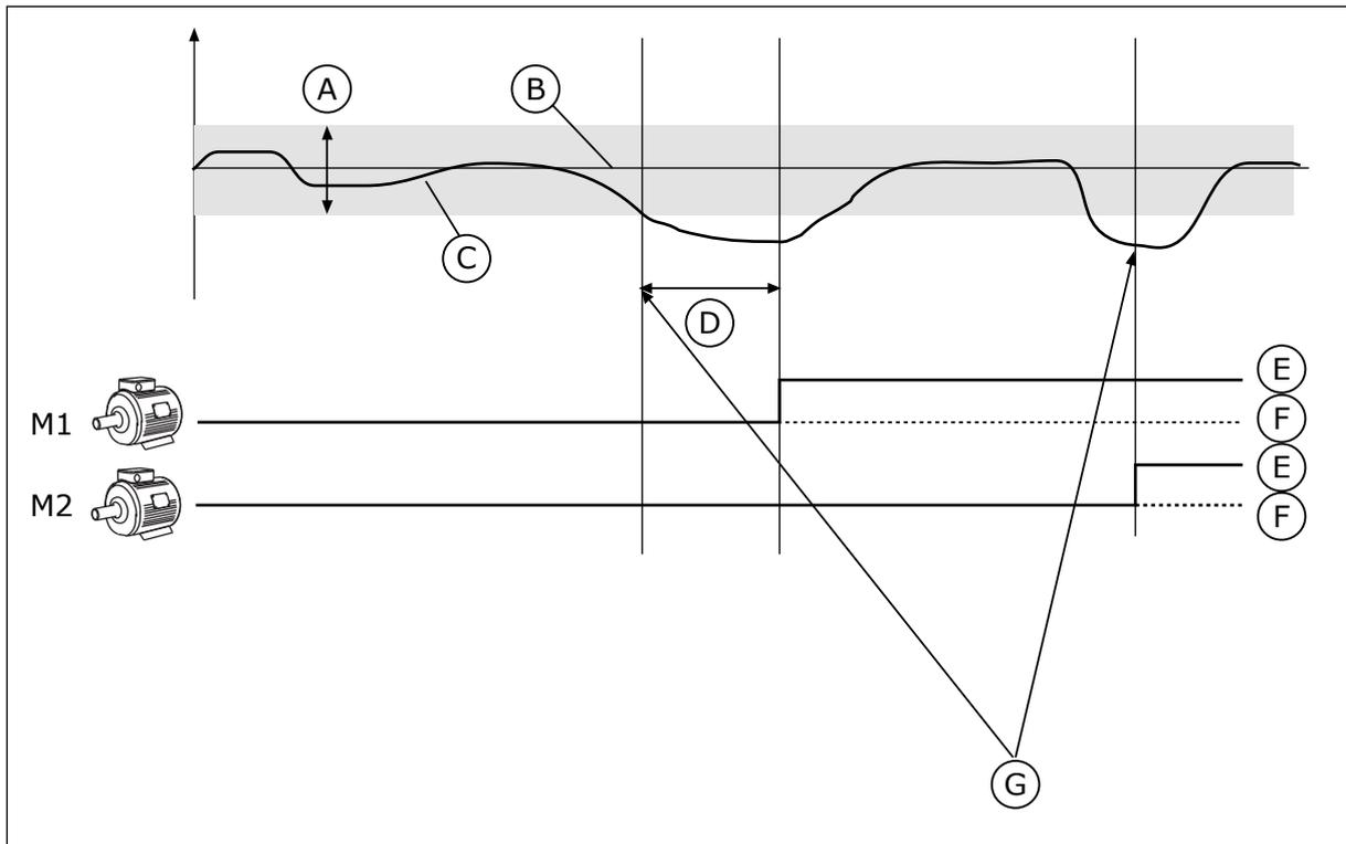
Fig. 80: La funzione Multi-pompa
