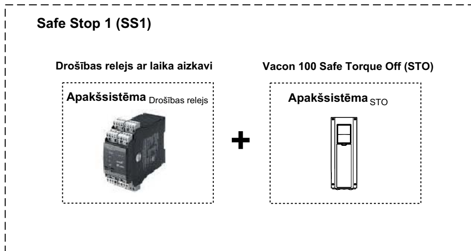
7. attēls. Safe Stop 1 (SS1) drošības funkcija
