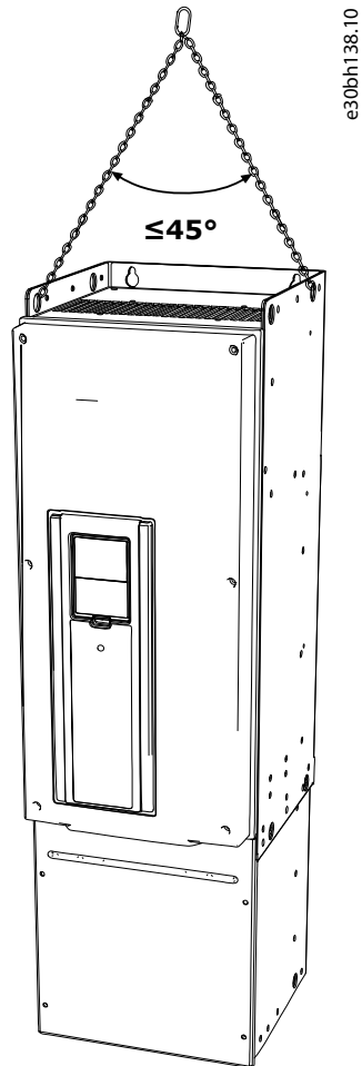
Kuva 2: Suurin sallittu nostokulma
