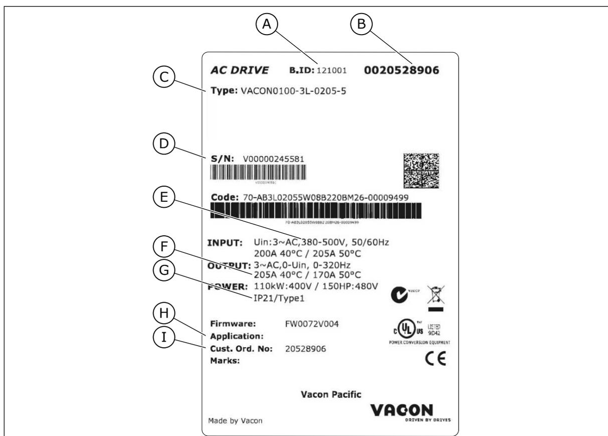
Fig. 1: Étiquette d'emballage des convertisseurs de fréquence Vacon
