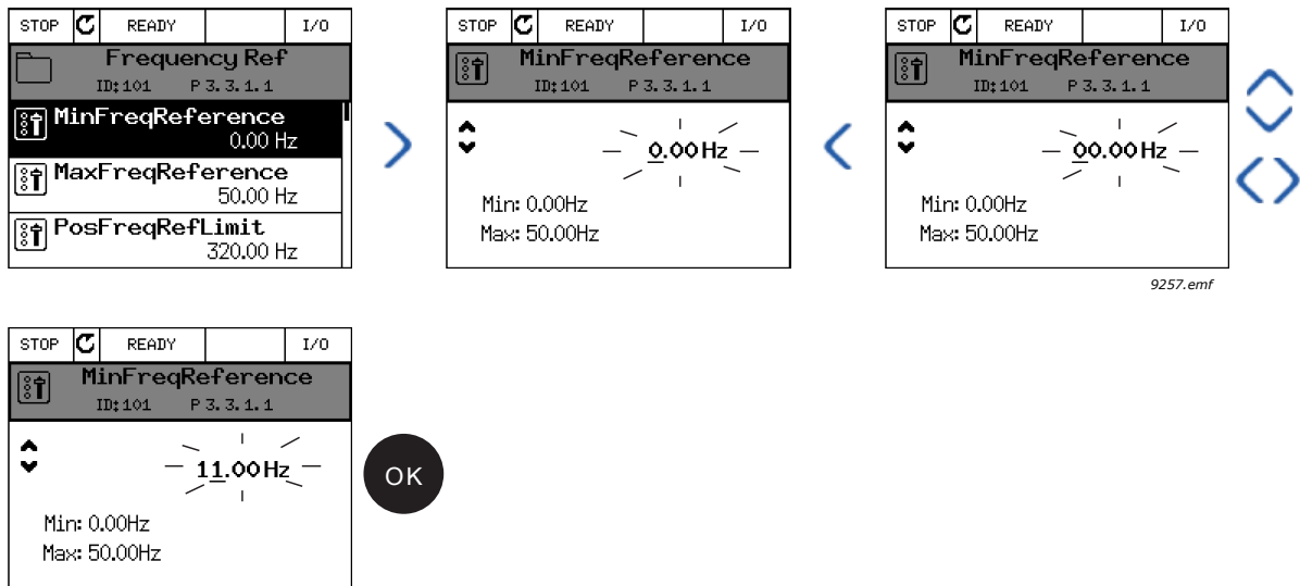
Figure 62. Modification standard des valeurs à l'aide du panneau opérateur à affichage graphique (valeur numérique)
