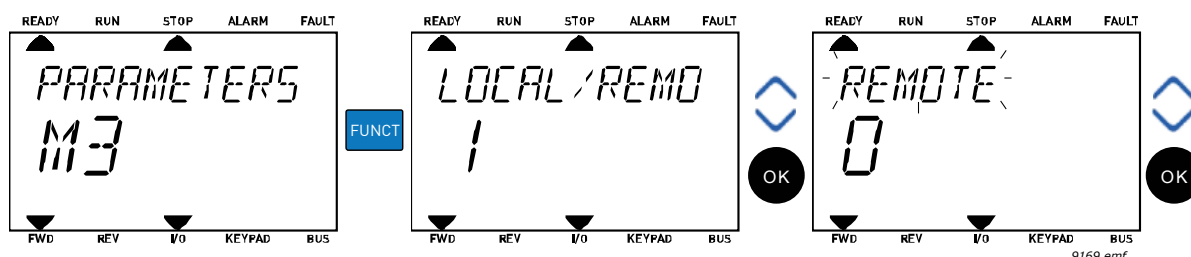
Figura 71. Cambio de las estaciones de control.
