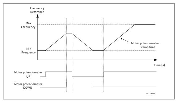
Figure 34. Motor potentiometer parameters
