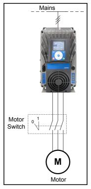
Figure 27. Motor switch
