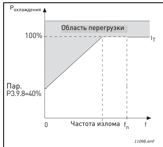
Рис. 26. Кривая теплового тока двигателя I_T
