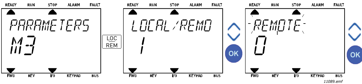
Figure 10. Modification de la source de commande
