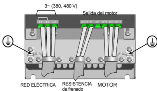
Figure 13: Conexiones de alimentación de Vacon 20, MI5
