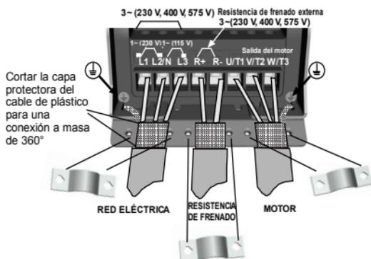
Figure 11: Conexiones de alimentación de Vacon 20, MI2 - MI3
