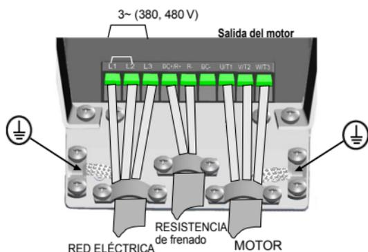
Figure 12: Conexiones de alimentación de Vacon 20, MI4
