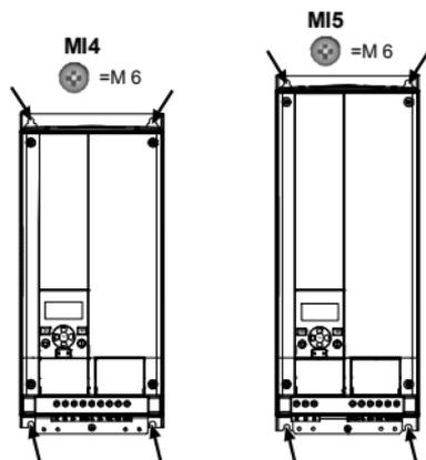
Figure 2: Montaje con tornillos, MI4 - MI5
