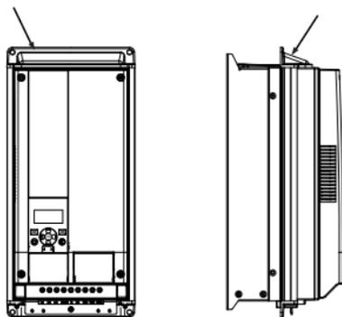
Figure 4: Montaje con bridas, MI4 - MI5
