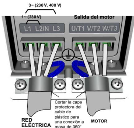
Figure 10: Conexiones de alimentación de Vacon 20, MI1
