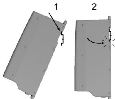
Figure 3: Montaje con raíles DIN, MI1 - MI3
