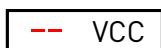
Figura 6. Um "--" vermelho piscante indica que não há leitura válida de tensão no barramento CC
