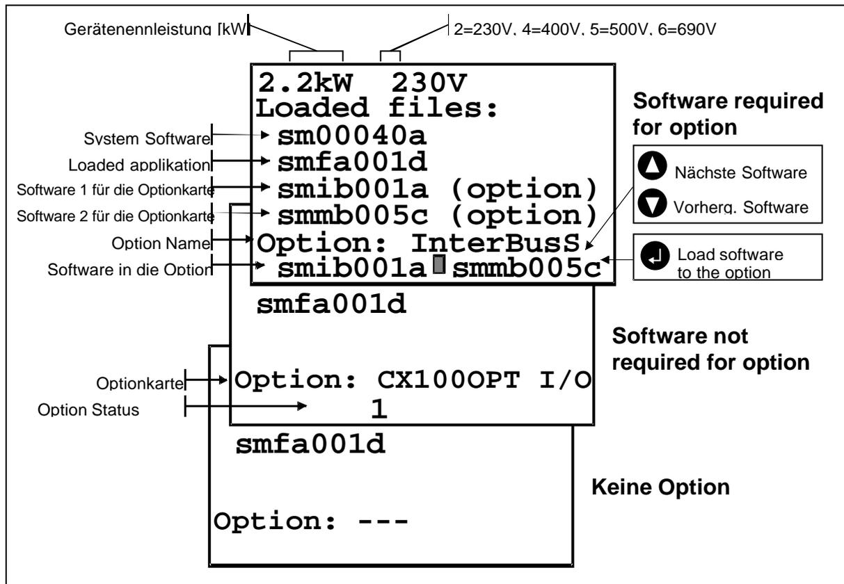
Abb. 12. Softwareinformation und Ladevorgang der Zusatzkartensoftware.
