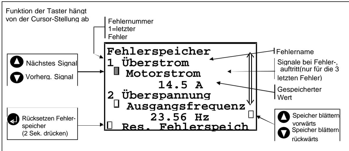
Abb. 10. Fehlerspeicher-Display.
