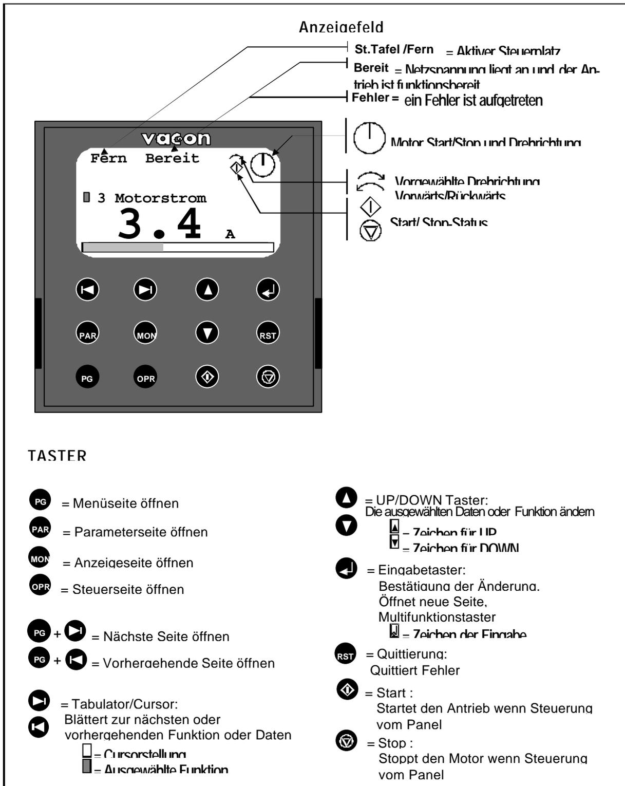
Abb. 1. Graphikpanel mit LCD Display.
