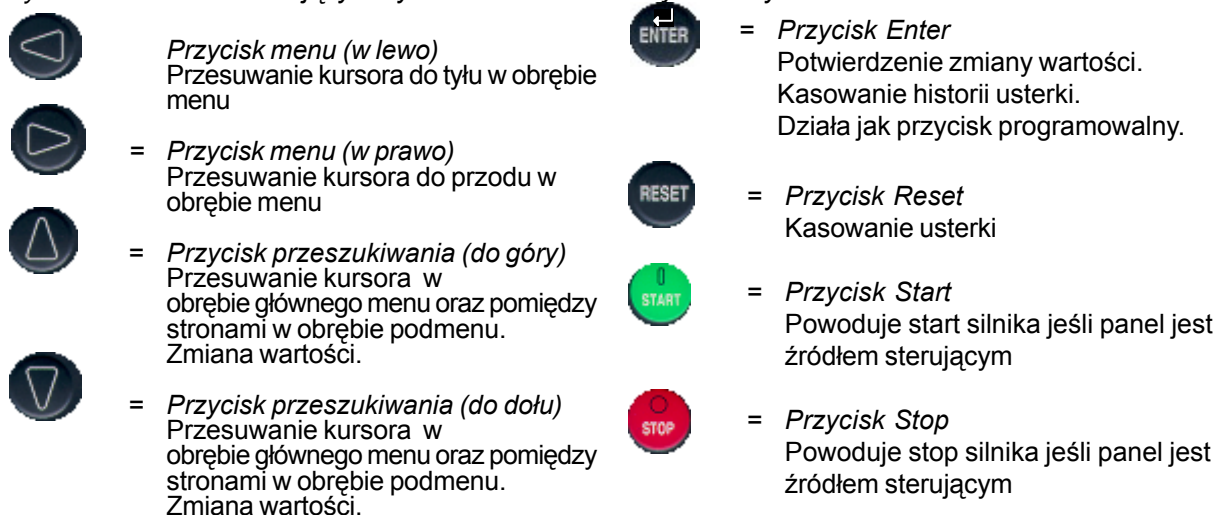
Rysunek 7-1. Panel sterujący z wyświetlaczem ciekłokrystalicznym LCD .
