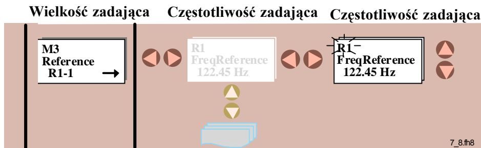
Rysunek 7-8. Ustawianie wielkości zadających na panelu sterującym
