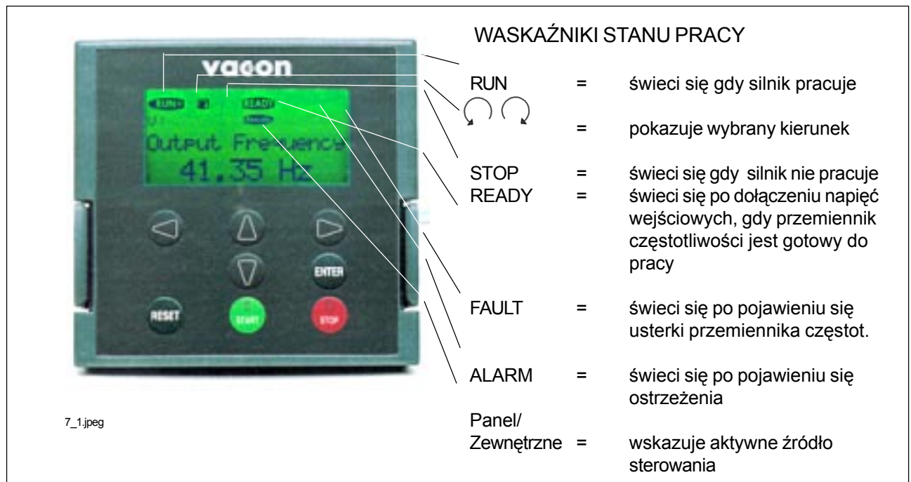
Rysunek 7-1. Panel sterujący z wyświetlaczem ciekłokrystalicznym LCD .
