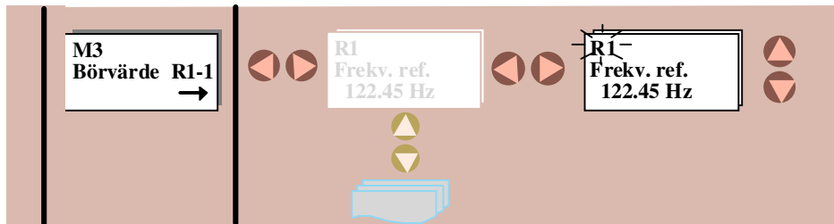
Figur 7-8. Inställning av referensvärde från kontrollpanelen.
