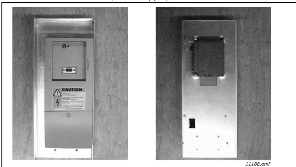
Рис. 28. Блок управления устанавливается в монтажной коробке;
