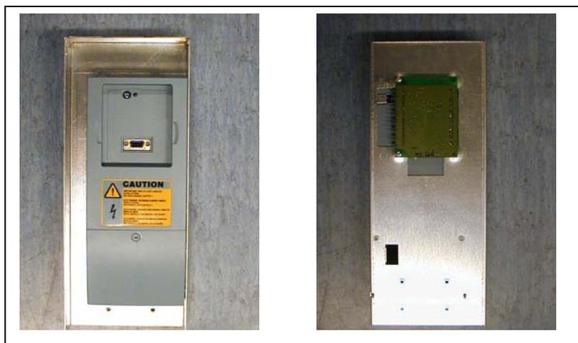
图 5-6. 安装在箱内的控制单元；左面：前面；右面：背面
