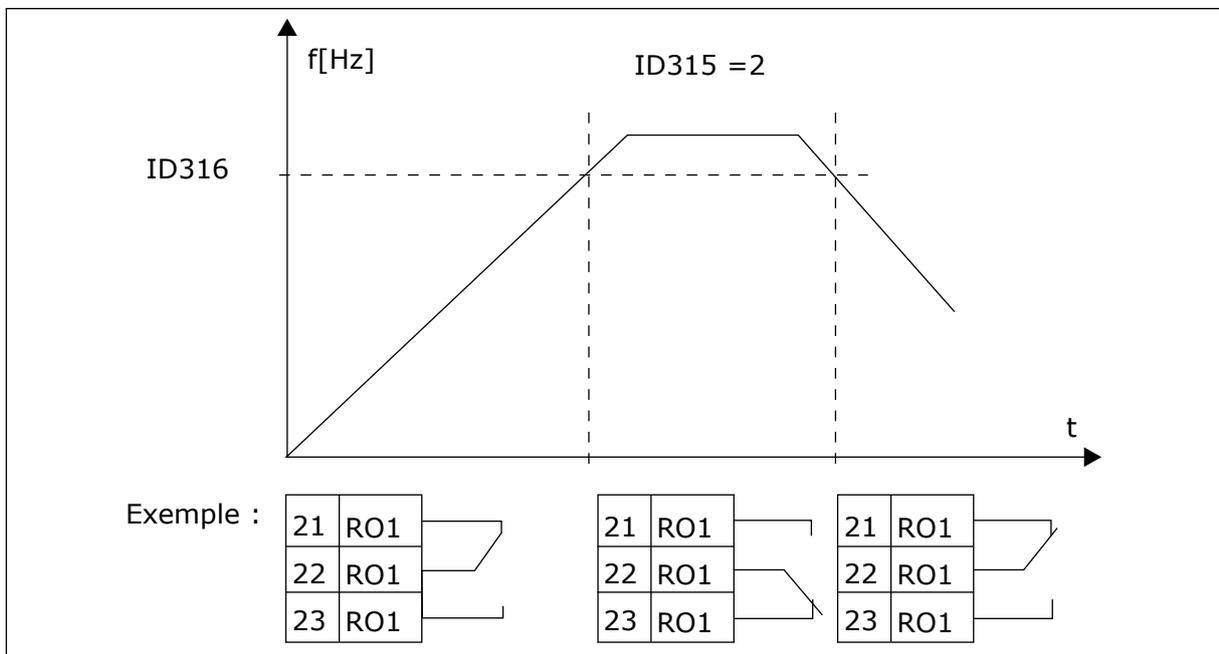
Fig. 40: Supervision de fréquence de sortie
