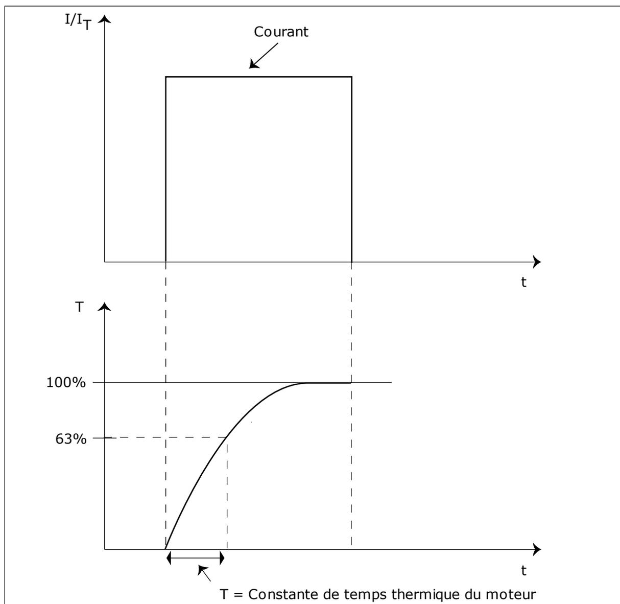
Fig. 73: Constante de temps thermique du moteur
