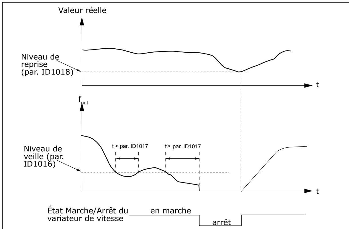
Fig. 81: Fonction veille du convertisseur de fréquence
