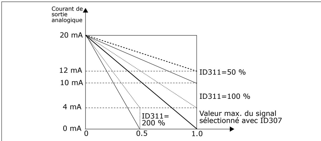
Fig. 38: Inversion de sortie analogique
