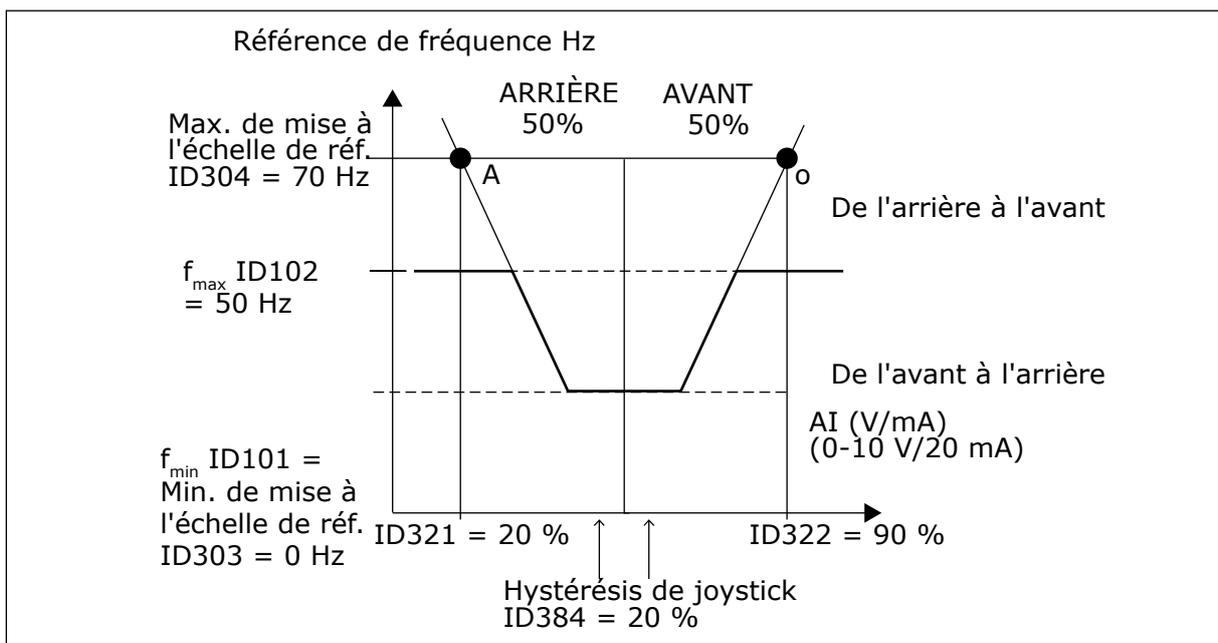
Fig. 60: Hystérésis de joystick avec fréquence minimale de 35 Hz
