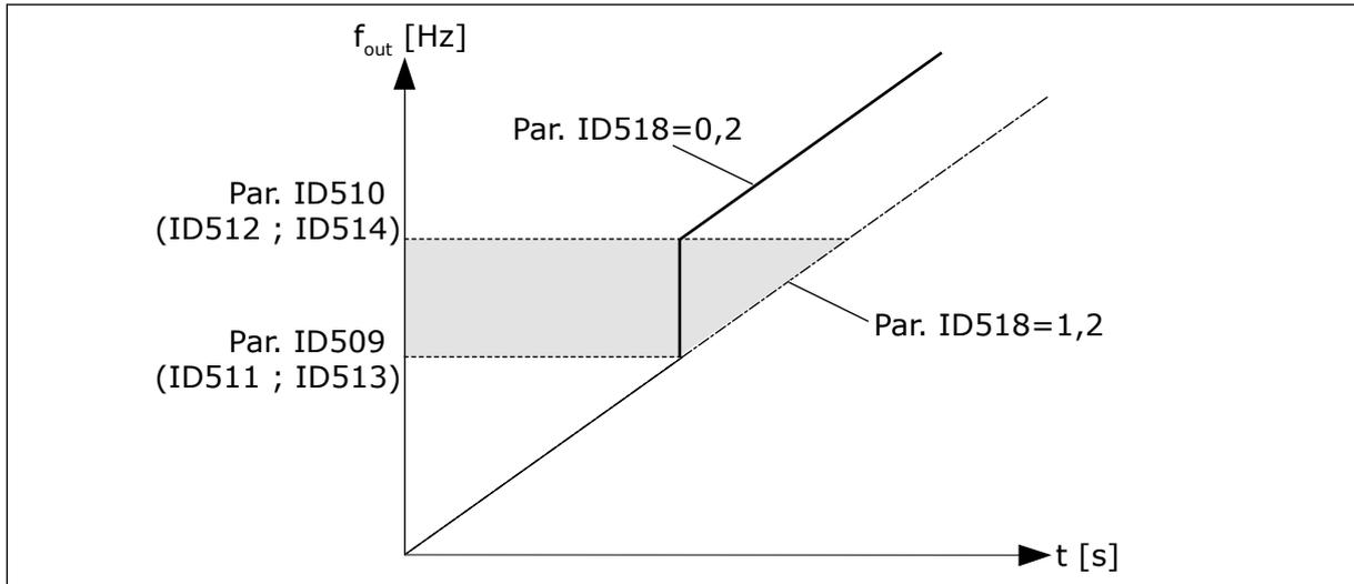
Fig. 71: Mise à l'échelle de la vitesse de rampe entre les fréquences interdites
