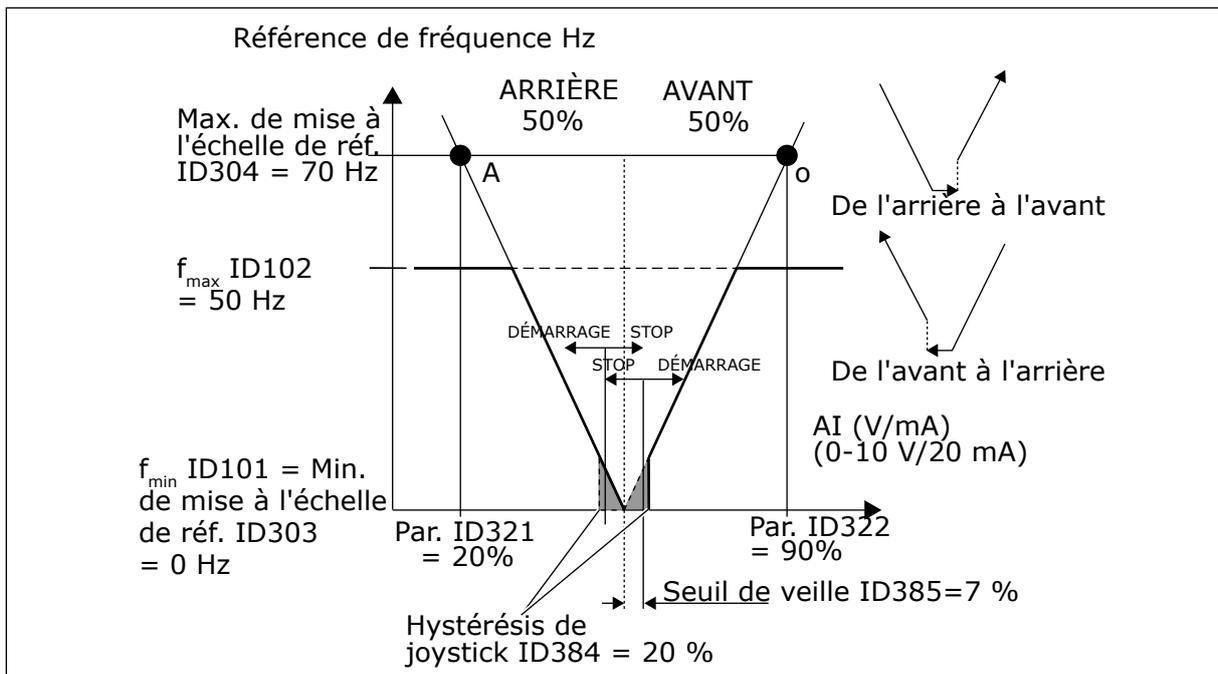
Fig. 59: Exemple de fonction de seuil de veille
