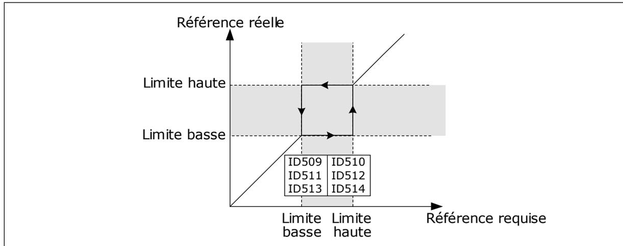
Fig. 70: Exemple de réglage de zone de fréquences interdites
