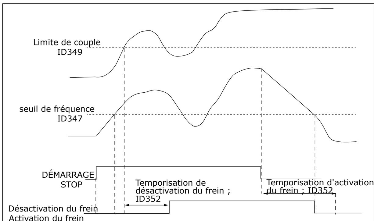
Fig. 92: Commande de freinage avec limites supplémentaires
