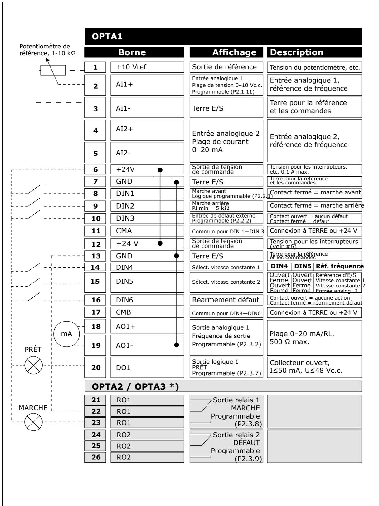
Fig. 4: Applicatif standard – Configuration des E/S par défaut
