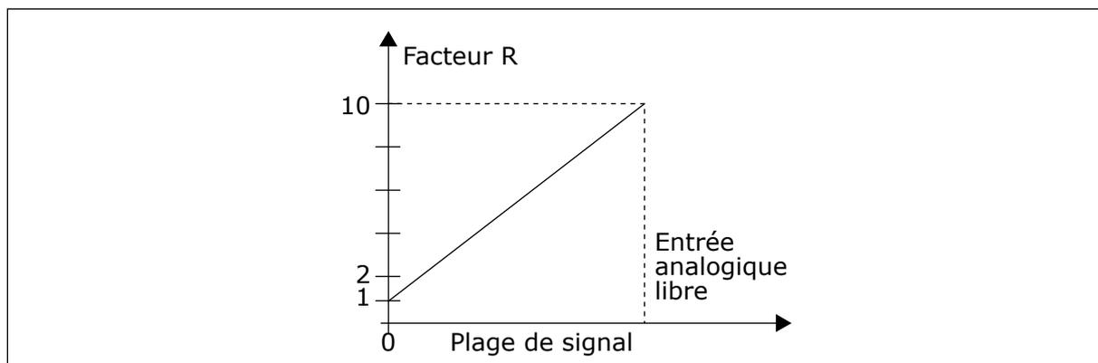
Fig. 52: Réduction des temps d'accélération et de décélération
