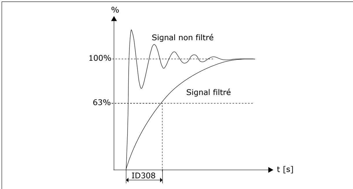
Fig. 37: Filtrage de la sortie analogique
