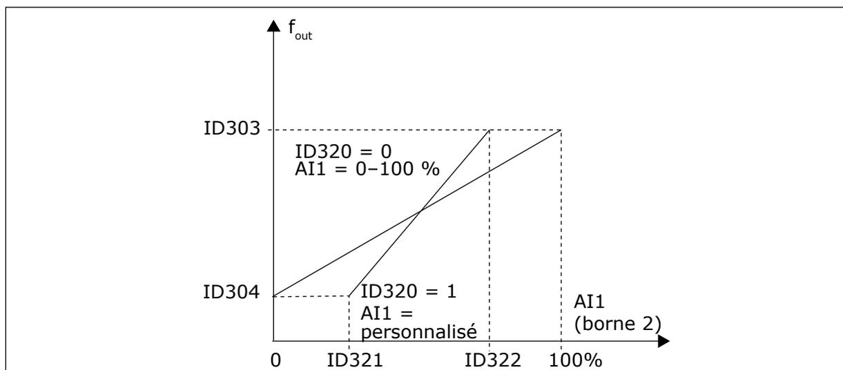
Fig. 42: AI1 : pas d'inversion du signal
