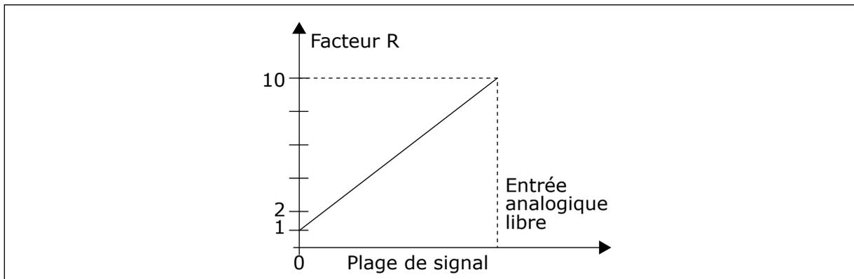
Fig. 62: Réduction des temps d'accélération et de décélération
