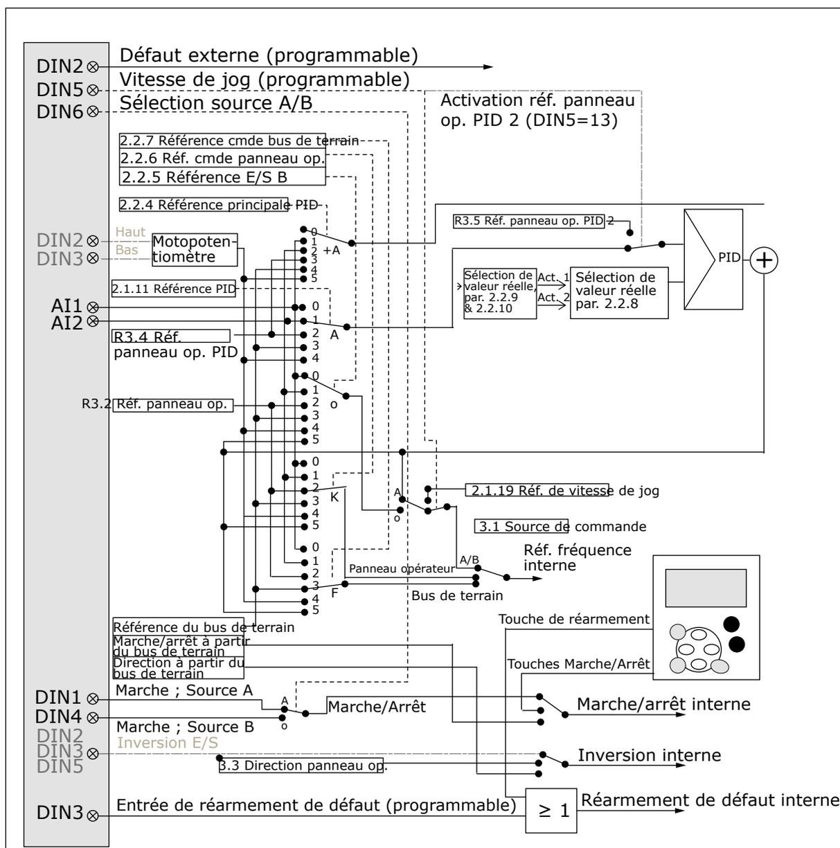
Fig. 15: Logique des signaux de commande de l'applcatif de régulation PID
