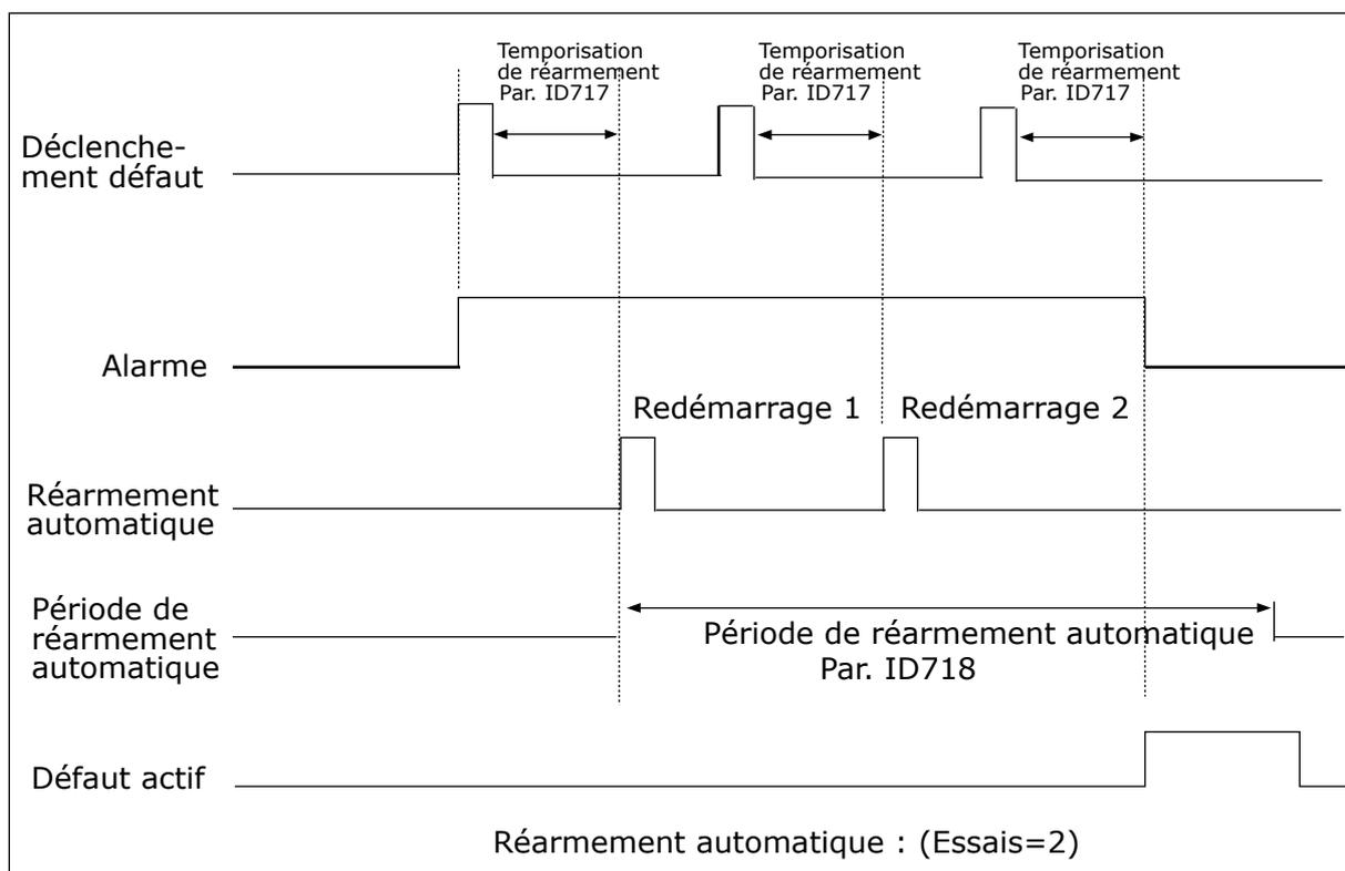
Fig. 78: Exemple de redémarrage automatique avec deux redémarrages
