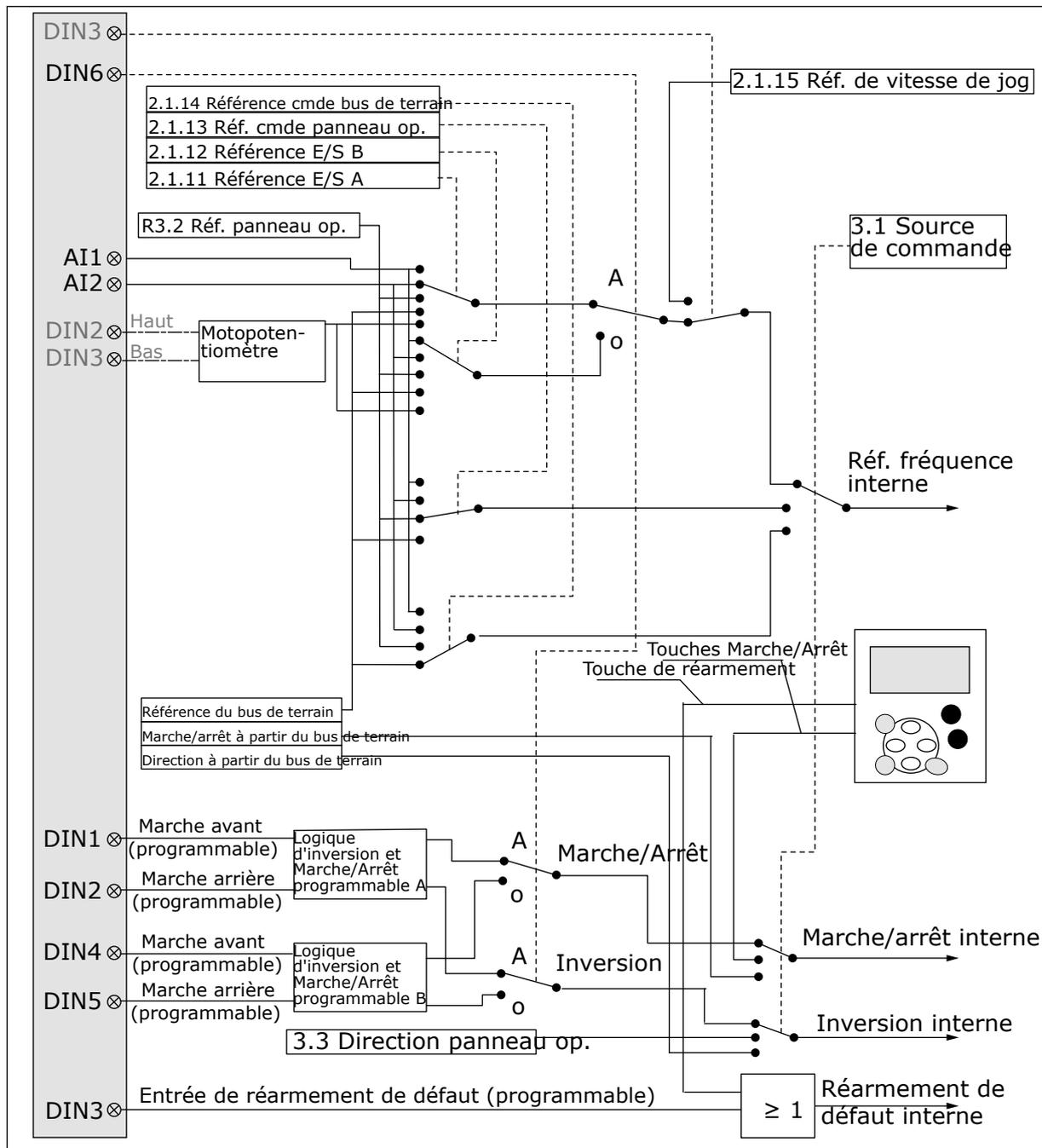
Fig. 9: Logique des signaux de commande de l'applcatif de commande local/distance
