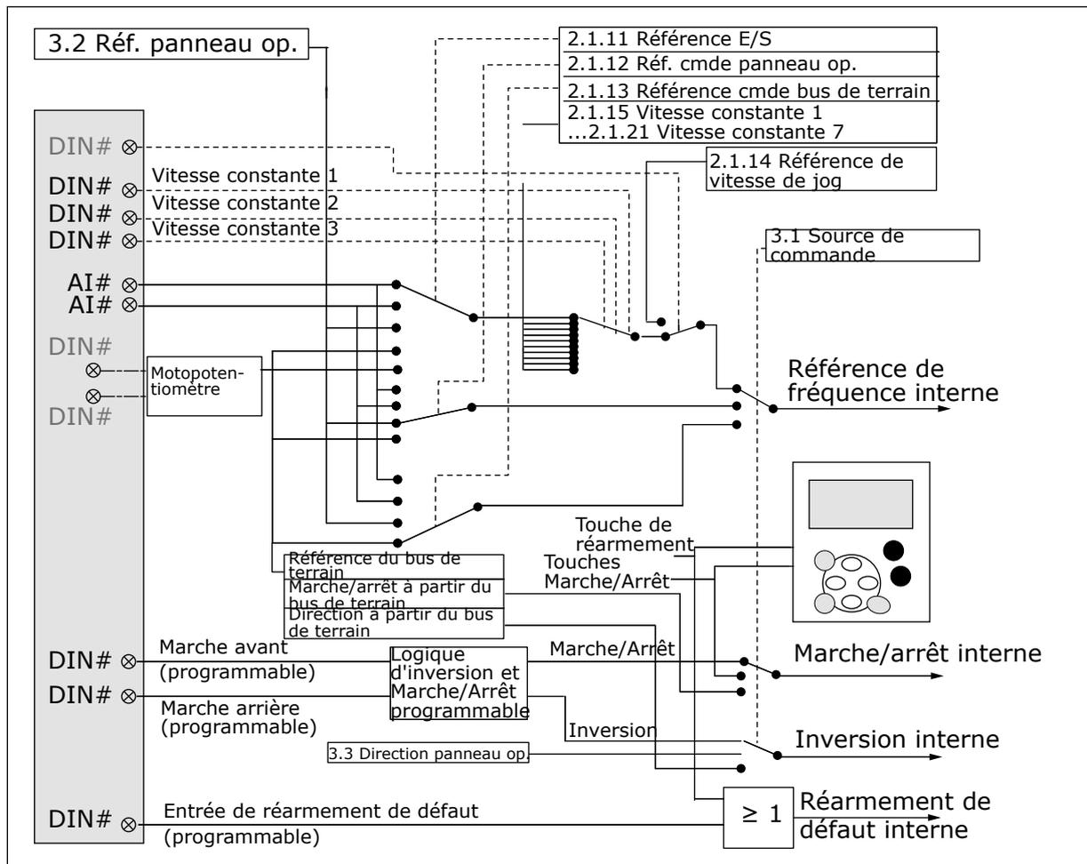
Fig. 18: Logique des signaux de commande de l'applicatif multi-configuration
