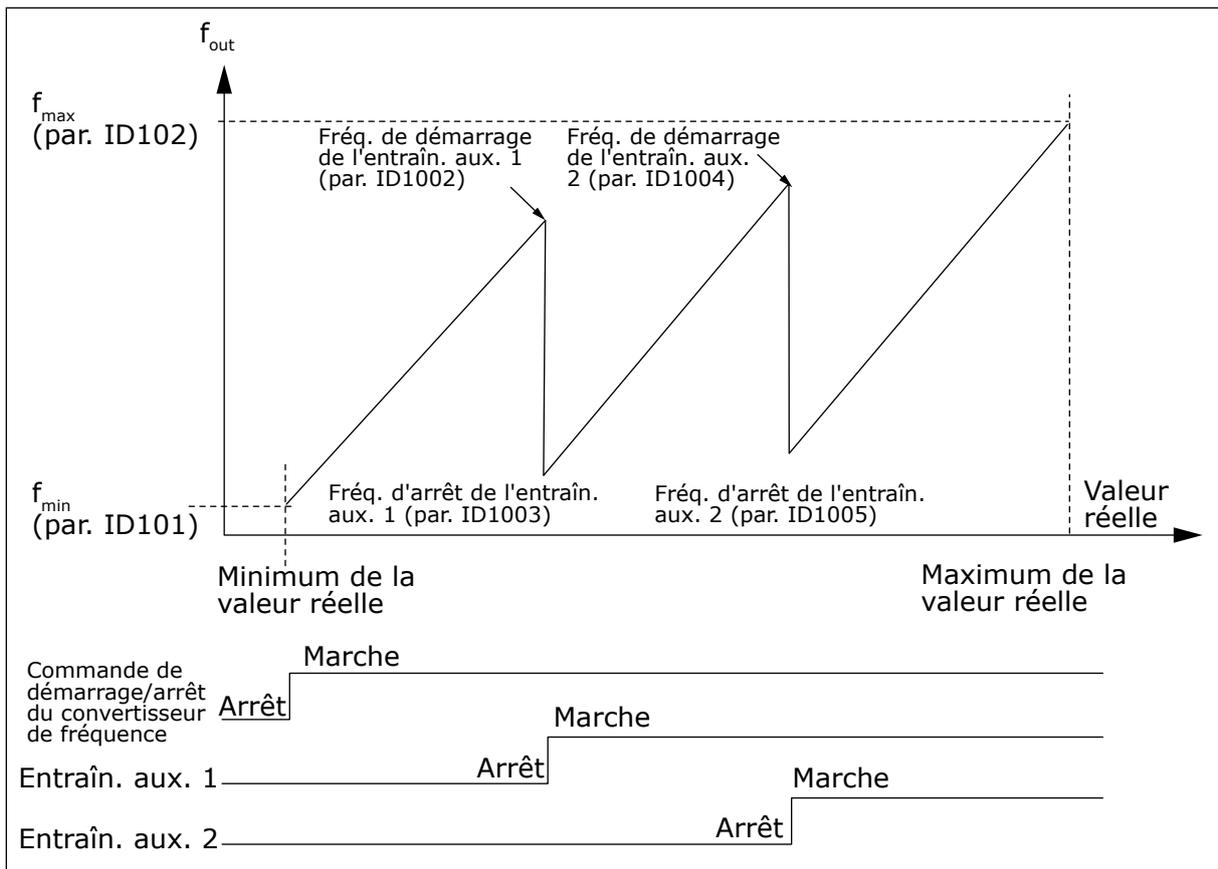
Fig. 82: Exemple d'un variateur de vitesse et de deux entraînements auxiliaires avec régulateur PID ignoré
