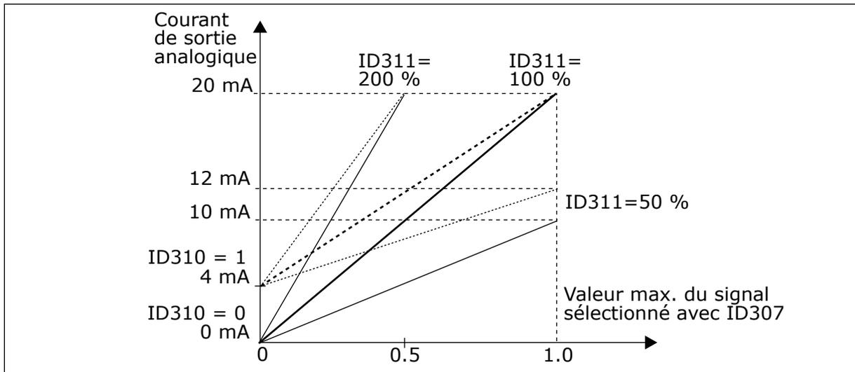
Fig. 39: Échelonnement sortie analogique
