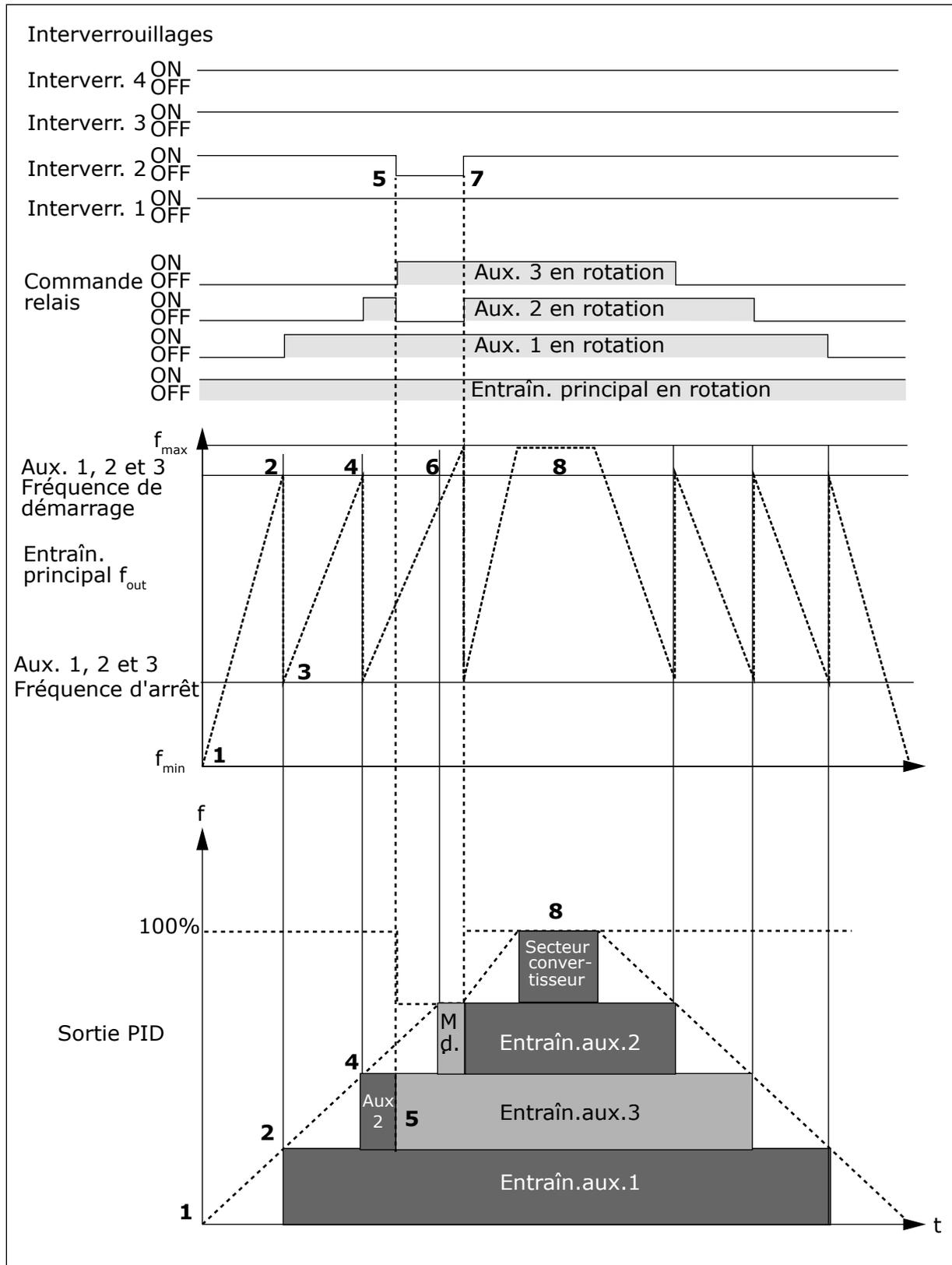
Fig. 97: Exemple de la fonction avec l'appliquatif de commande pour pompes et ventilateurs avec trois entraînements aux.
