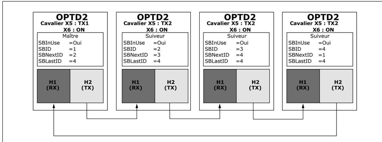
Fig. 91: Connexions physiques du bus système avec la carte OPTD2
