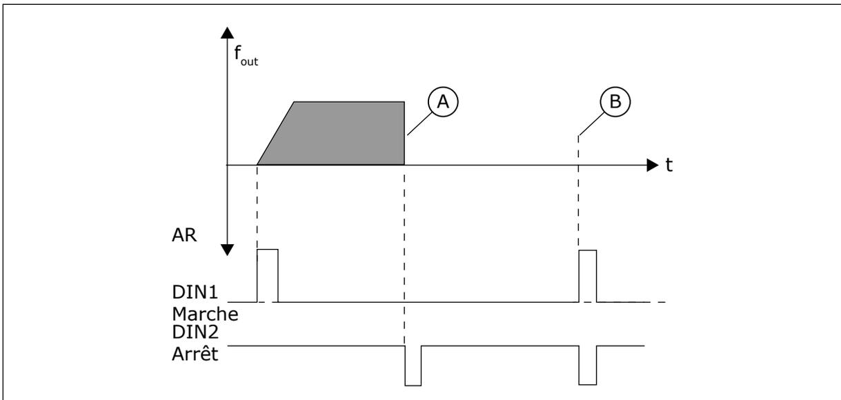
Fig. 32: Impulsion de marche / Impulsion d'arrêt
