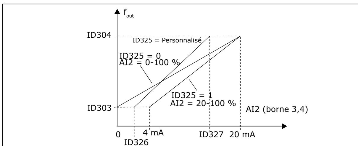
Fig. 45: Mise à l'échelle de l'entrée analogique AI2
