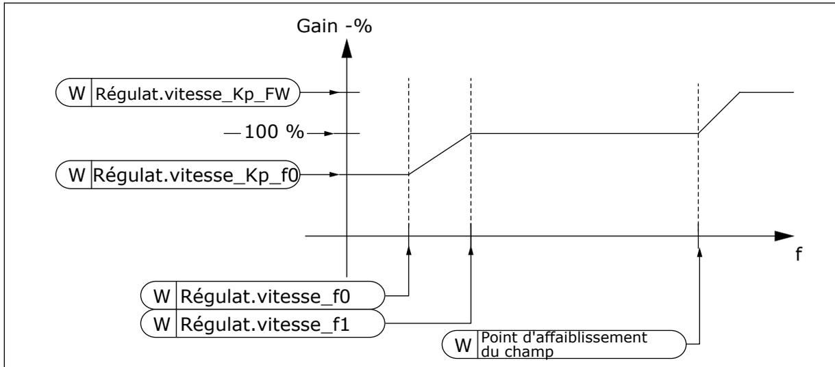
Fig. 96: Gain adaptatif du régulateur de vitesse
