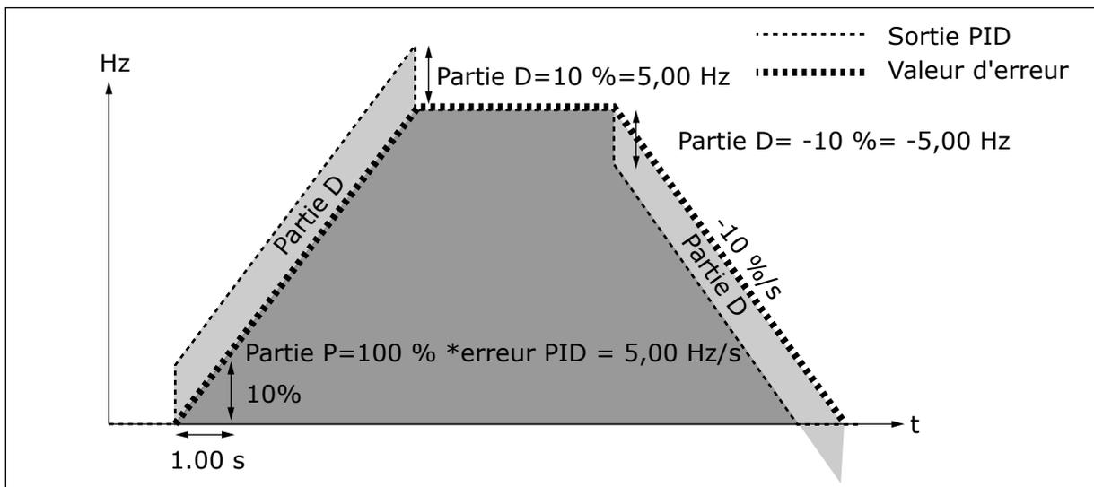
Fig. 29: Sortie PID avec les valeurs de l'exemple 3
