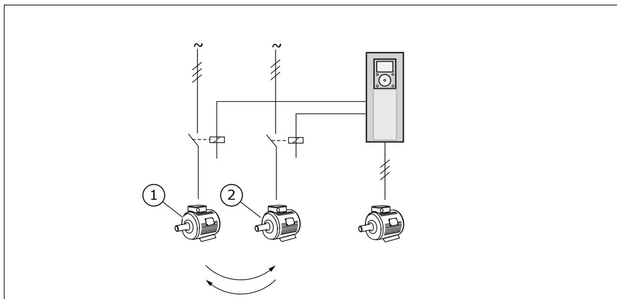
Fig. 86: Permutation appliquée aux entraînements auxiliaires uniquement
