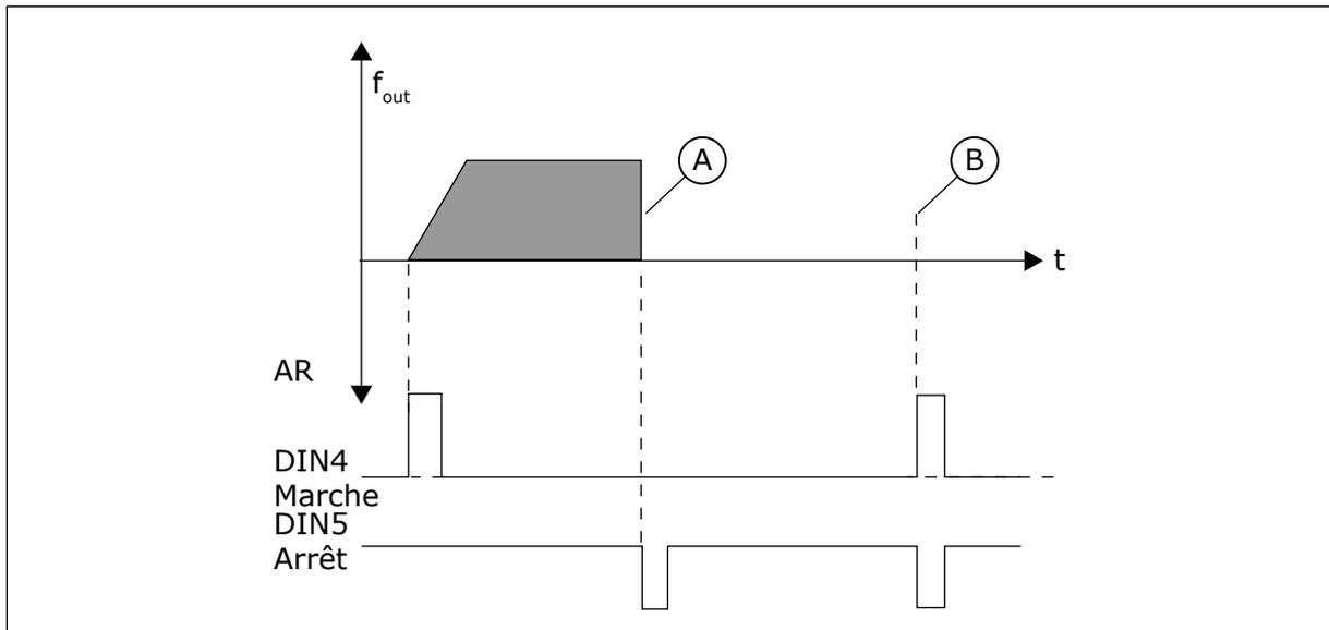
Fig. 56: Impulsion de marche / Impulsion d'arrêt
