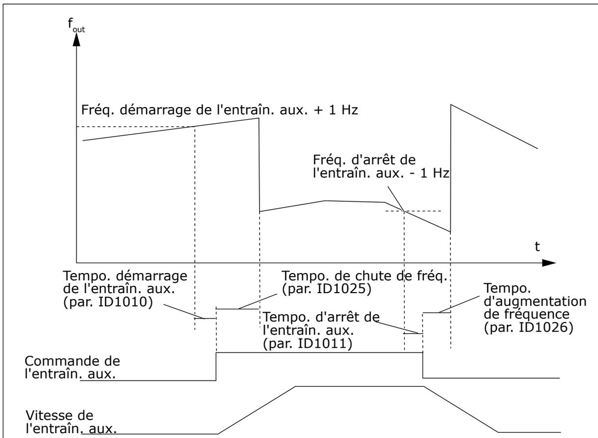
Fig. 85: Temporisations de chute et d'augmentation de fréquence
