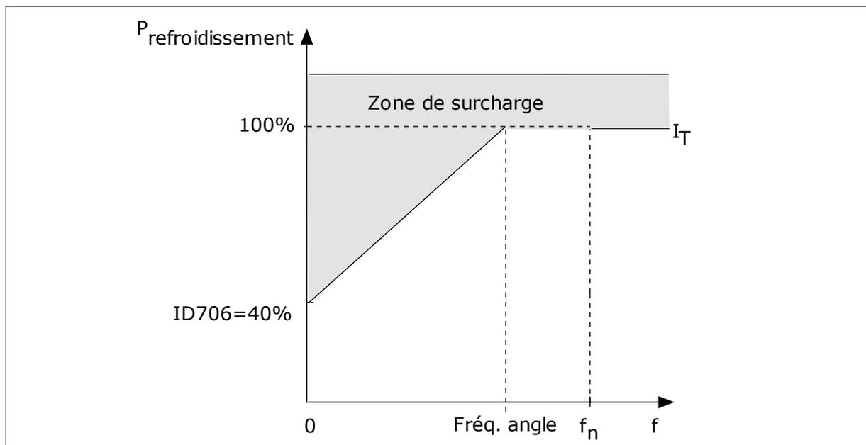
Fig. 72: *Courbe de courant thermique  $I_T$  du moteur*
