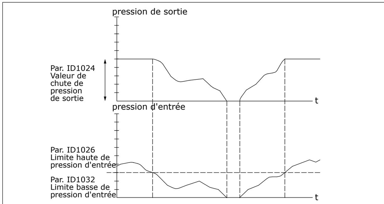
Fig. 84: Comportement de la pression de sortie en fonction de la pression d'entrée et des réglages de paramètre
