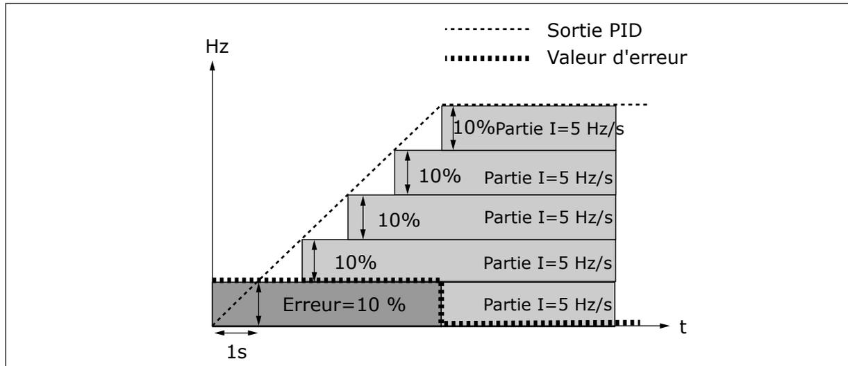
Fig. 27: Le régulateur PID fonctionne comme régulateur I
