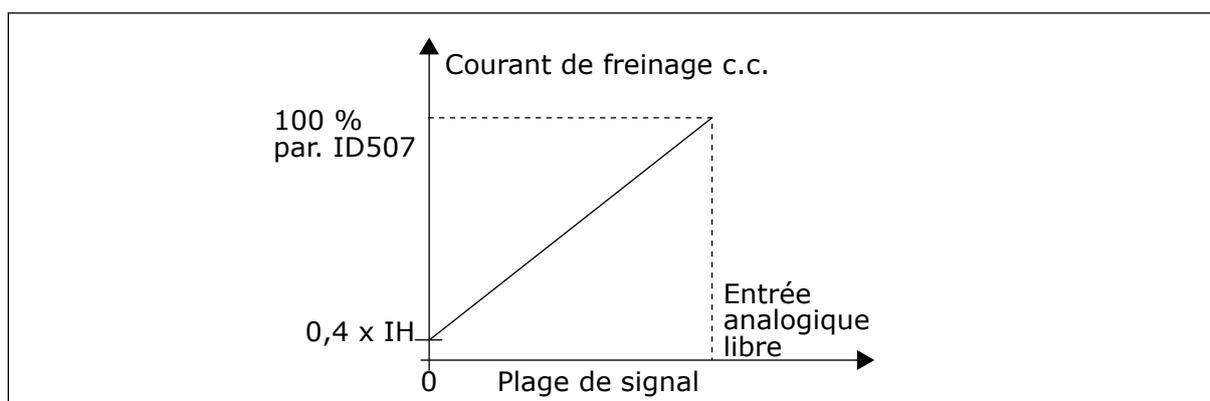
*Fig. 51: Réduction du courant de freinage c.c.*
