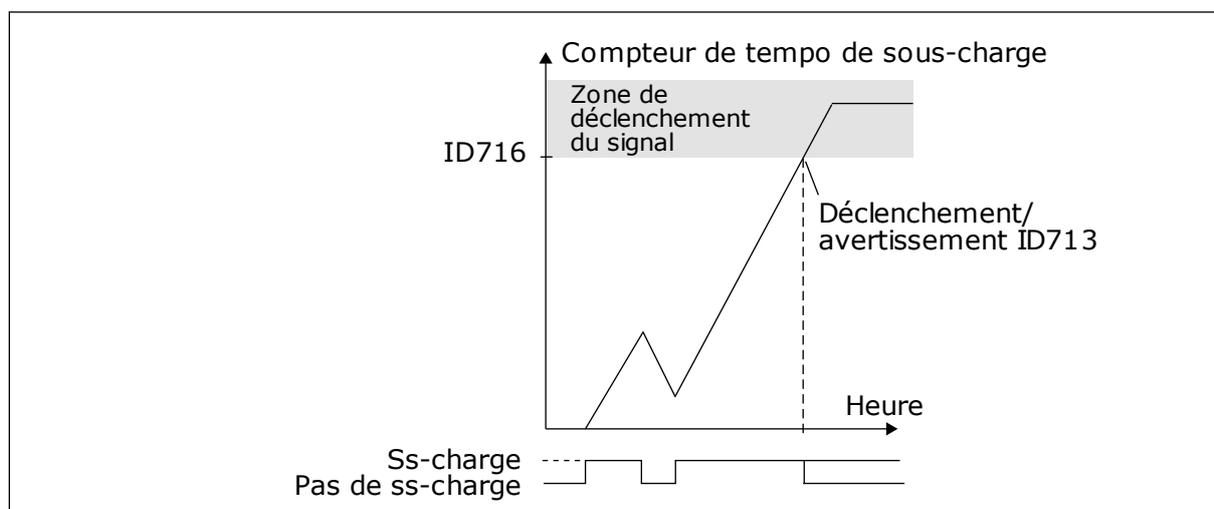
Fig. 77: Fonction de compteur de temporisation de sous-charge
