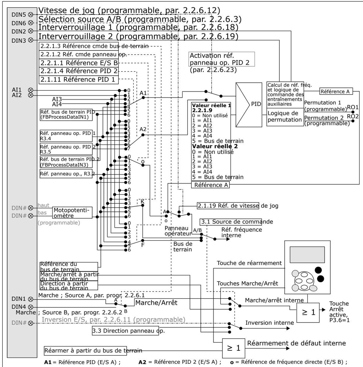
Fig. 23: Logique des signaux de commande de l'applcatif de commande pour pompes et ventilateurs
