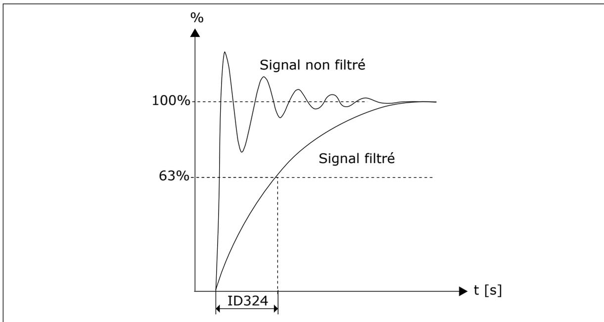
Fig. 44: Filtrage du signal AI1
