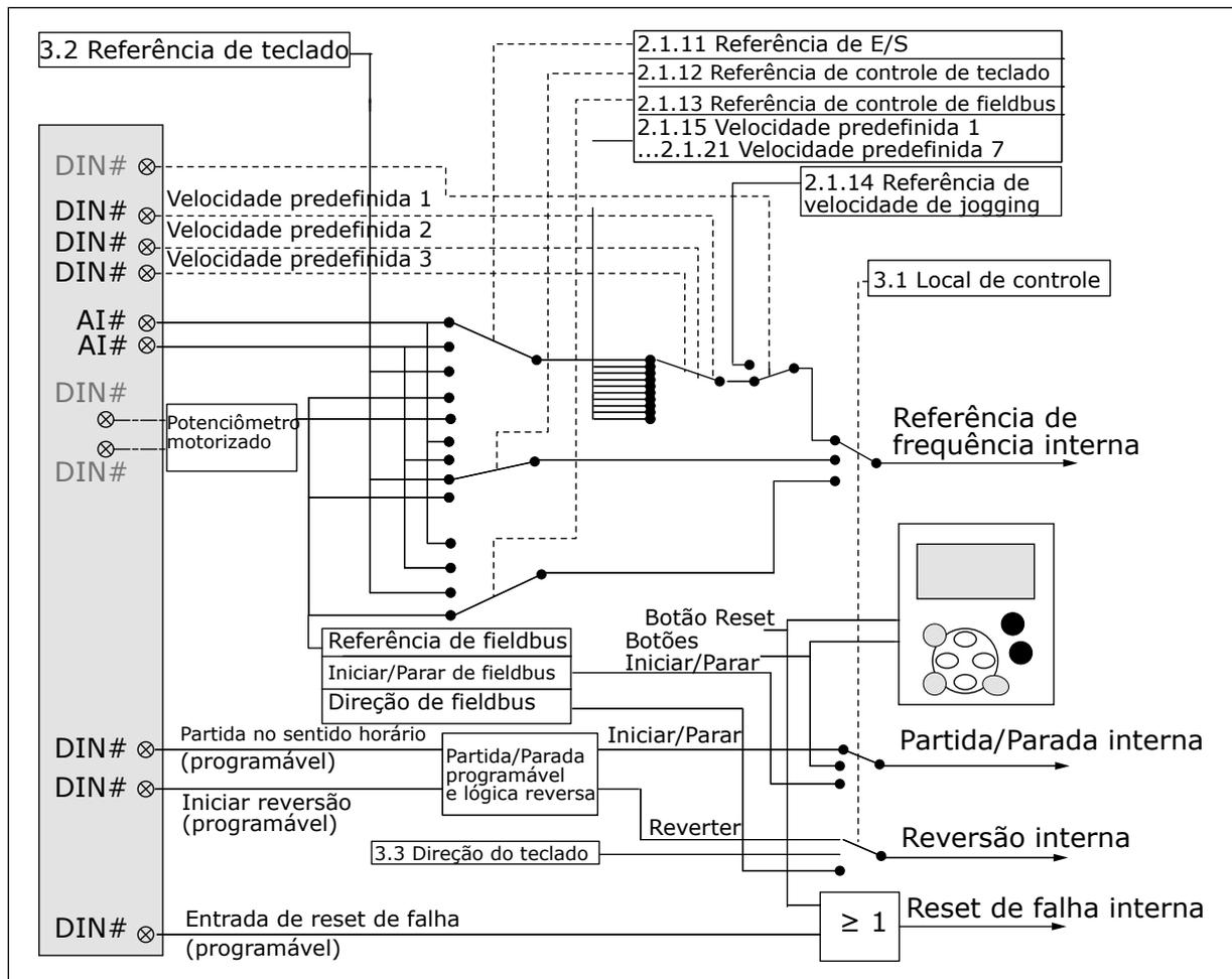
Fig. 18: Lógica do sinal de controle do Aplicativo de controle multifinalidade
