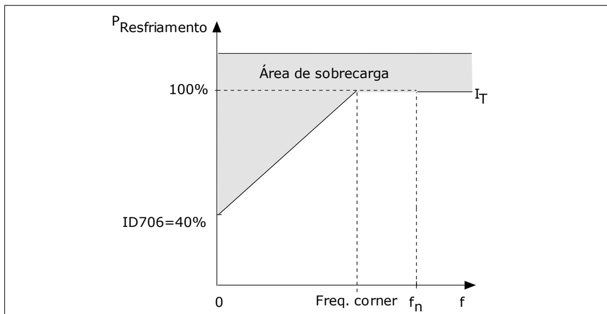
Fig. 72: Curva  $I_T$  da corrente térmica do motor
