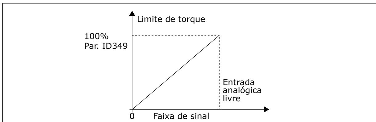
Fig. 53: Redução do limite de supervisão de torque
