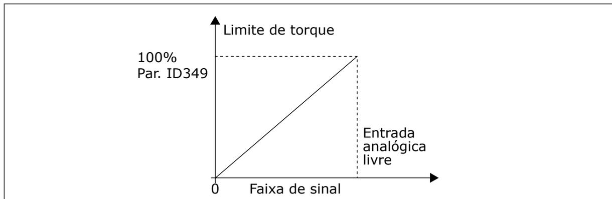
Fig. 64: Escala do limite de torque do motor
