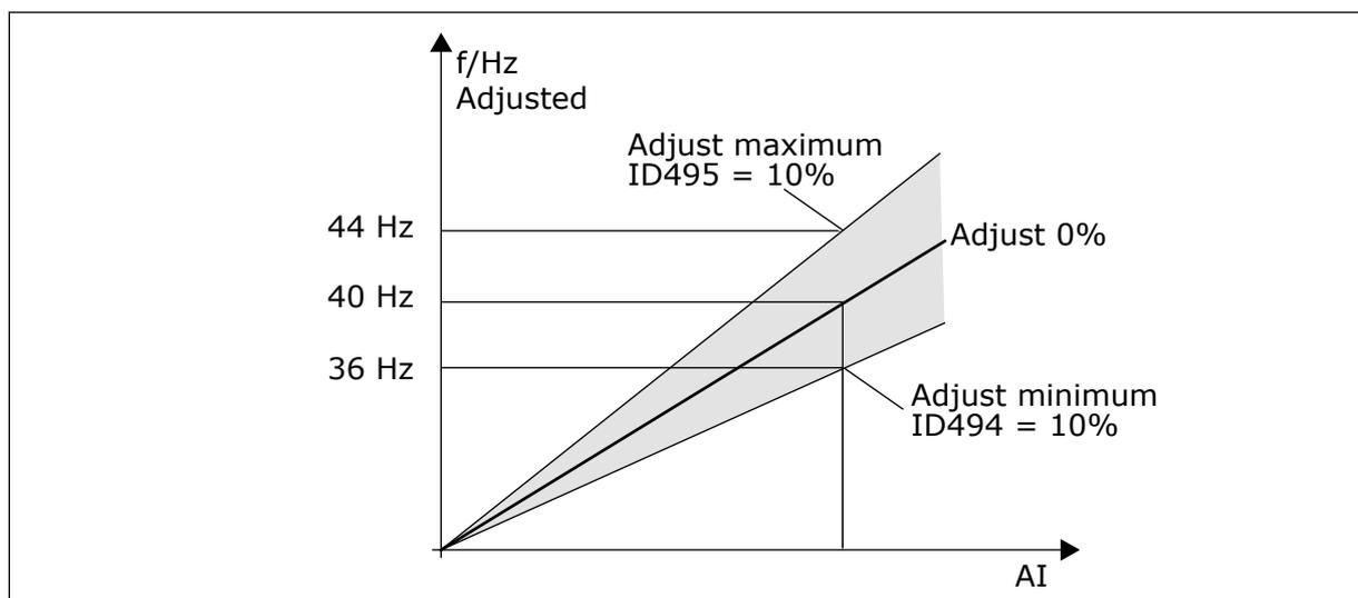
Fig. 66: Um exemplo de entrada de ajuste
