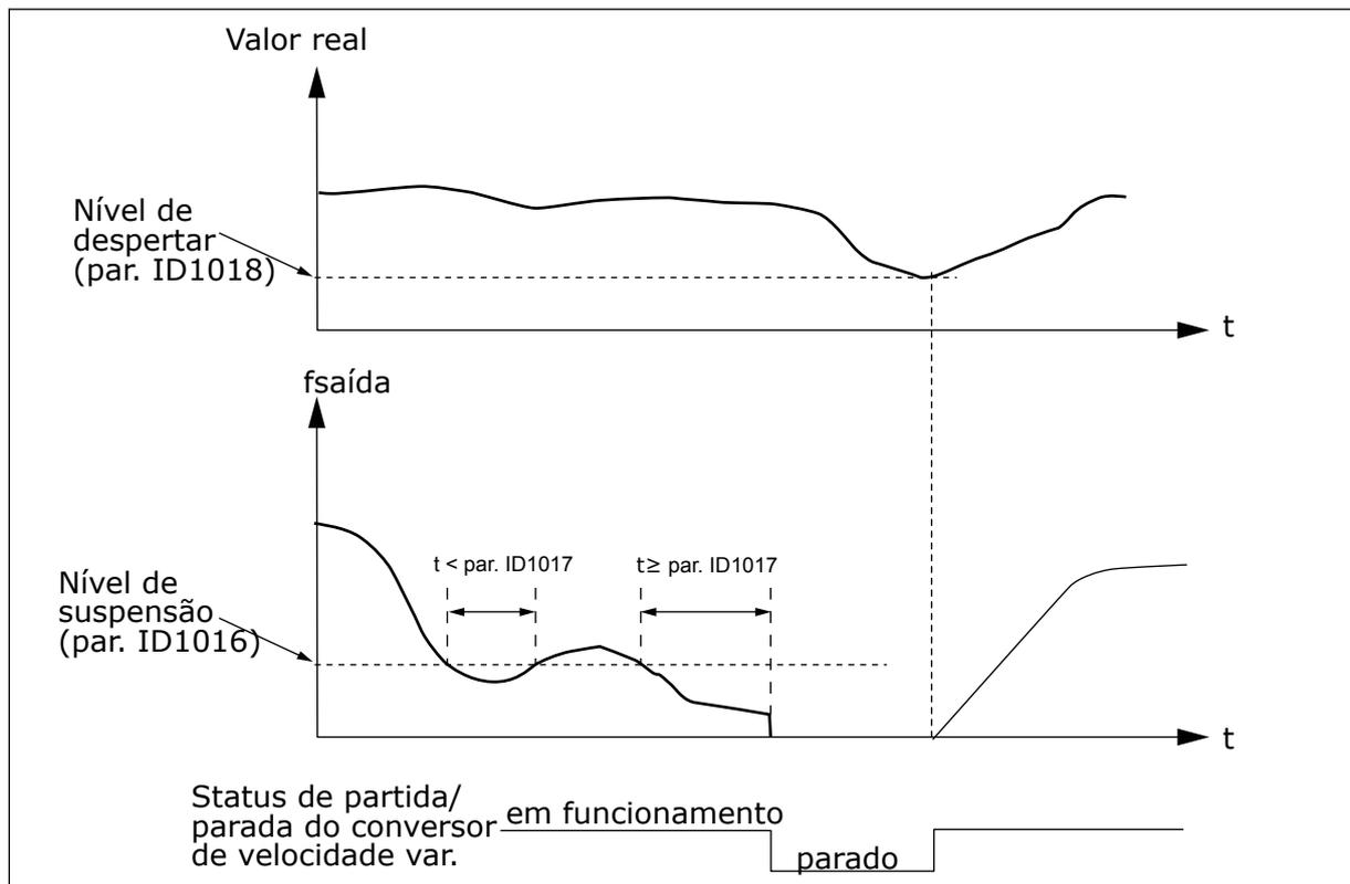
Fig. 81: Função de suspensão do conversor de frequência
