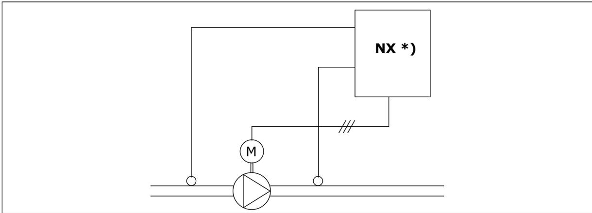
Fig. 83: Medição de pressão de entrada e saída
