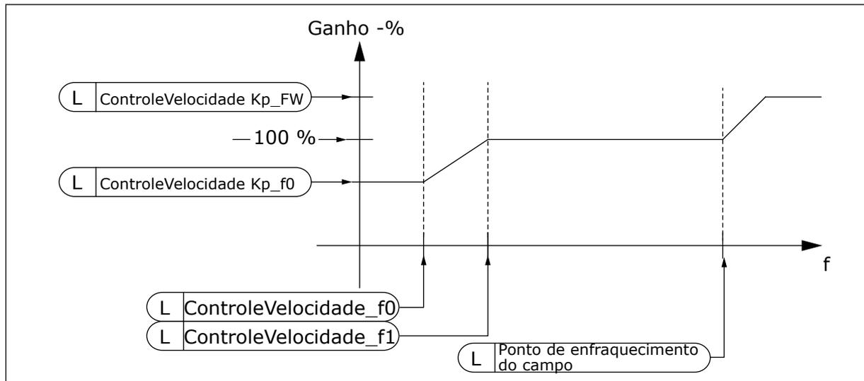
Fig. 96: Ganho adaptativo do controlador de velocidade
