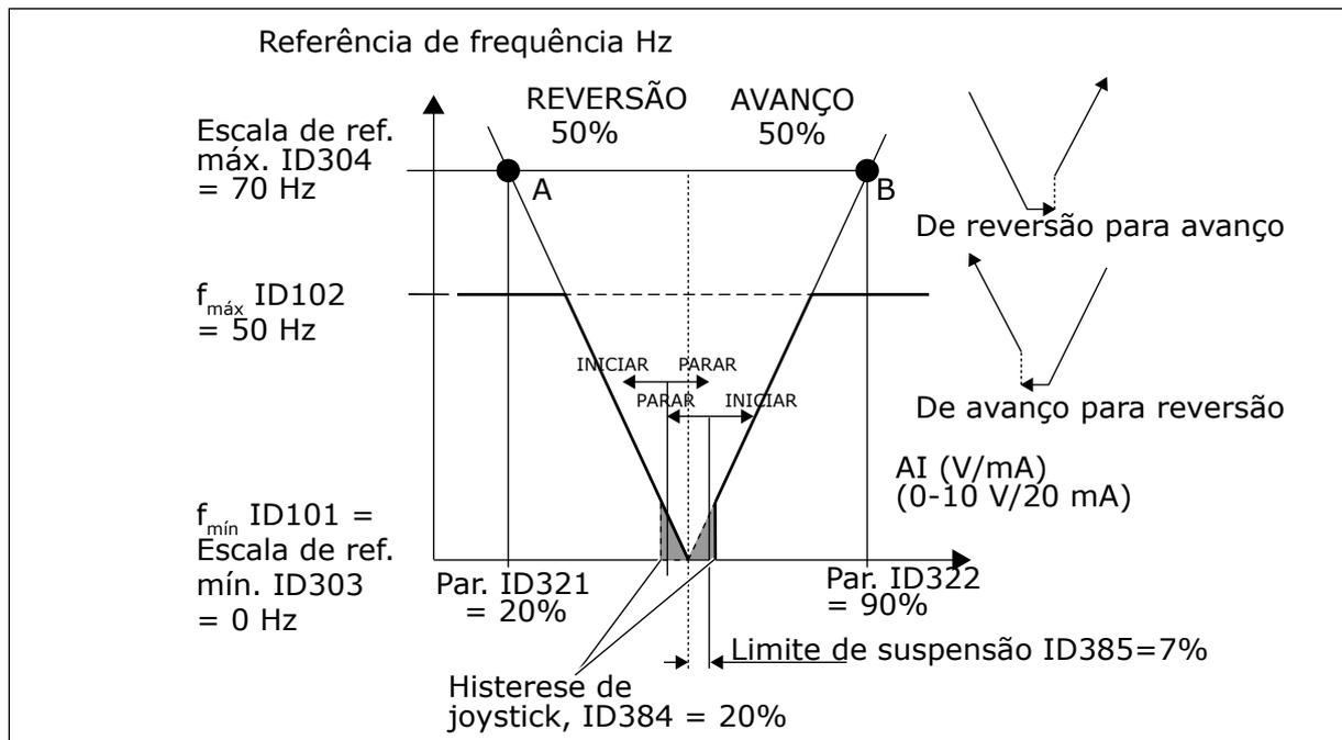
Fig. 59: Exemplo da função de limite de suspensão
