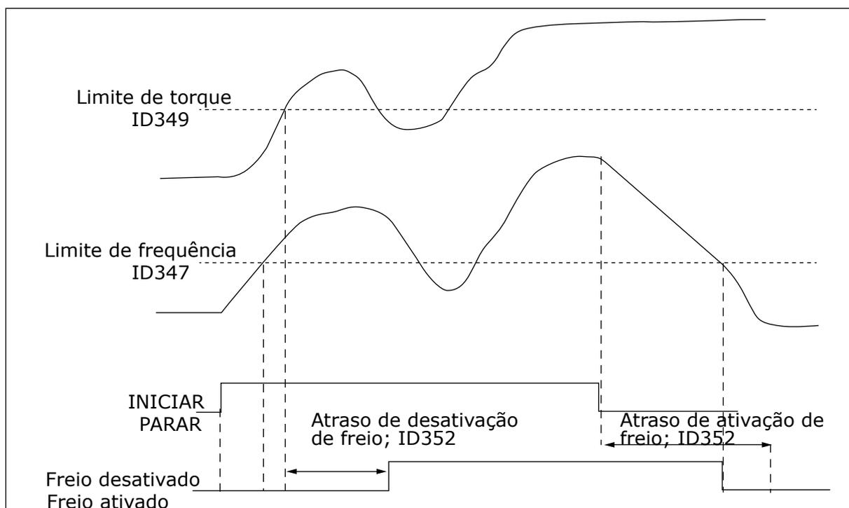
Fig. 92: Controle de freio com limites adicionais
