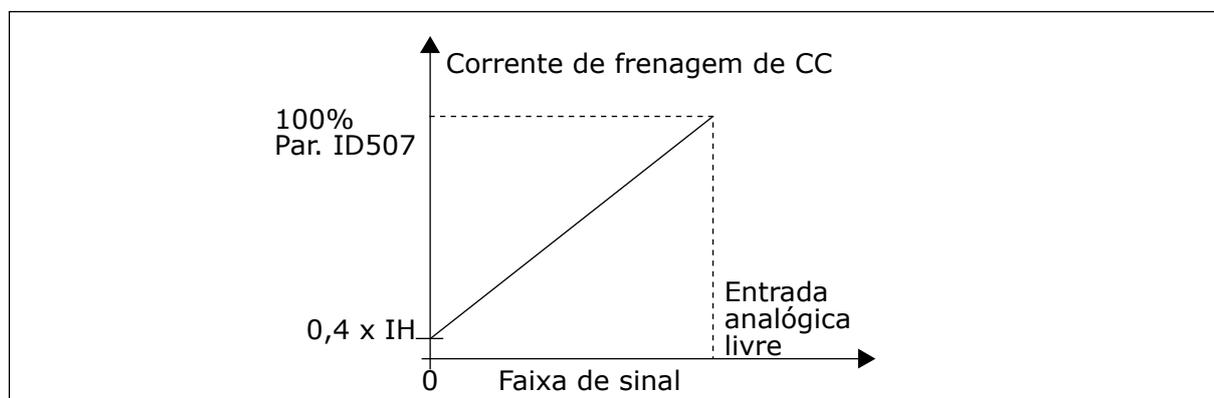
Fig. 61: Escala da corrente de frenagem de CC
