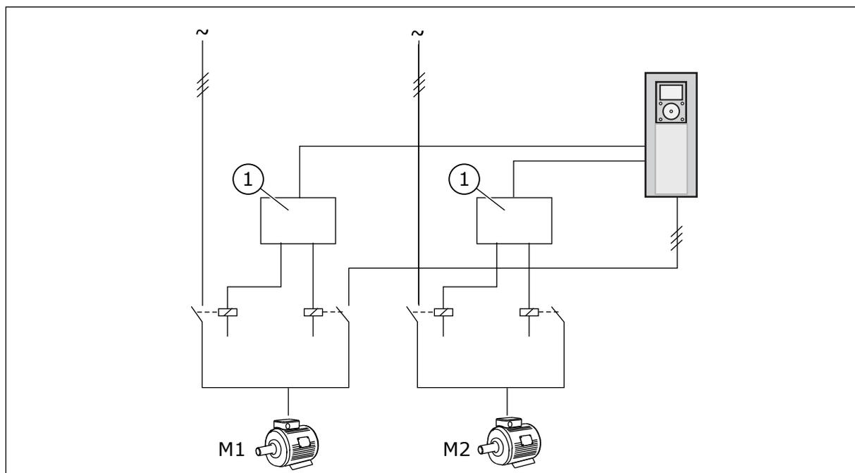
Fig. 87: Troca automática com todos os conversores
