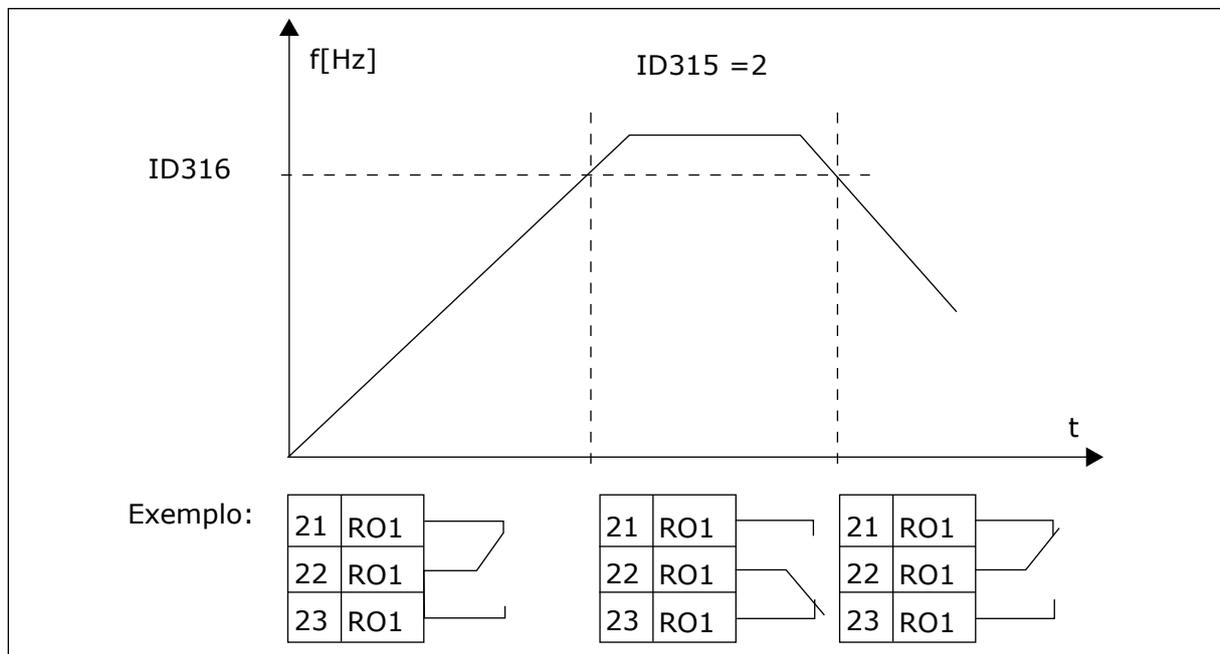
Fig. 40: Supervisão de frequência de saída
