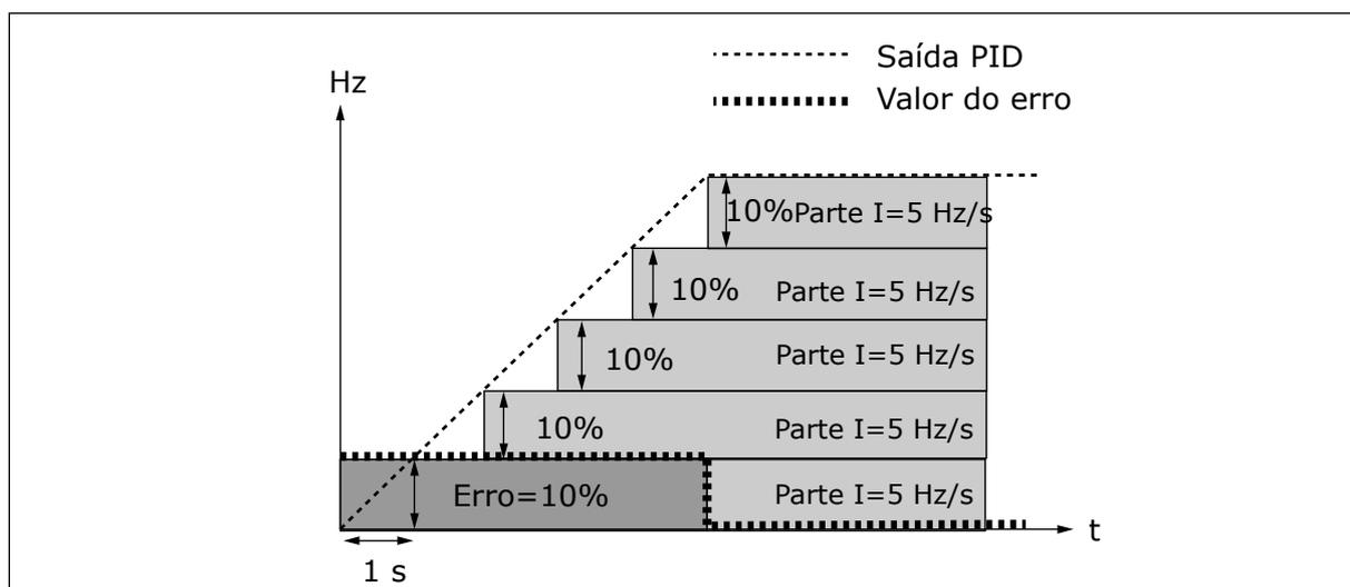
Fig. 27: Função do controlador PID como controlador I
