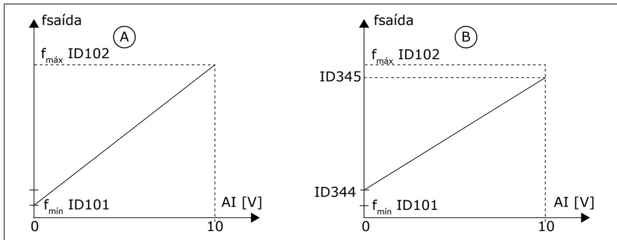
Fig. 47: Valor máximo da escala de referência
