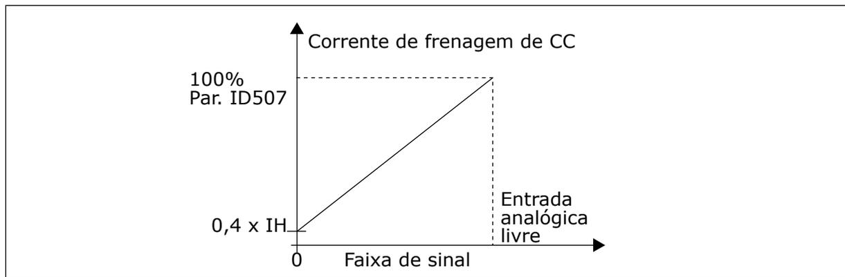
Fig. 51: Redução da corrente de frenagem de CC
