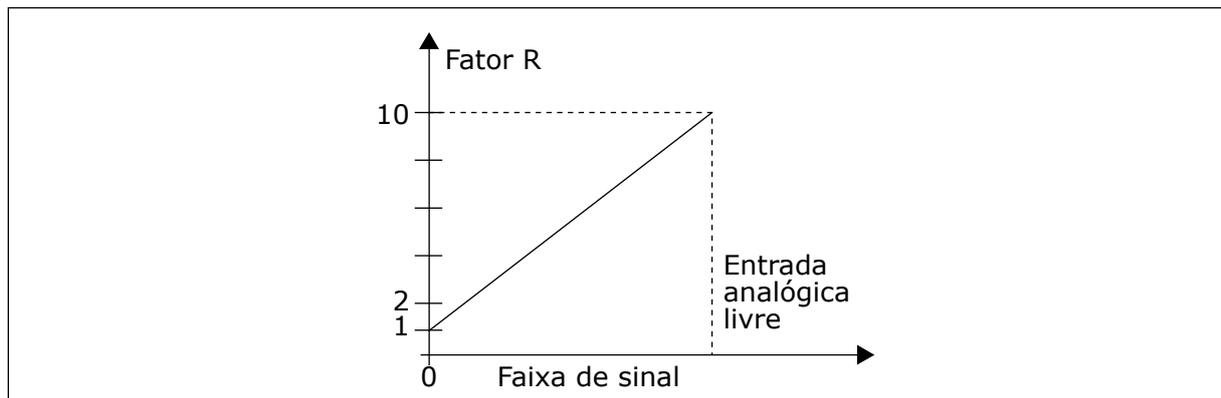
Fig. 52: Redução dos tempos de aceleração e desaceleração
