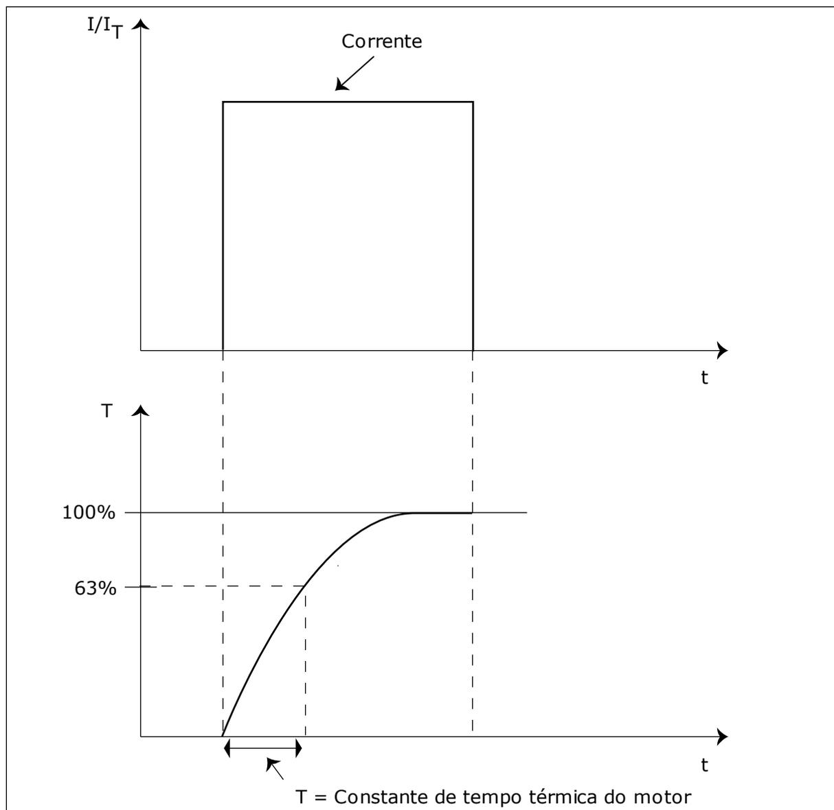
Fig. 73: A constante de tempo térmica do motor
