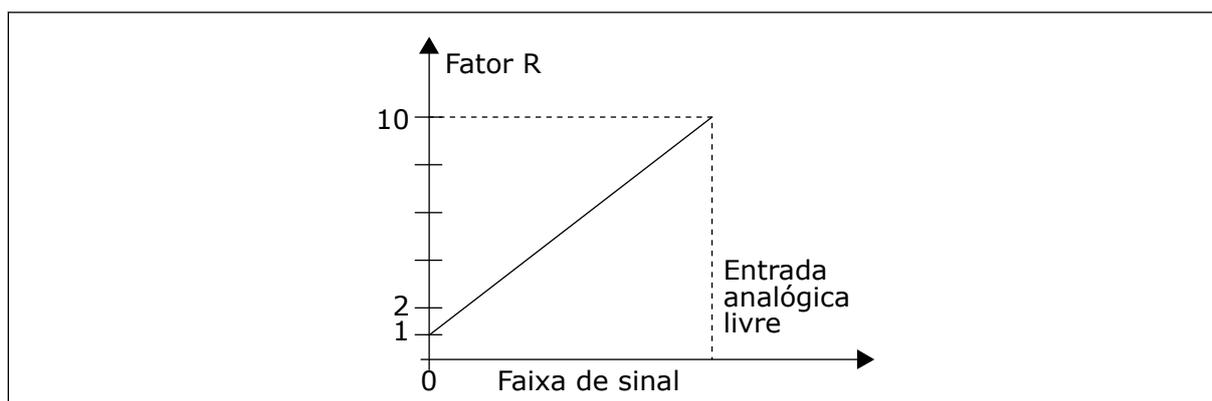
Fig. 62: Redução dos tempos de aceleração e desaceleração
