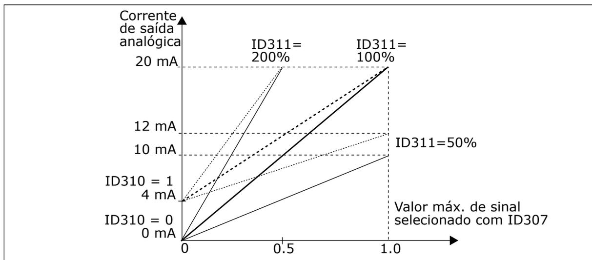
Fig. 39: Escala de saída analógica
