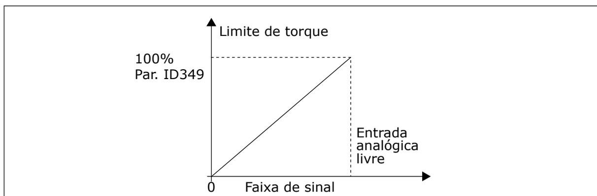
Fig. 63: Reduzindo limite de supervisão de torque
