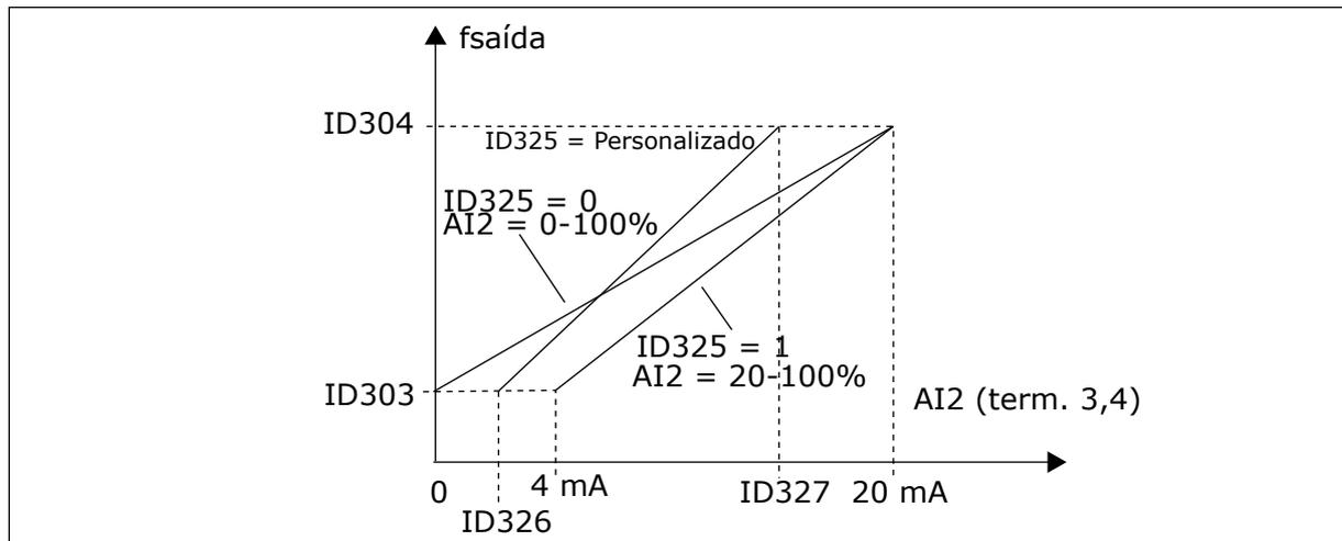
Fig. 45: Escala de entrada analógica AI2
