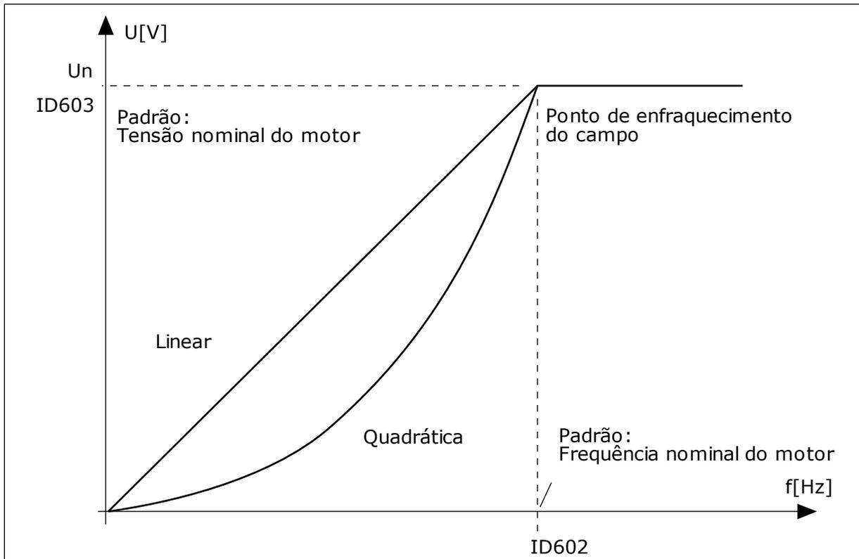
Fig. 24: Variação linear e quadrática da tensão do motor
