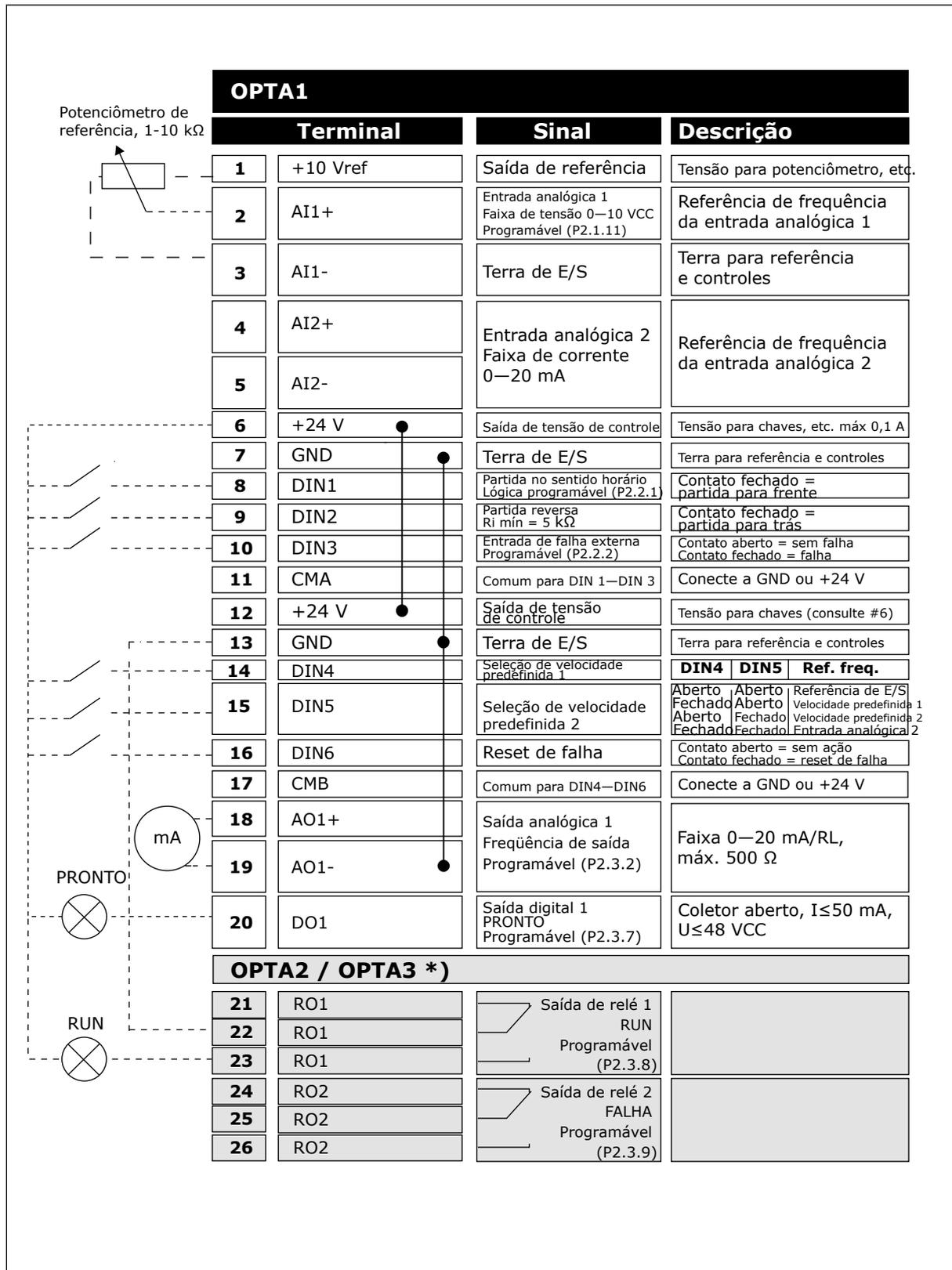
Fig. 4: Configuração de E/S padrão do Aplicativo padrão
