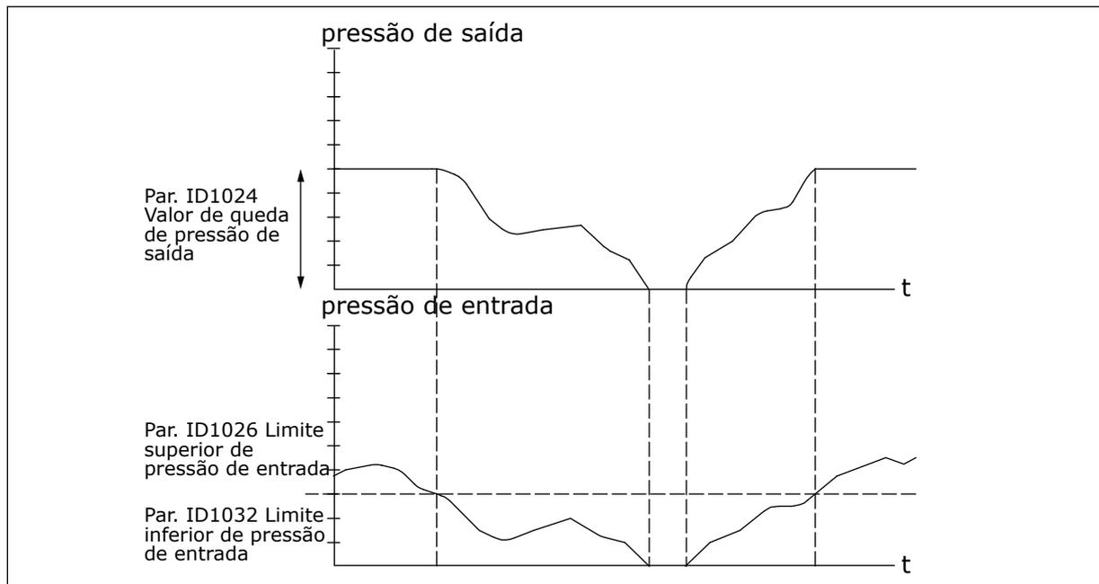
Fig. 84: Comportamento da pressão de saída dependendo das configurações de parâmetros e pressão de entrada
