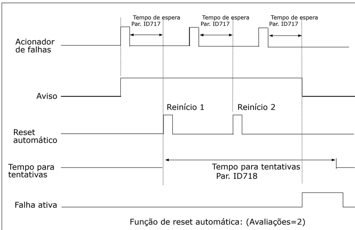
Fig. 78: Exemplo de reinício automático com dois reinícios
