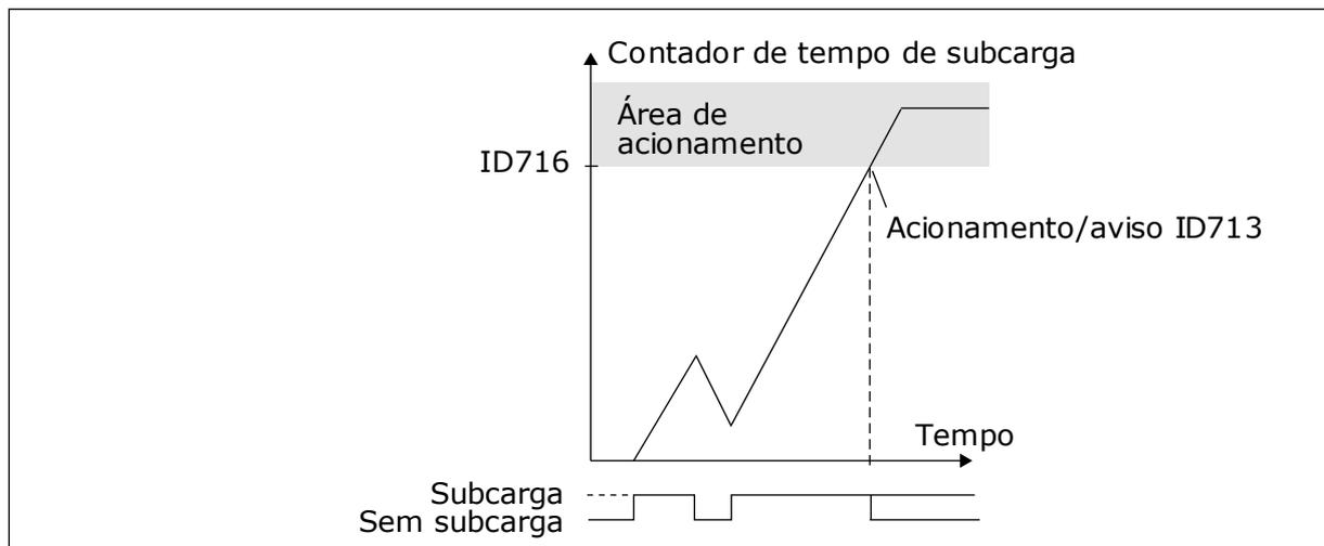
*Fig. 77: A função Contador de tempo de subcarga*
