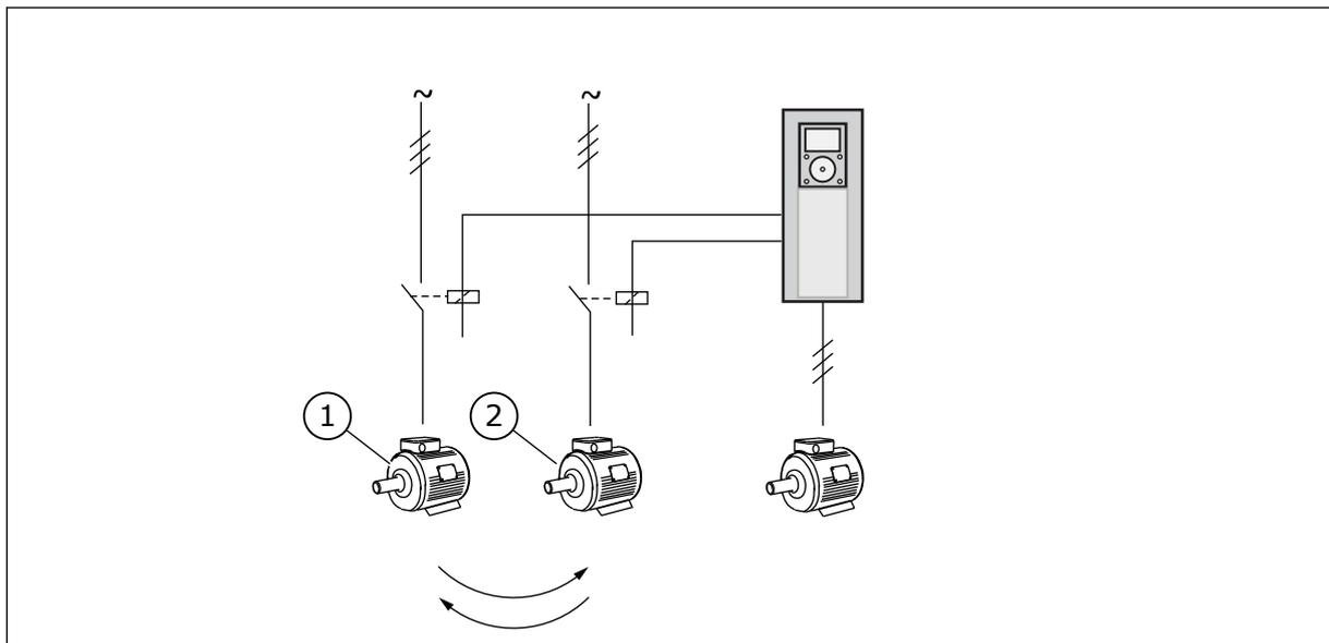
**Fig. 86: Troca automática aplicada somente a conversores auxiliares**
