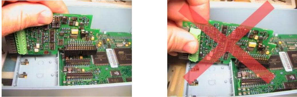
确保选件卡与金属夹具和塑料槽紧紧固定（见下图）。如果选件卡难以固定在插槽内，请确认选件卡所允许安装的插槽。
